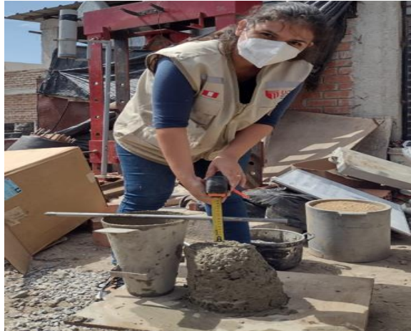
Figura 12. Asentamiento del concreto fresco - NTP 339.035.
