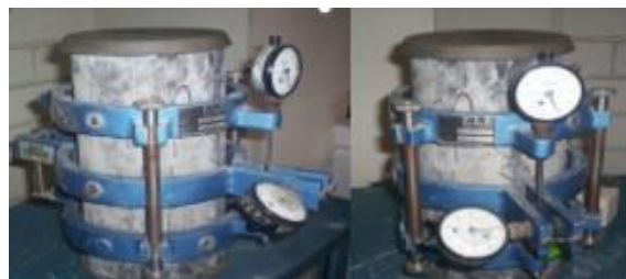
Figura 4. Ensayo de módulo de Elasticidad
