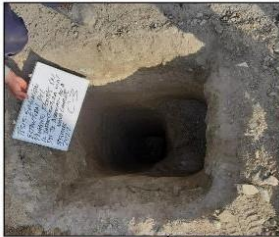
FOTO 05: SE OBSERVA LA EXCAVACIÓN CALICATA C-03.
