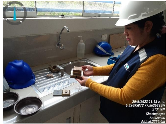
Foto 25: Ensayo de corte directo calicata N° 02.
