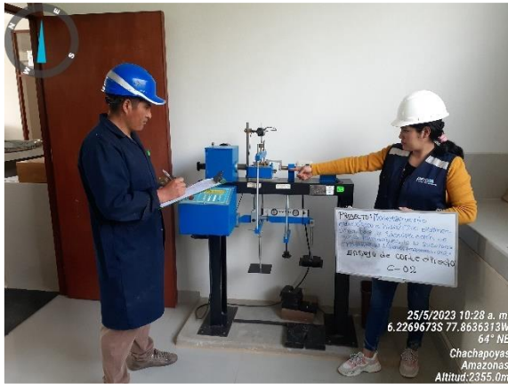
Foto 25: Ensayo de corte directo calicata N° 02.
