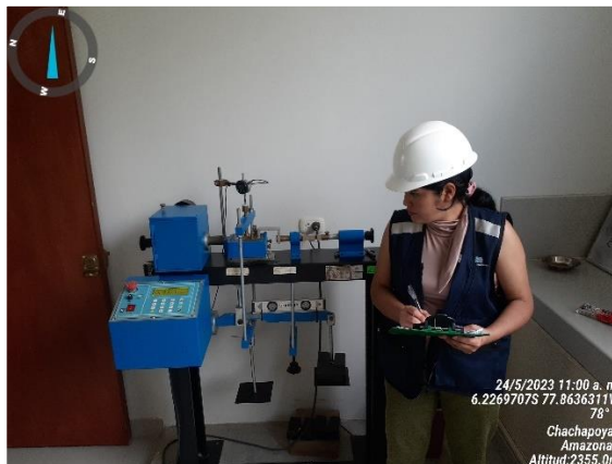
Foto 24: Ensayo de corte directo calicata N° 01.
