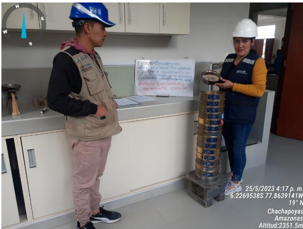
Foto 29: Ensayo granulométrico por tamizado del material granular
