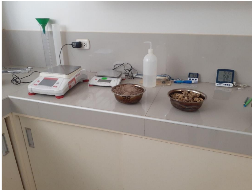
Foto 11: Extracción de contenido de humedad de calicatas quebrada Cristalina.
