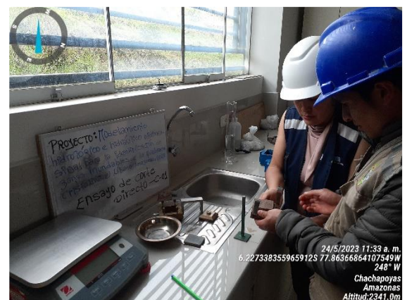
Foto 24: Ensayo de corte directo calicata N° 01.
