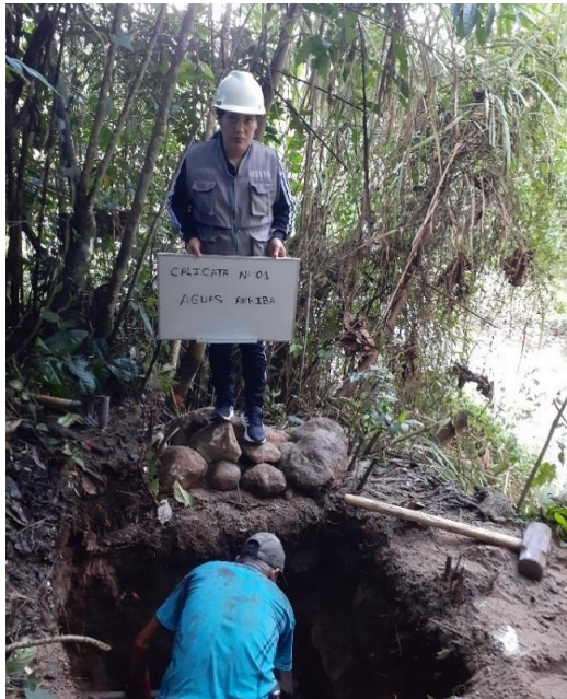
Foto 4: Vista de extracción de material calicata N° 01 aguas arriba de la quebrada Cristalina
