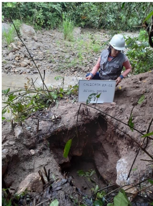
Foto 5: Vista de extracción de material calicata N° 01 aguas arriba de la quebrada Cristalina
