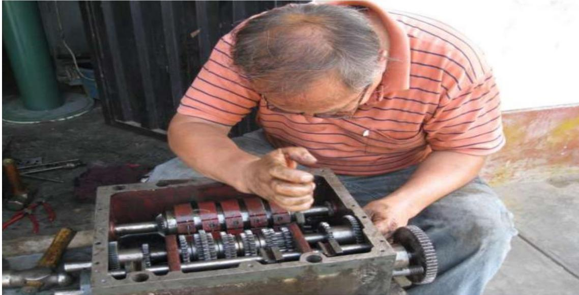
*Figura 39* Reparación del torno Búlgaro
