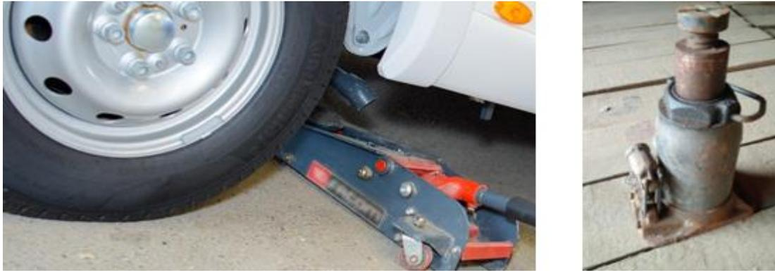
*Figura 19* Uso inadecuado del gato hidráulico
