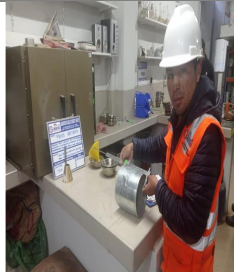
Imagen N°05- se observa los ensayo de peso unitario
