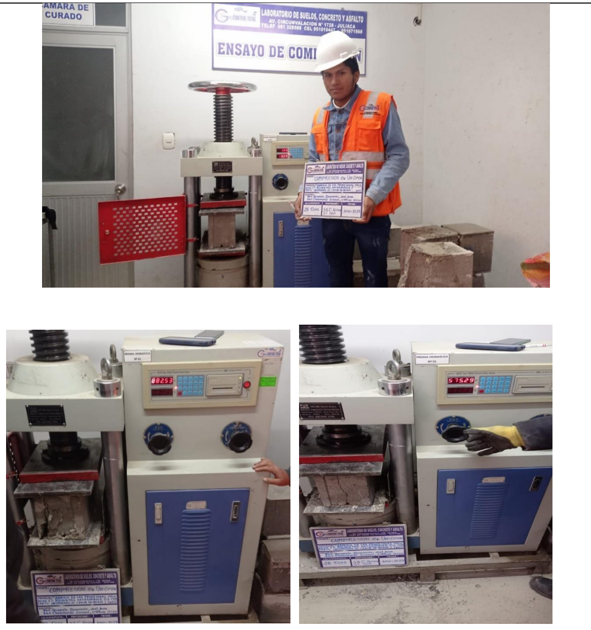
Imagen N° 12- se observa el ensayo de compresión de unidades de albañilería a los 28 días
