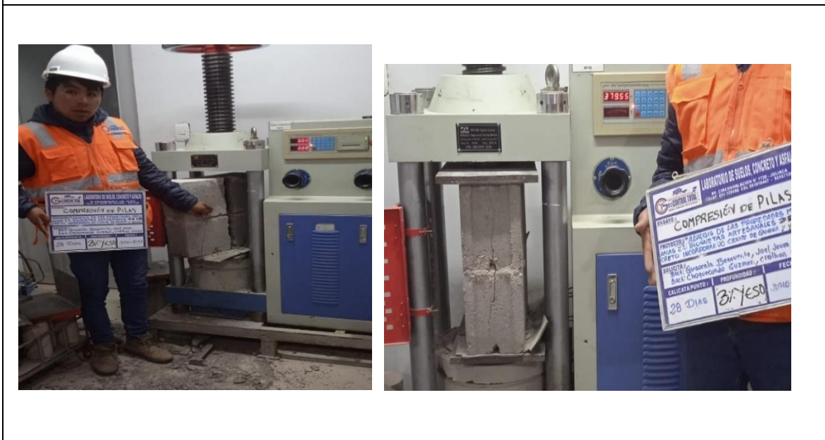
Imagen N° 13- se observa el ensayo de compresión de pilas de albañilería a los 28 días
