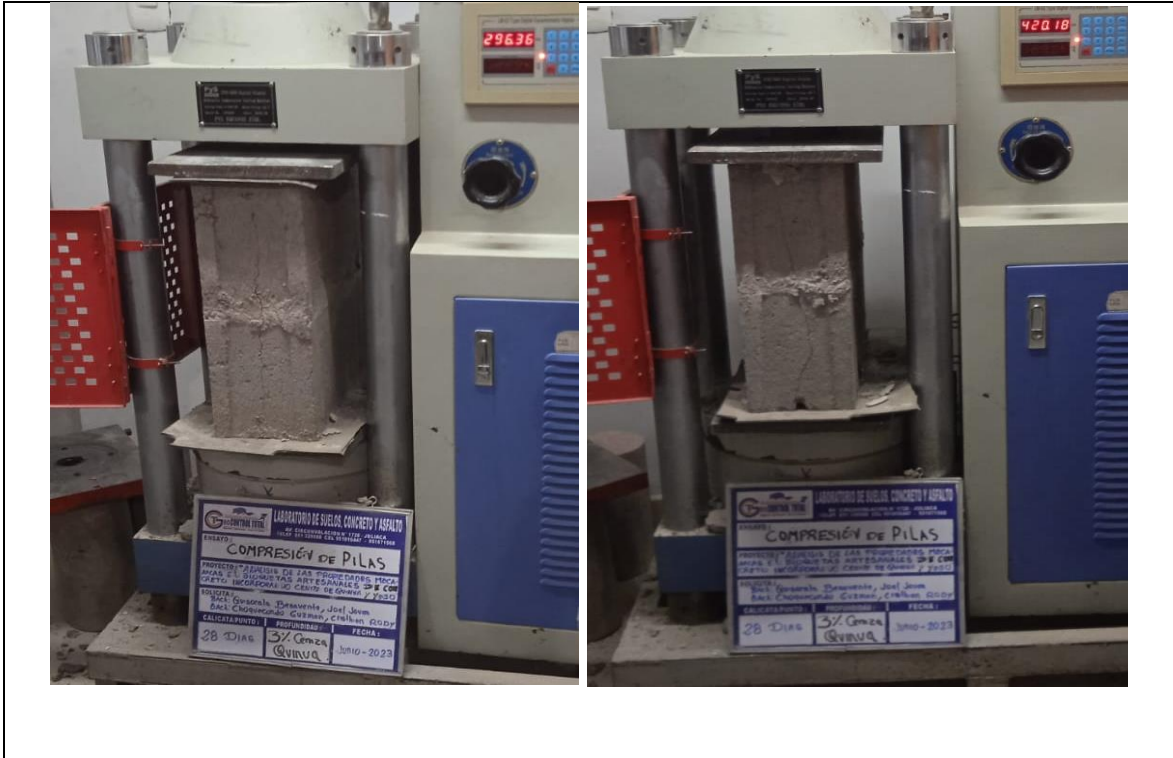
Imagen N° 14- se observa el ensayo de compresión de muretes de albañilería a los 28 días
