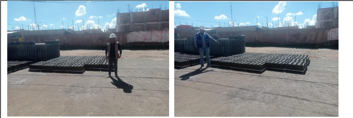
Imagen N°07- se observa la elaboración de pilas y muretes
