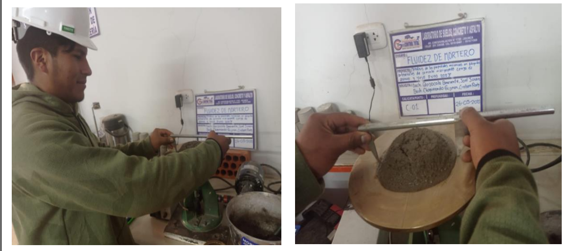
Imagen N°08- se observa el ensayo de fluidez – fraguado y compresión del mortero
