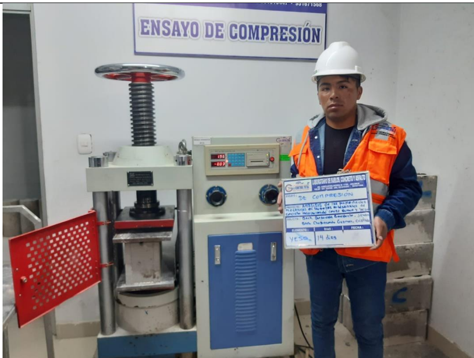
Imagen N° 11- se observa el ensayo de compresión de unidades de albañilería a los 14 días
