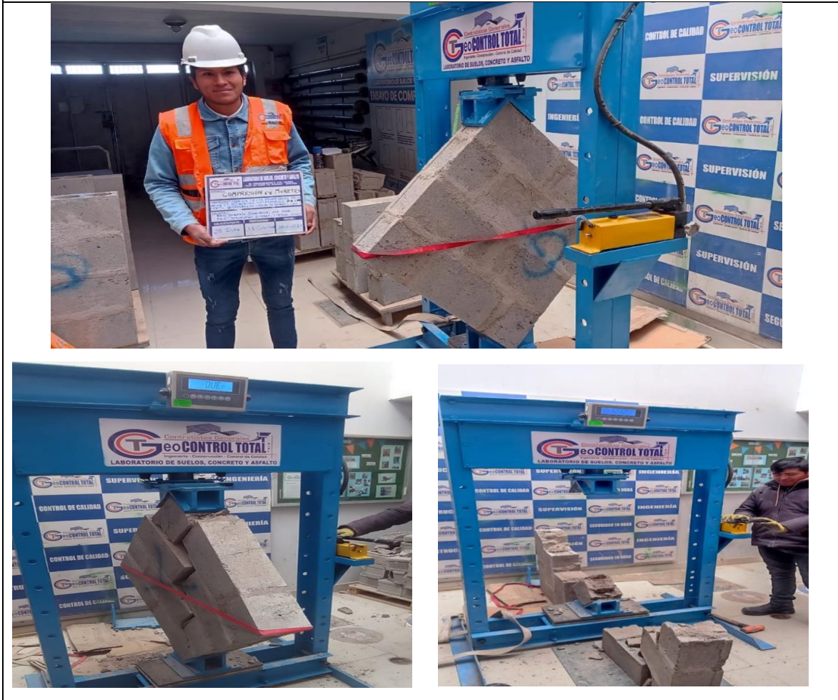
Imagen N° 14- se observa el ensayo de compresión de muretes de albañilería a los 28 días
