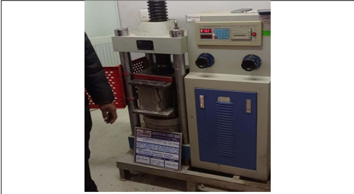
Imagen N° 13- se observa el ensayo de compresión de pilas de albañilería a los 28 días
