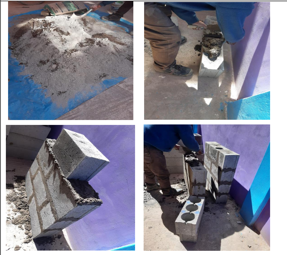
Imagen N°07- se observa la elaboración de pilas y muretes
