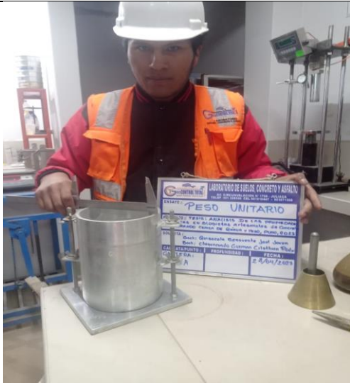
Imagen N°05- se observa los ensayo de peso unitario
