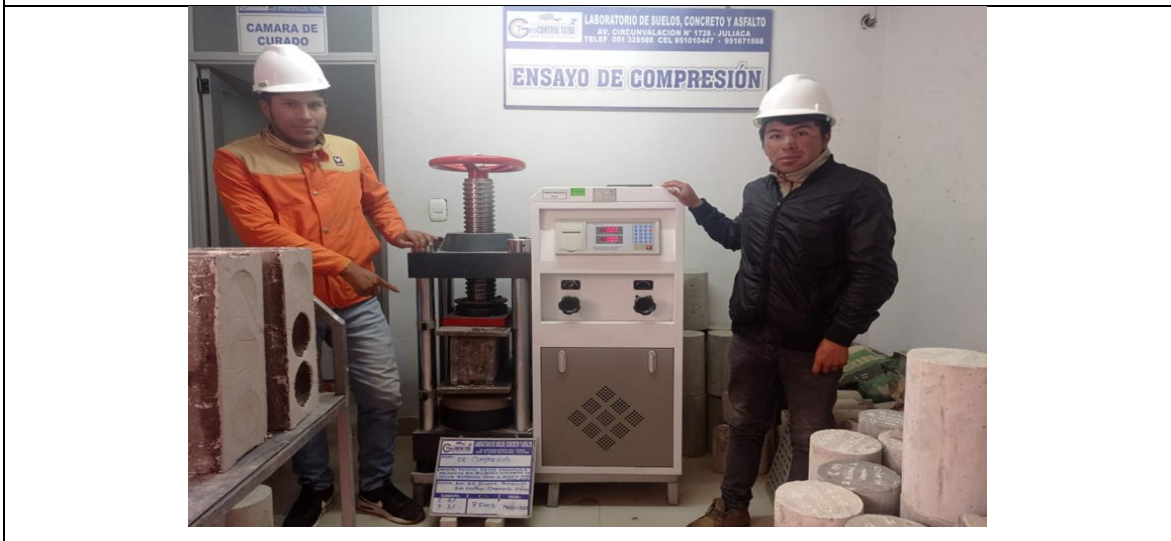
Imagen N°09- se observa el ensayo de compresión de unidades de albañilería a los 7 días
