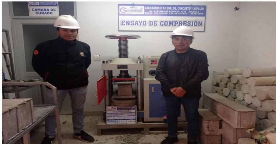
Imagen N°10- se observa el ensayo de compresión de unidades de albañilería a los 7 días
