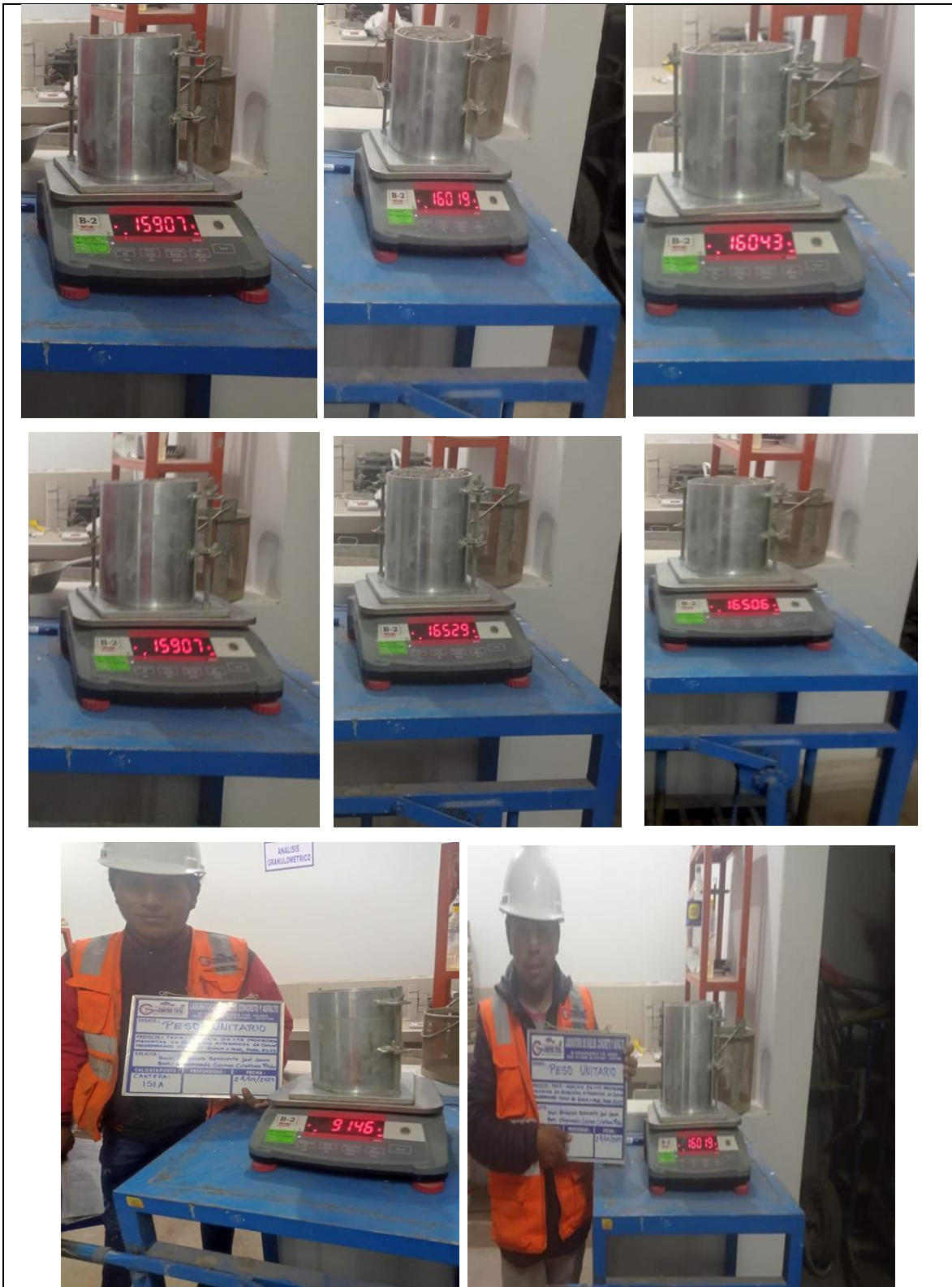
Imagen N°06- se observa los diseños de bloquetas adicionando ceniza de quinua y yeso en 3%, 5%, 8% , y por separado
