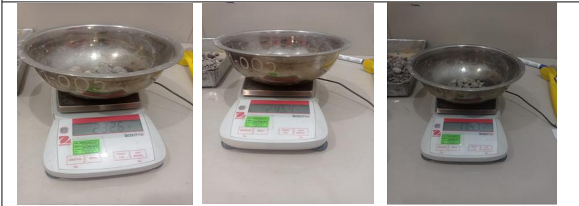
Imagen N°03- se observa los ensayo de contenido de humedad
