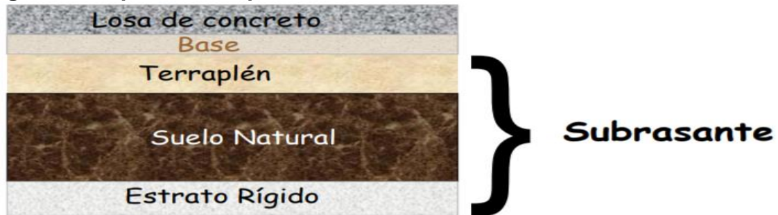
Figura 1. Esquema de capas de subrasante.
