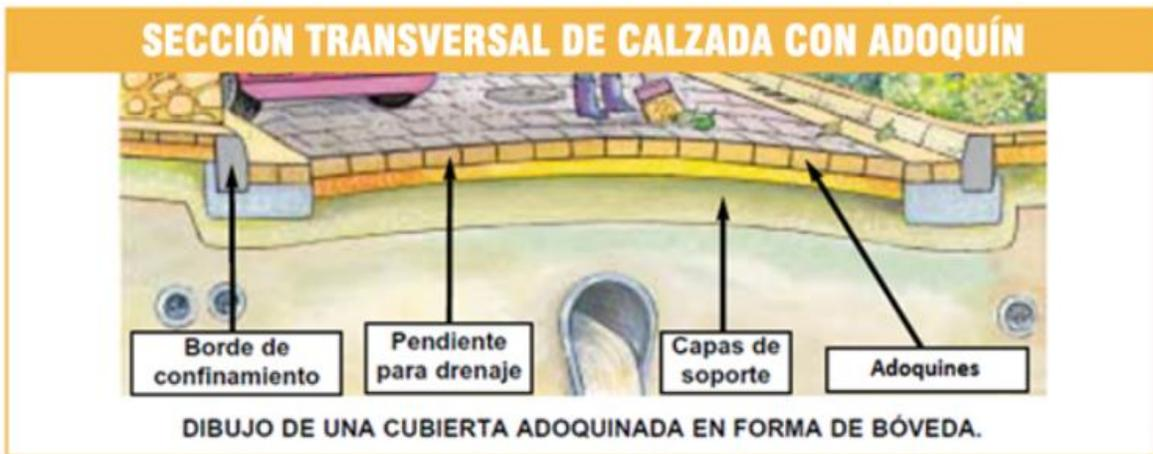
Figura 26. Cubierta adoquinada en forma de bóveda
