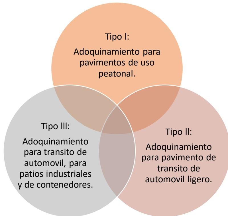
*Figura 1.* Tipos de adoquines
