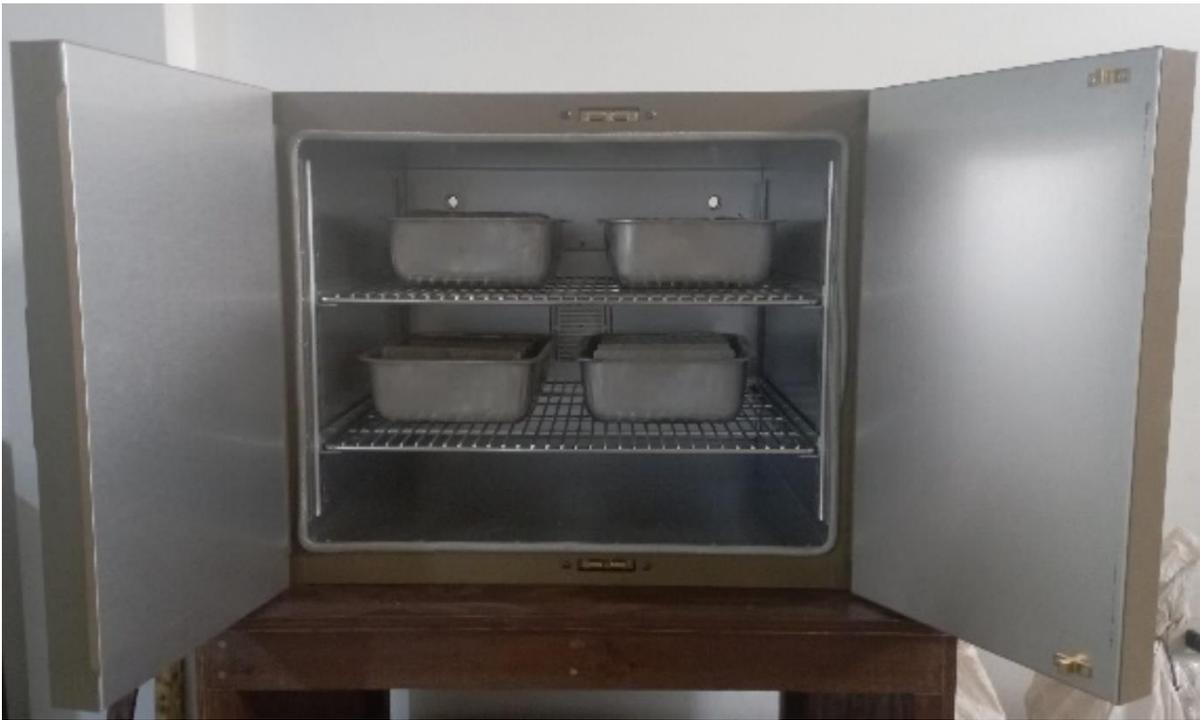
*Figura 34.* Proceso de secado en el horno de los adoquines a 110°C.
