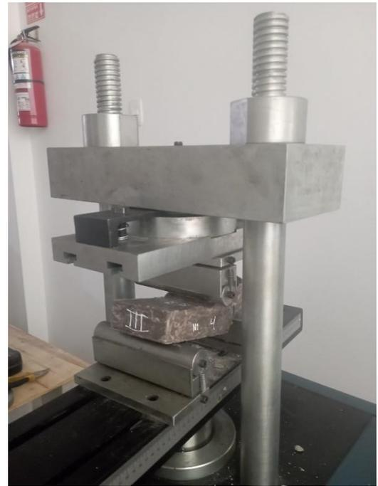
*Figura 30.* Adoquines de concreto y adoquines PET, sometidas a los ensayos de compresión y flexión.
