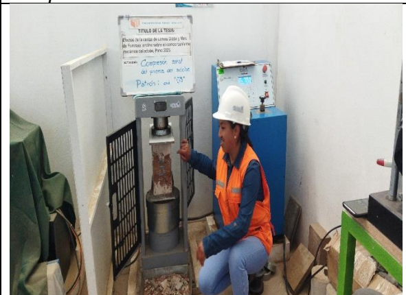
Fotografía 40. Ensayo de resistencia a la compresión del prisma de adobe
