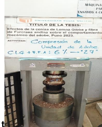
Fotografía 38. Ensayo de resistencia a la compresión de la unidad de adobe
