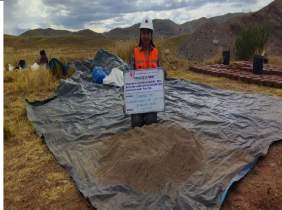
Fotografía 25. Ceniza de Lemna gibba previo al mezclado
