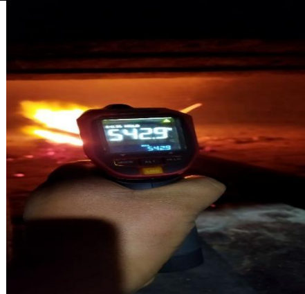
Fotografía 10. Medición de temperatura de calcinado
