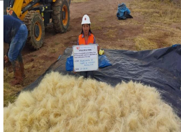
Fotografía 26. Fibra de Furcraea andina previo al mezclado para la fabricación de adobes.
