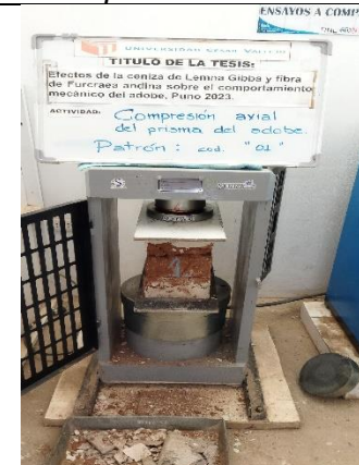
Fotografía 42. Ensayo de resistencia a la compresión del prisma de adobe
