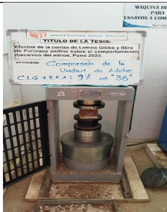
Fotografía 39. Ensayo de resistencia a la compresión de la unidad de adobe
