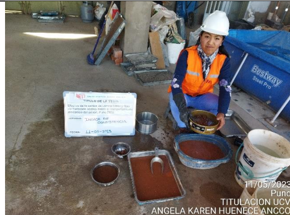
Fotografía 21. Tamizado de la muestra mediante la malla #200
