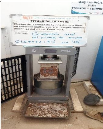
Fotografía 41. Ensayo de resistencia a la compresión del prisma de adobe
