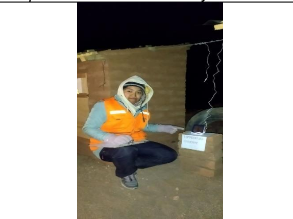
Fotografía 65. Medición de las temperaturas en los módulos y el exterior
