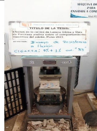
Fotografía 44. Ensayo de resistencia a la flexión del adobe
