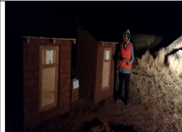
Fotografía 64. Medición de las temperaturas en los módulos y el exterior
