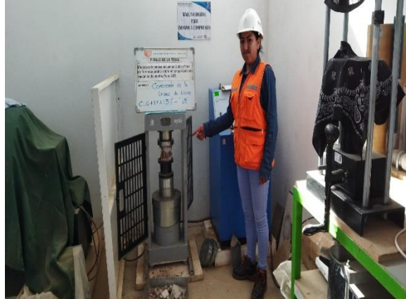
Fotografía 37. Ensayo de resistencia a la compresión de la unidad de adobe
