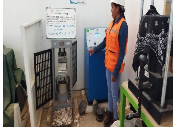
Fotografía 43. Ensayo de resistencia a la flexión del adobe
