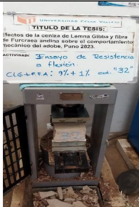
Fotografía 45. Ensayo de resistencia a la flexión del adobe
