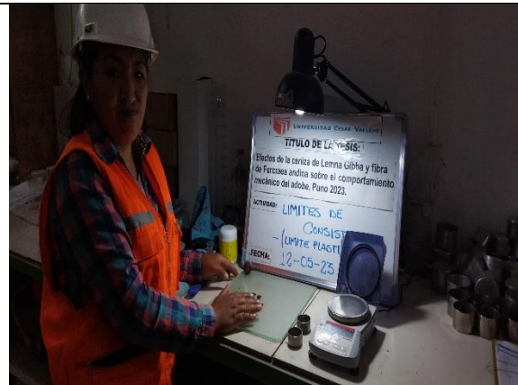
Fotografía 23. Elaboración de los bastoncitos de barro (ensayo de límite plástico)
