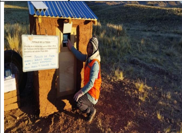
Fotografía 66. Medición de las temperaturas en los módulos y el exterior
