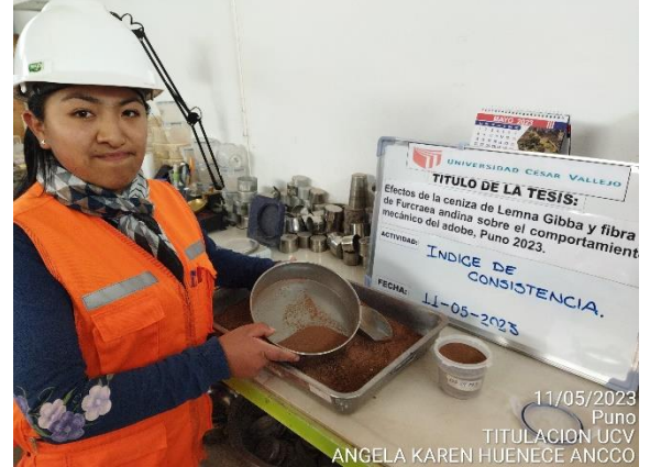
Fotografía 20. Tamizado de la muestra de suelo a través de la malla #40
