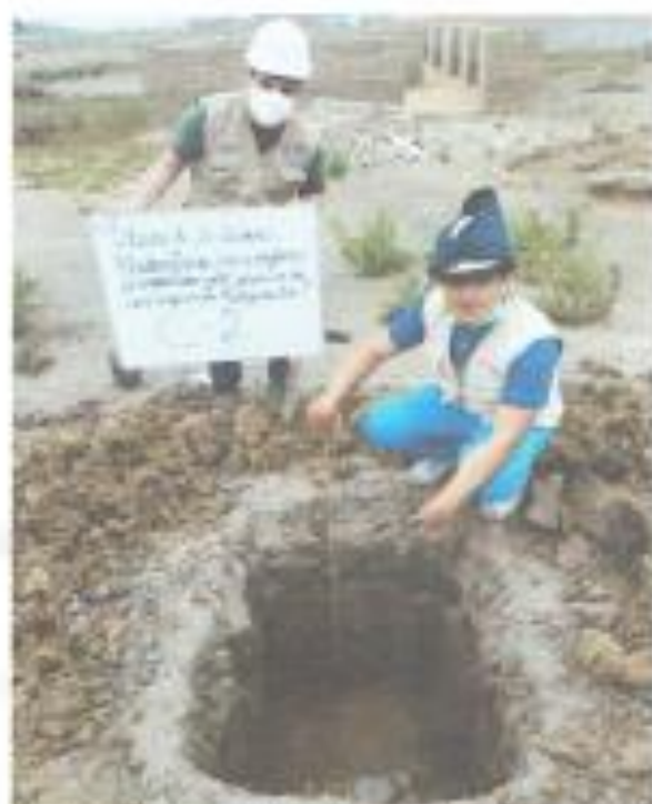
Foto N°03. Ubicación y apertura del suelo en calicata C-2, notándose el nivel freático. Coordenas WGS 84: Este: 625602.475, Norte: 8244510.870.
