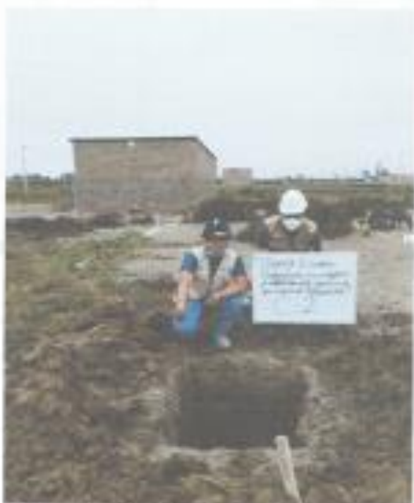
Foto N°04. Registro del perfil del suelo En calicata C-2.
