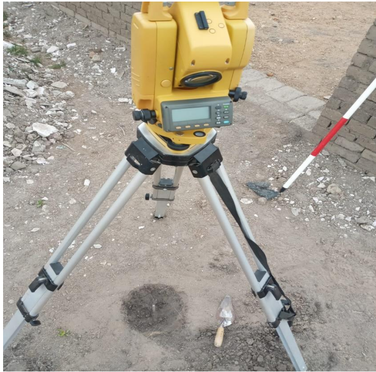
Foto 1. Posicionamiento de la estación.
