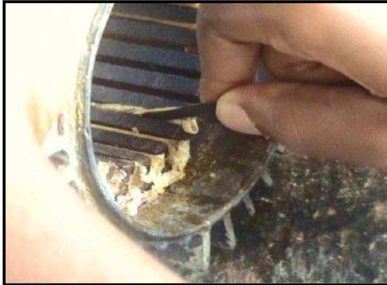
Figura 13 Limpieza de ranuras del estator
