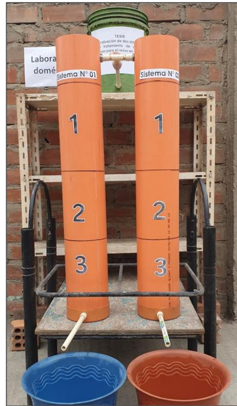
Foto 2. Columnas verticales puestas en el área de ensayo. Cada sistema de tratamiento miniaturizado fue estabilizada luego operadas para evaluar su eficiencia.
