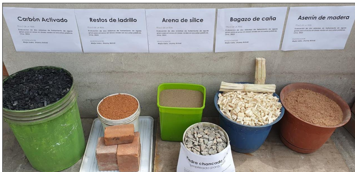
Foto 3. Los insumos utilizados en el proceso fueron previamente sometidos a una limpieza, lavado y secado rigurosos. Se empleó un listado de cinco medios filtrantes, distribuidos según la configuración de capas en cada una de las columnas verticales. El diseño procedimental detalla la secuencia y relevancia de cada uno de estos medios. La arena y el carbón activado se adquirieron a través de proveedores locales, mientras que los demás insumos fueron obtenidos a través de donaciones (personas y comercios artesanales locales), destacando tanto el abastecimiento asequible continuo de los insumos como la sostenibilidad en el funcionamiento de cualquiera de los sistemas de tratamiento evaluados.
