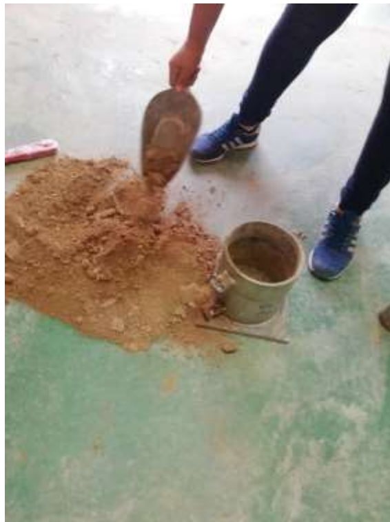
Fotografía 8: Agregando la primera capa de la muestra del suelo en el molde para el ensayo de ProctorModificado.
