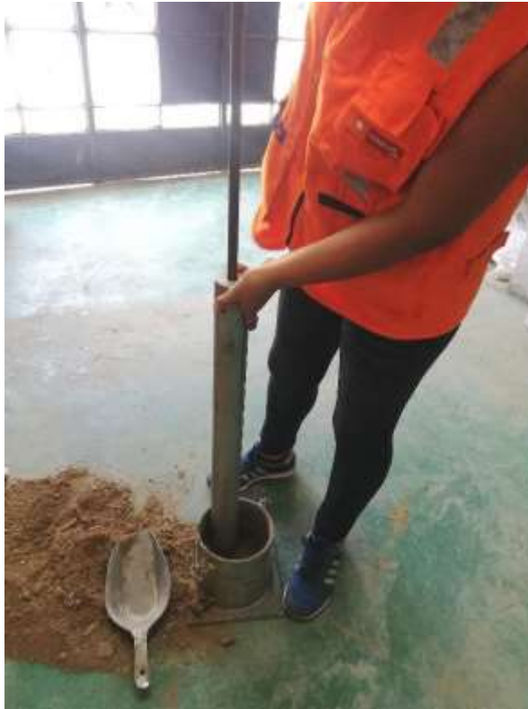
Fotografía 9: Realización de compactación del ensayo de CBR
