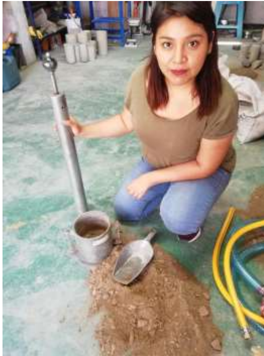
Fotografía 11: Compactación del ensayo de CBR de la Subrasante en combinación del Terrazyme
