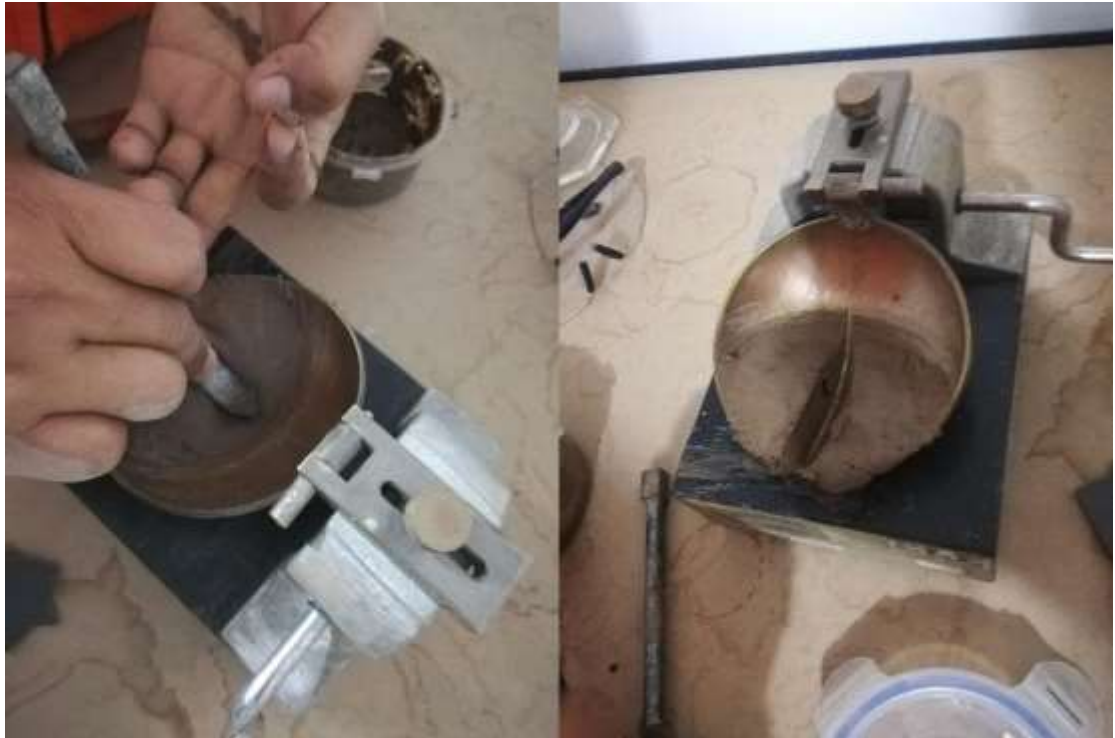
Fotografía 7: Ensayo de Limite liquido
