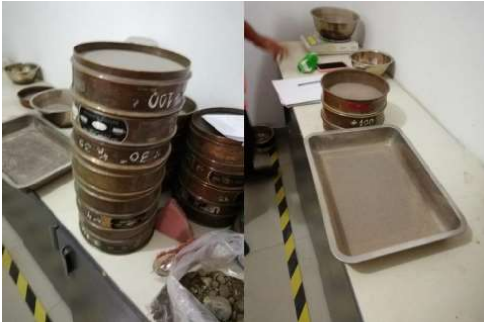
Fotografía 5: Ensayo de Granulometría
