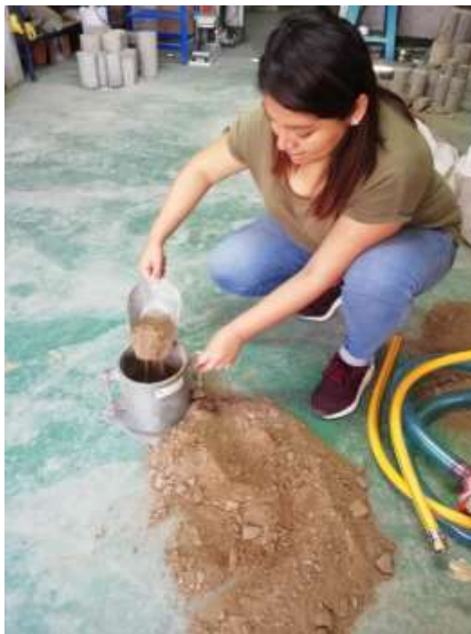
Fotografía 10: Agregando muestra con Terrazyme en la primera capa
