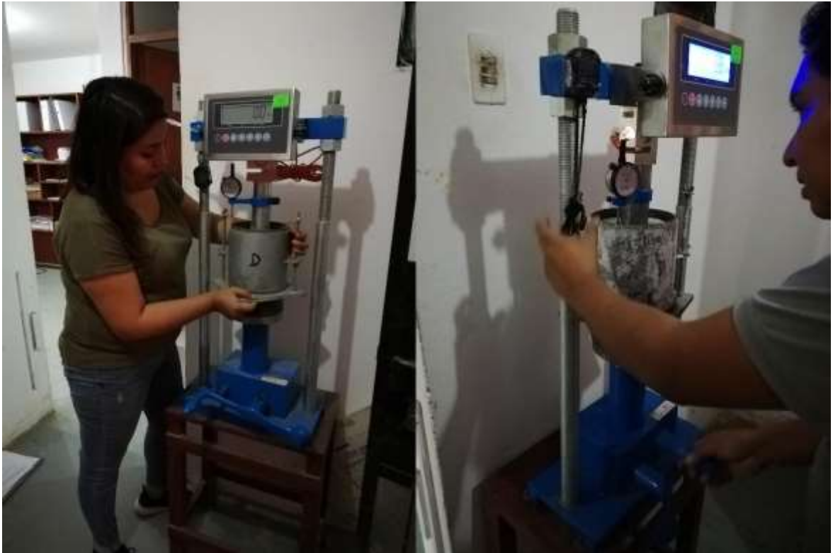
Fotografía 13: Realización de ensayo de Penetración
