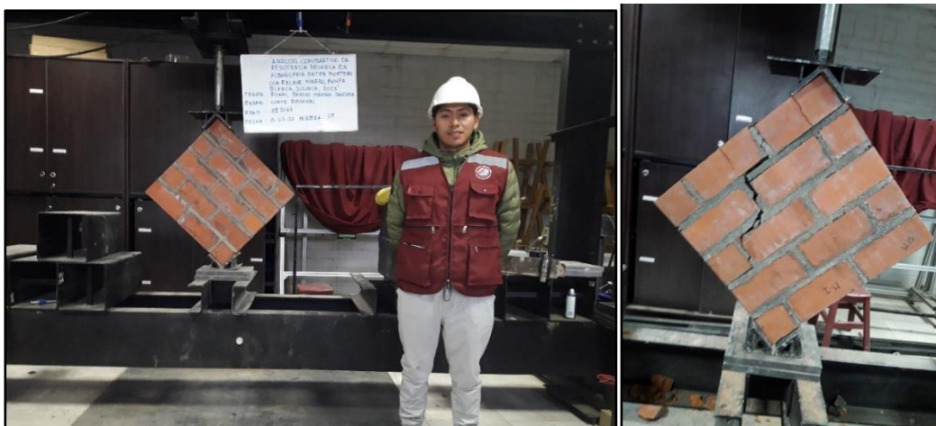
Figura 73. Ensayo de compresión diagonal de muretes y visualización de la falla.
