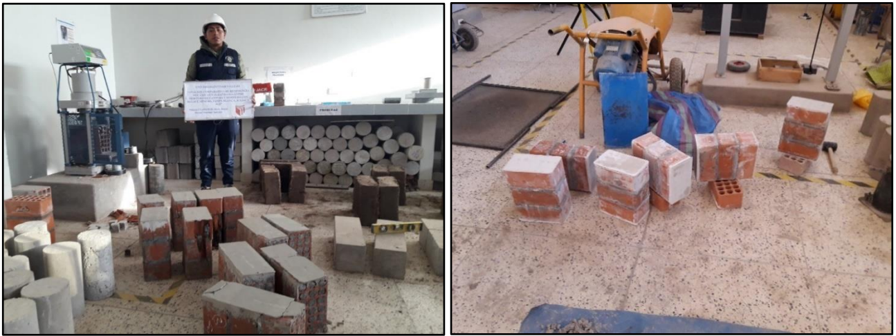
Figura 68. Refrendado de las pilas de albañilería antes de su rotura.
