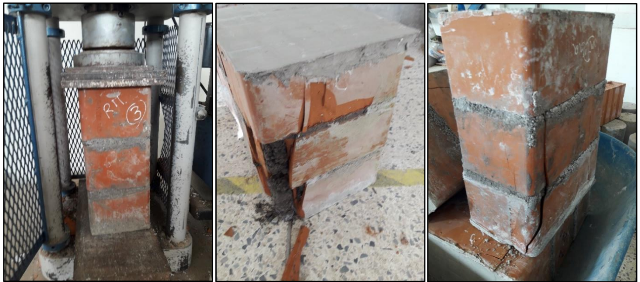
Figura 69. Ensayo a compresión de las pilas y visualización de las fallas.
