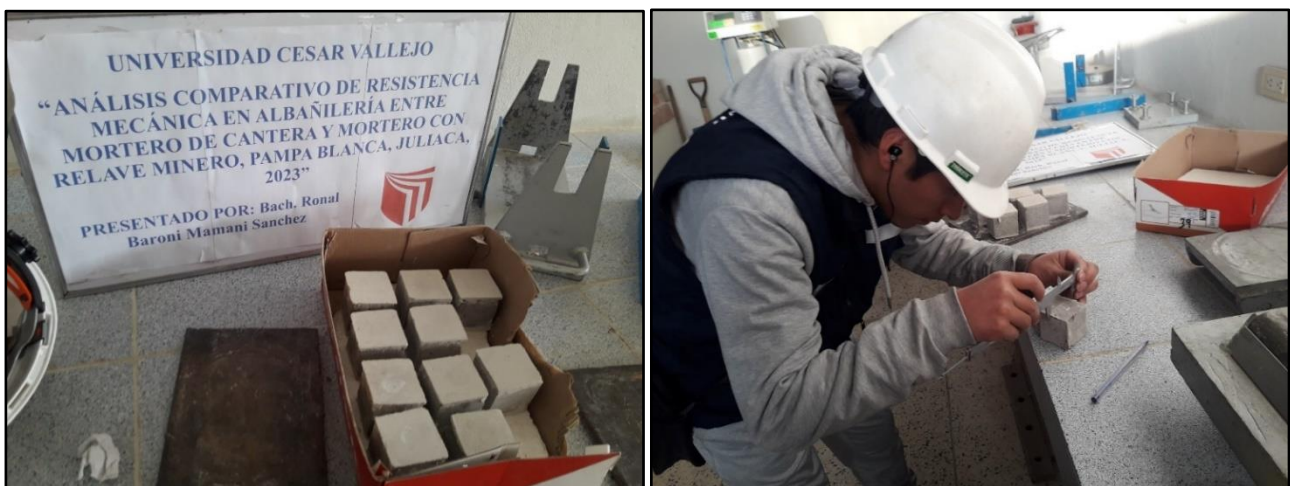
Figura 64. Preparación para rotura de los especímenes de 5x5 cm.
