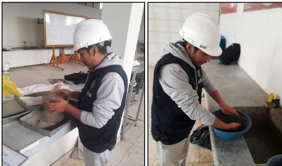
Figura 58. Tamizado y lavado de muestras después del ensayo de abrasión.
