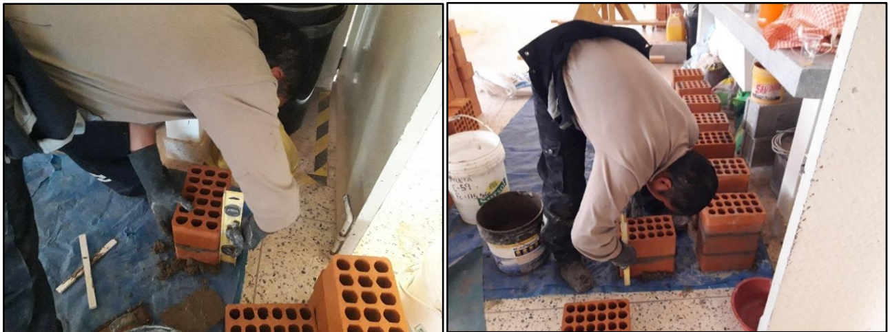
Figura 66. Elaboración de los especímenes pilas de albañilería de 3 hiladas.
