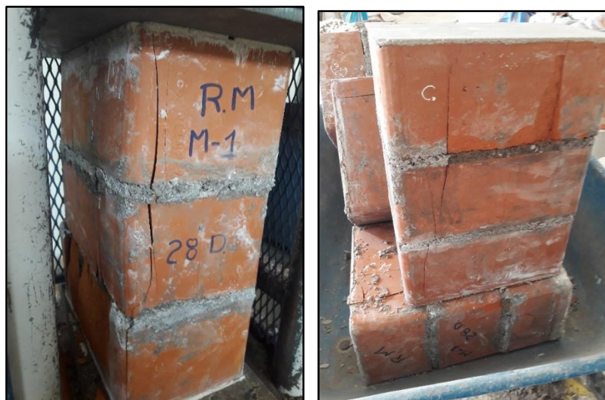
Figura 70. Fallas de las pilas de albañilería.
