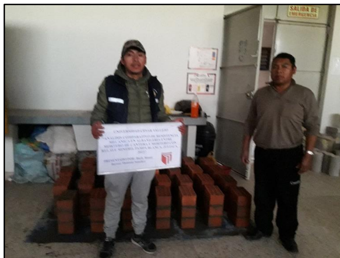
Figura 67. Elaboración de pilas de albañilería.
