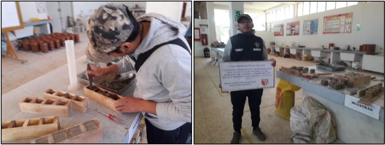
Figura 62. Compactado y desencofrado de los cubos de mortero de 5x5 cm.
