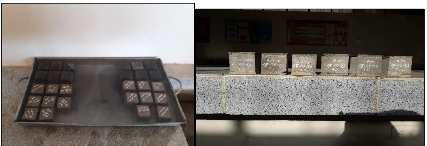
Figura 63. Curado de los especímenes para su posterior rotura según edad.
