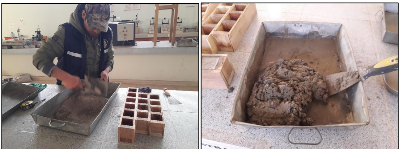
Figura 61. Preparación y colocación de mezcla para cubos de mortero de 5x5 cm.
