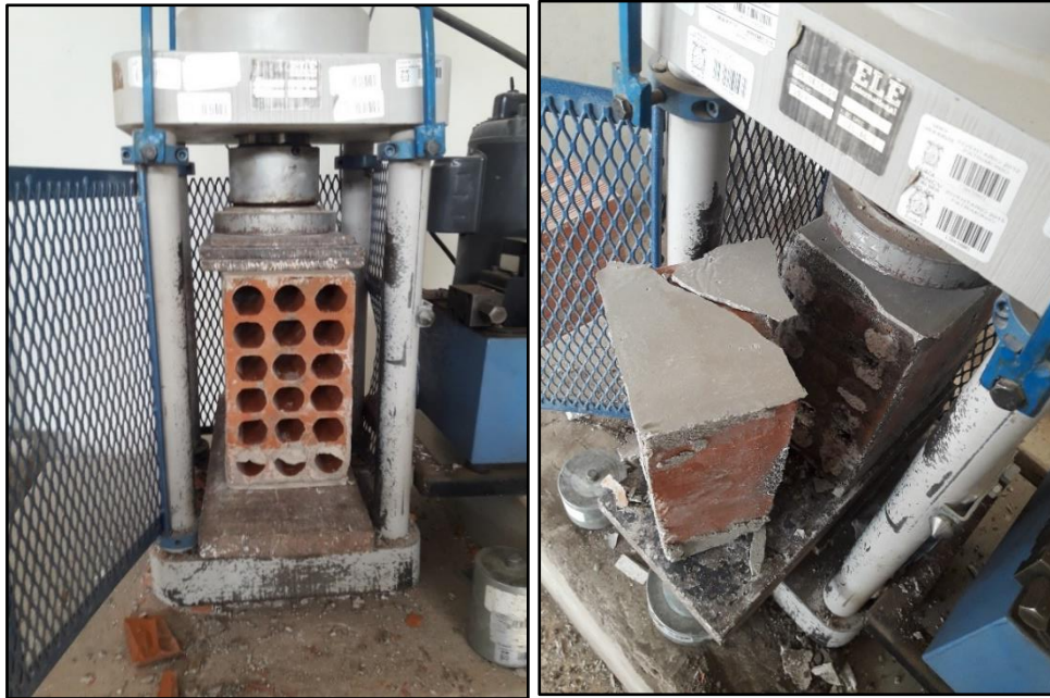
Figura 71. Ensayo de adherencia a cizalle y visualización de la falla.
