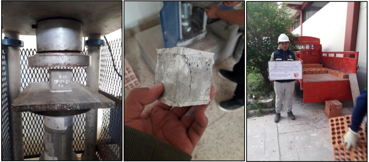
Figura 65. Ensayo a compresión de los especímenes de 5x5 cm. y visualización de la falla.
