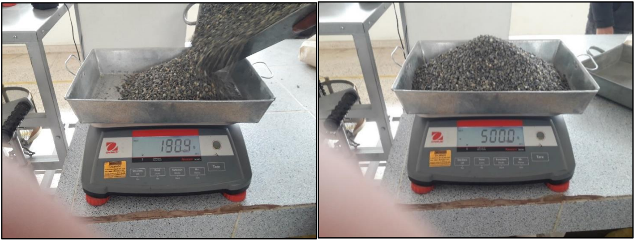
Figura 56. Peso de los agregados después del tamizado.
