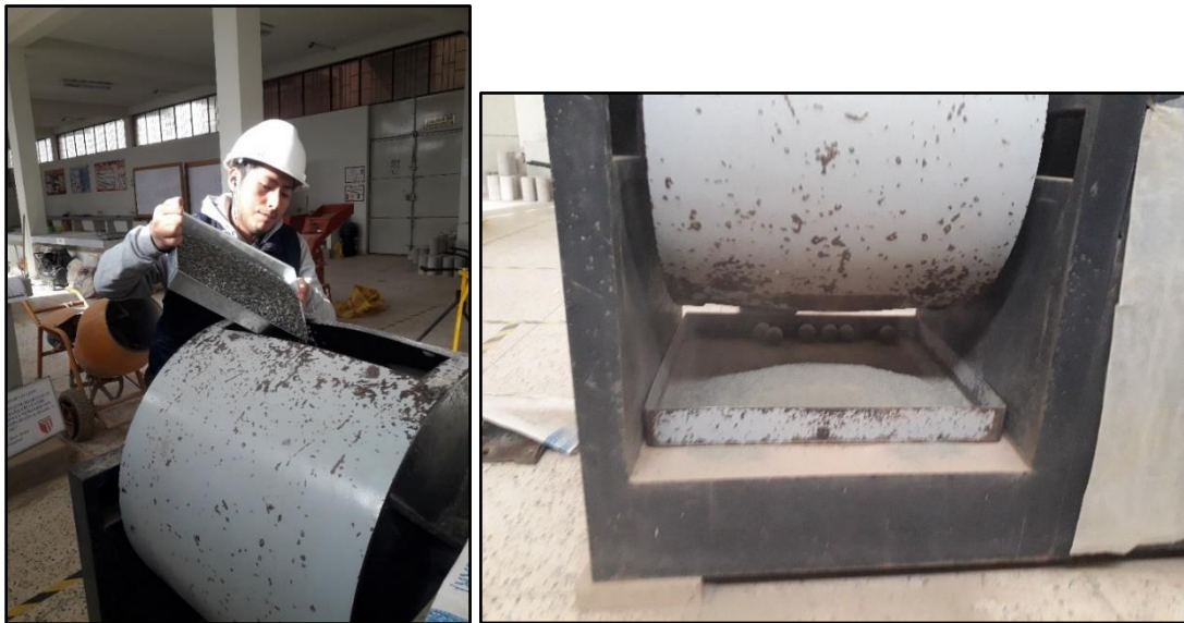
Figura 57. Colocación de muestras en la máquina de ensayo de abrasión de los ángeles.
