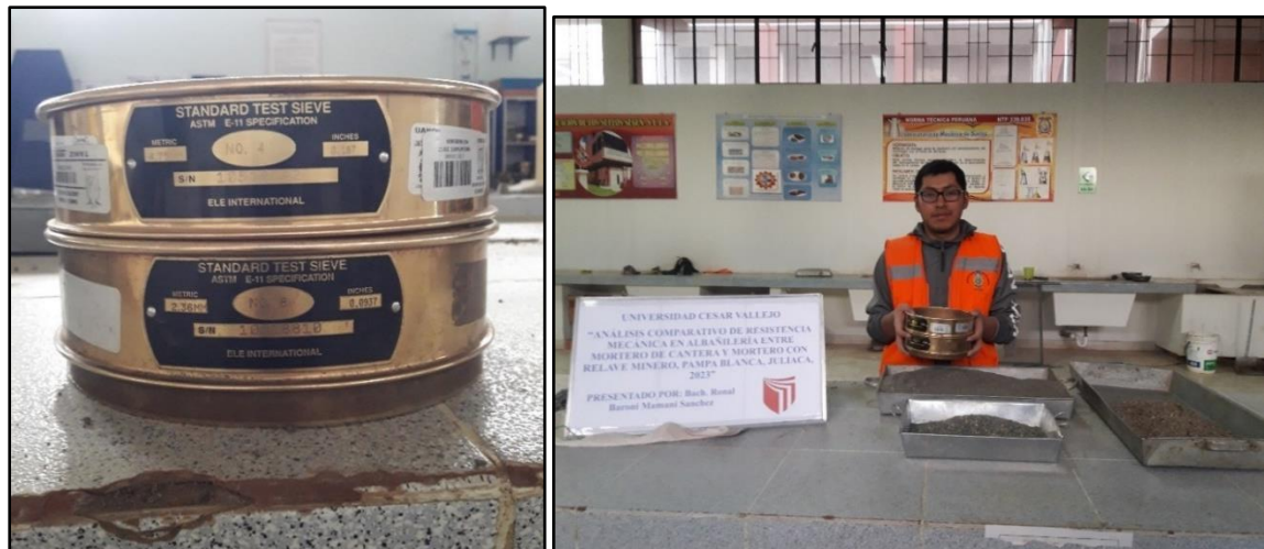
Figura 55. Tamizado para el ensayo de abrasión de los ángeles.
