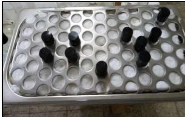
**Imagen 14** se muestra la identificación la Demanda química de oxígeno utilizando el método reactor térmico por 3 horas, para finalmente realizar una titulación con sulfato ferroso amoniacal y un indicador ferroina.
