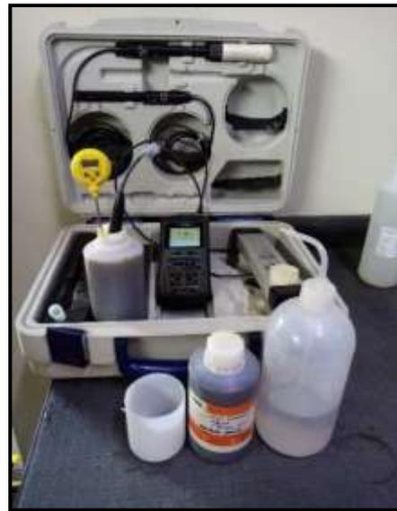
Imagen N° 1 se muestra la medición in situ con multiparametro de la muestra de cromo hexavalente de Temperatura y Potencial Hidrogeno (1-14)
