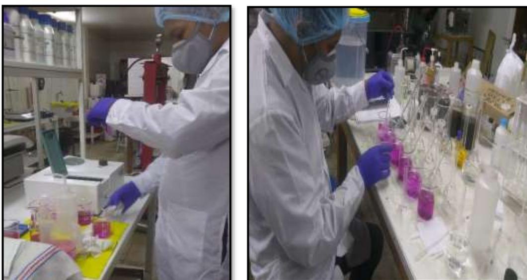
**Imagen N° 4:** se demuestra la caracterización inicial del cromo hexavalente existente en el agua residual de la industria del cromado usando el método de Lambert - Beer fue utilizado con un espectrofotómetro UV-V la que a una determinada longitud de onda determina por tramitancia y absorbancia la concentración del cromo hexavalente.
