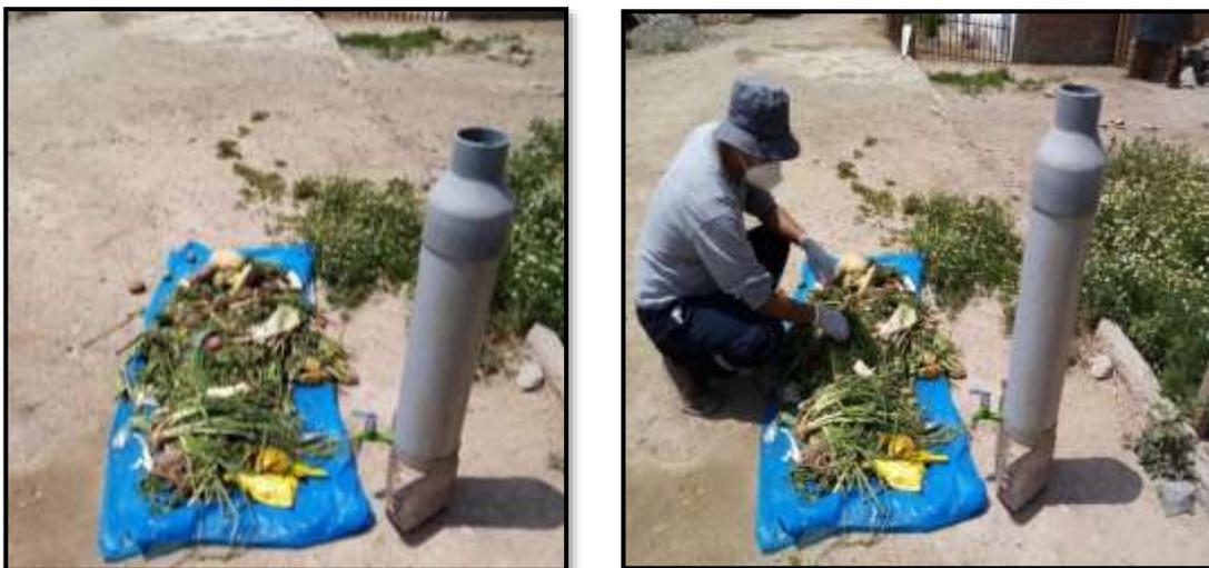
**Imagen N° 3:** se muestra la caracterización de los residuos orgánicos con un biorreactor artesanal, una vez culminado la caracterización se incubo por 7 días agregando 3 litros de agua.
