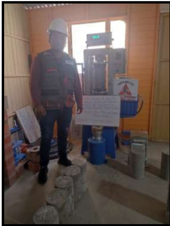
Fotografía 8. Rotura de especímenes
