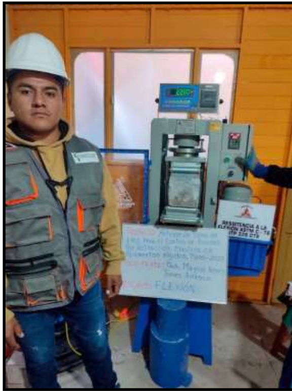
Fotografía 10. Ensayo a flexión 28 días
