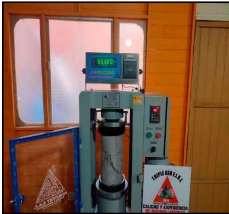
Fotografía 9. Ensayo a compresión 28 días
