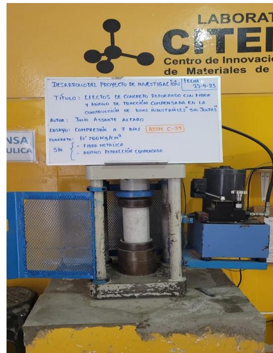
Ensayo a compresión de testigos de concreto con fibra metálica
