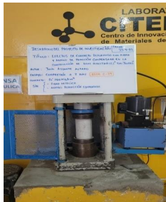
Fig. 16 Ensayo de compresión sin fibra metálica
