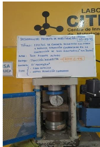
Fig. 19 Prueba de laboratorio de tracción con fibra metálica
