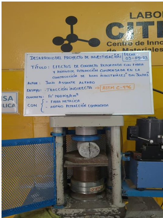
Ensayo a tracción de testigo de concreto con fibra metálica
