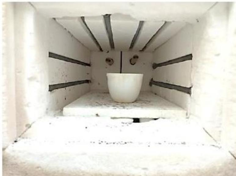
*Figura 5.* Calcinación de la muestra de cáscara de arroz en la mufla.
