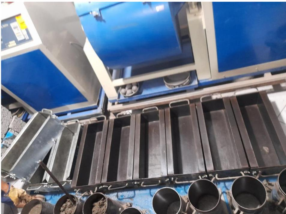
**MOLDES PARA LAS VIGAS Y CILINDROS**
