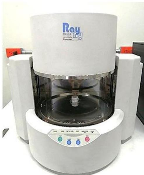
*Figura 7.* Espectrómetro de fluorescencia de Rayos X (SHIMADZU, EDX-800HS)
