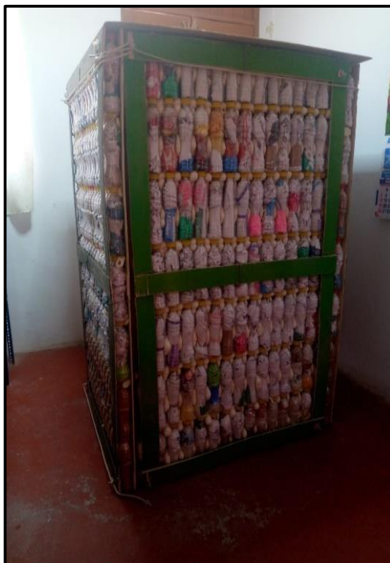
Figura 11: Barrera Acústica con Eco-ladrillos, con techo y puerta - Diseño N° 2
