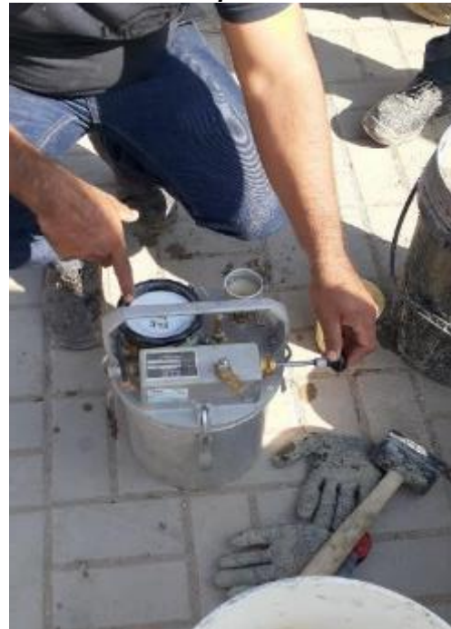
Foto 34. Ensayo de contenido de aire atrapado
