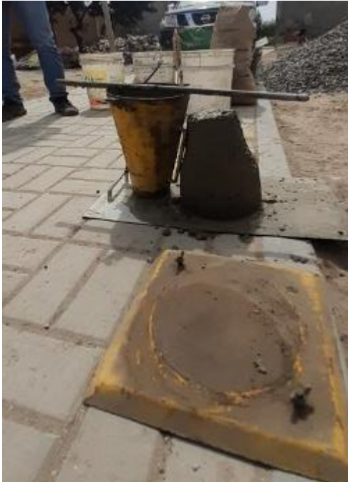
Foto 31. Ensayo de asentamiento
