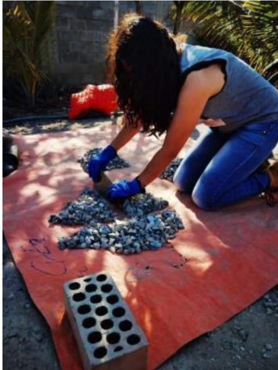
Foto 15. Proceso de cuarteo de muestra
