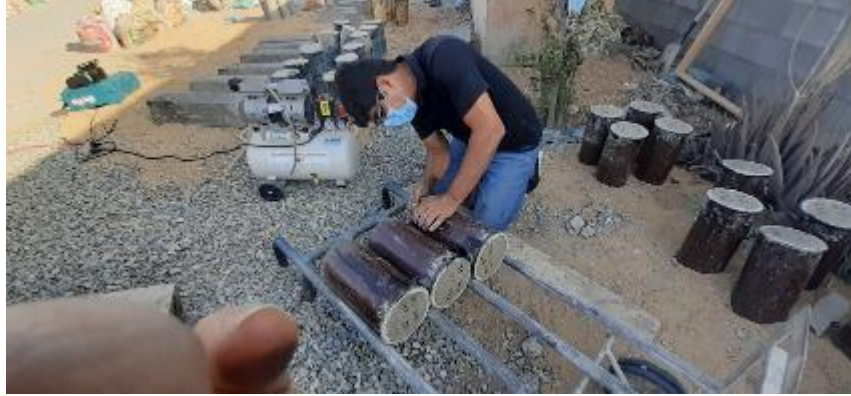
Figura 4. Curado de probetas
