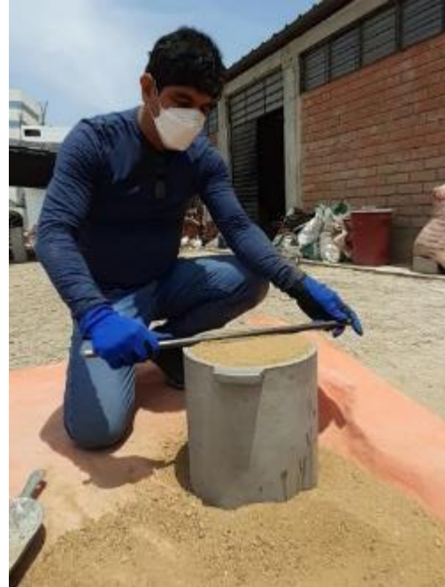
Foto 12. Enrasado de arena gruesa al nivel del recipiente
