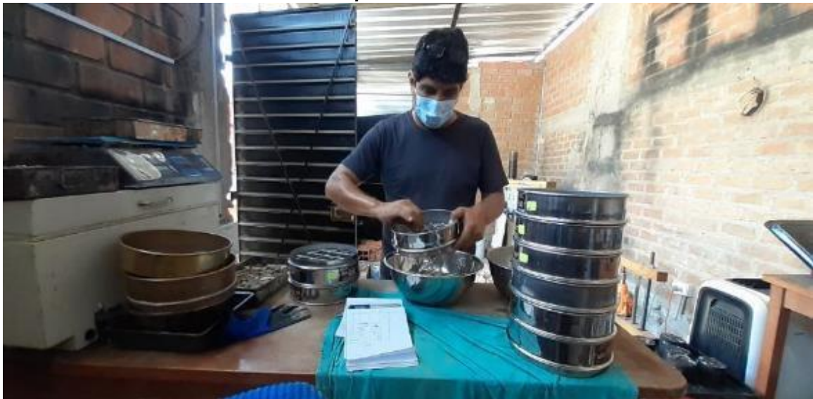
Foto 23. Proceso de tamizado por las diferentes mallas – Granulometría.
