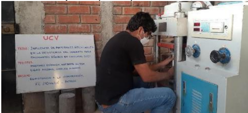
Foto 42. Ensayo de compresión a probetas cilíndricas a los 7 días.
