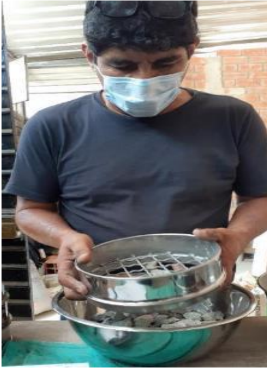
Foto 21. Ensayo de granulometría de grava.
