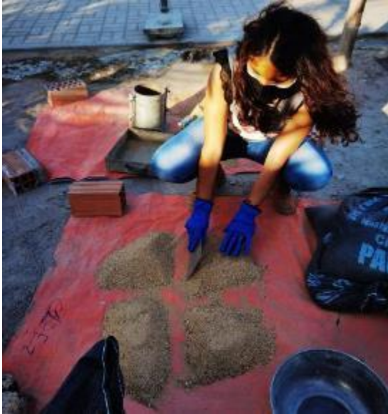
Foto 18. Cuarteo de arena para ensayo de peso específico y contenido de humedad
