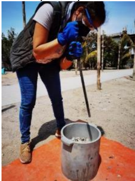
Foto 9. Apisonado de grava para ensayo de peso compactado
