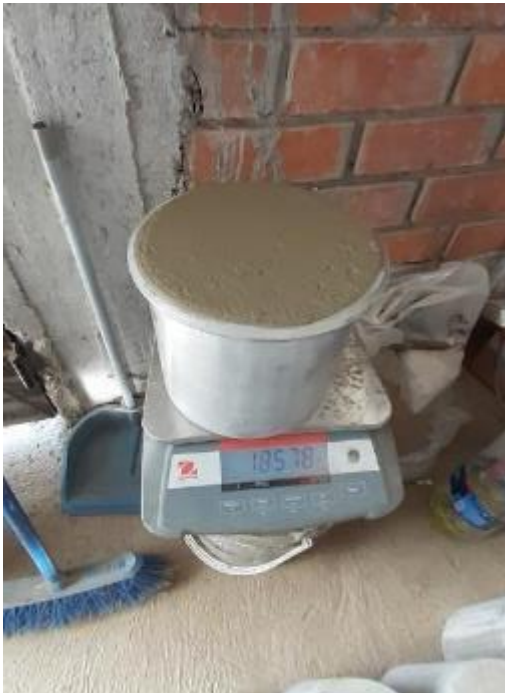
Foto 33. Ensayo de peso específico - concreto fresco
