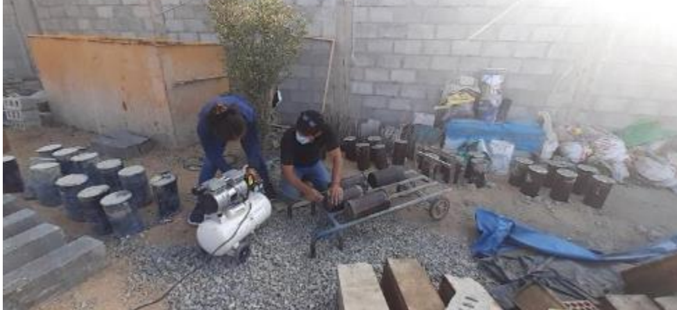
Foto 38. Desencofrado de probetas prismáticas y desmoldado de probetas cilíndricas.
