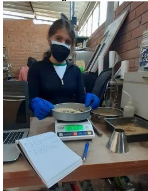
Foto 27. Pesado de muestra seca – arena gruesa.
