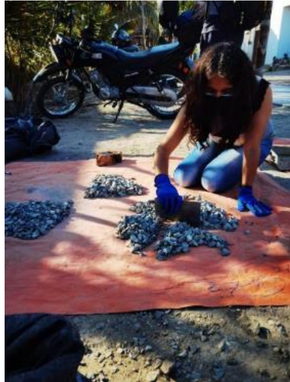
Foto 16. Proceso de cuarteo de muestra
