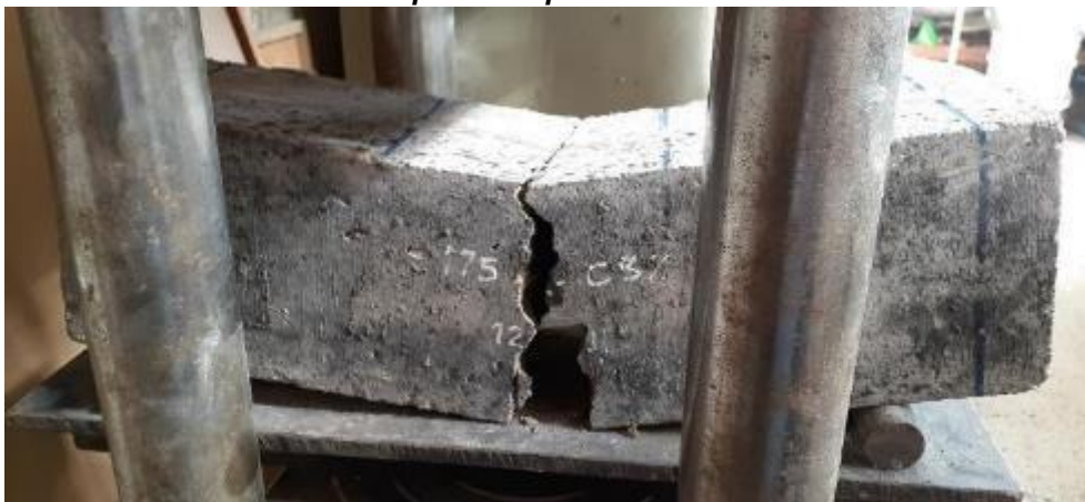
Foto 49. Rotura de probetas prismáticas a la edad de 28 días.
