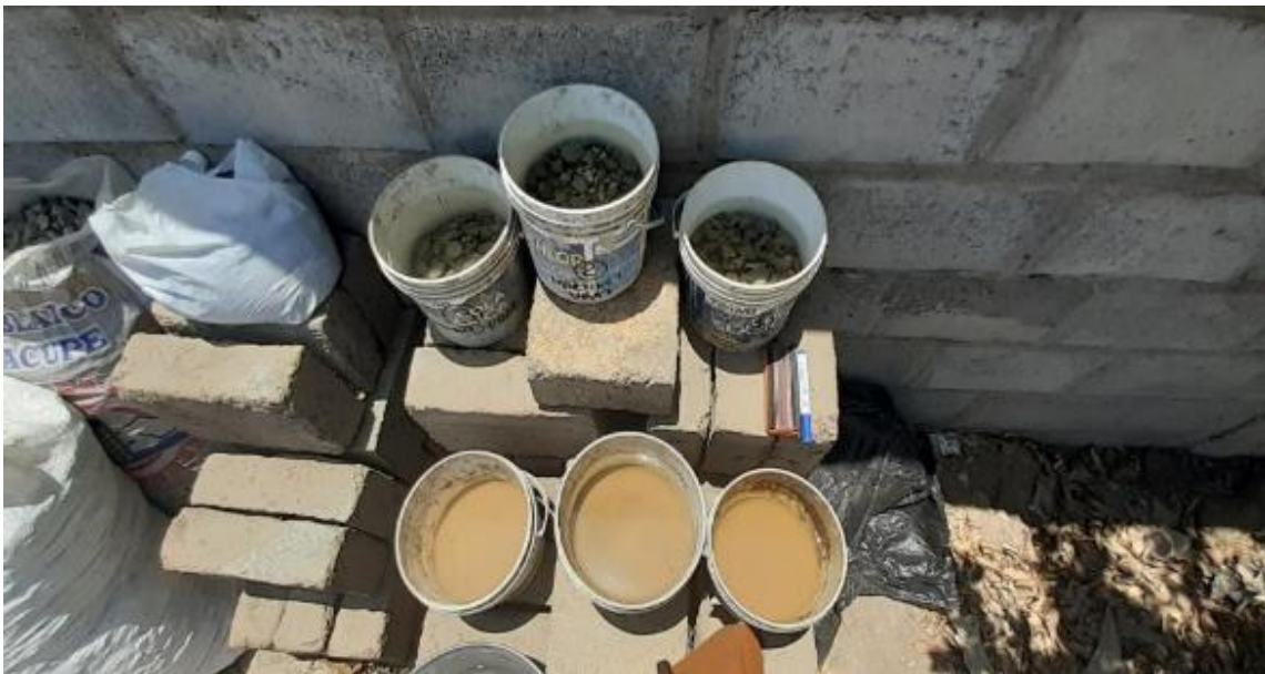
Foto 20. Saturación de muestras de arena y grava para ensayo de peso específico y contenido de humedad.
