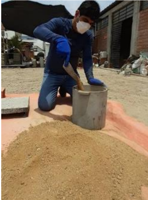
Foto 11. Llenado del recipiente con arena gruesa, en caída libre
