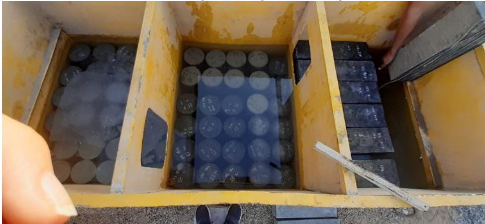
Foto 39. Curados de probetas prismáticas y cilíndricas.
