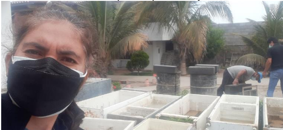
Foto 40. Curados de probetas prismáticas y cilíndricas.
