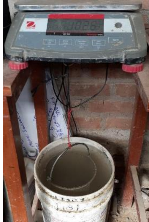
Foto 25. Mezcla de grava sumergida.
