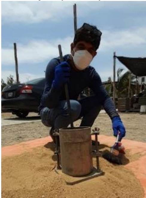
Foto 13. Apisonado de arena gruesa para ensayo de peso compactado
