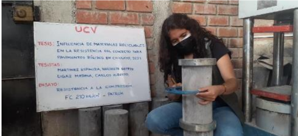
Foto 41. Toma de medida del diámetro de las probetas cilíndricas a la edad de 7 días
