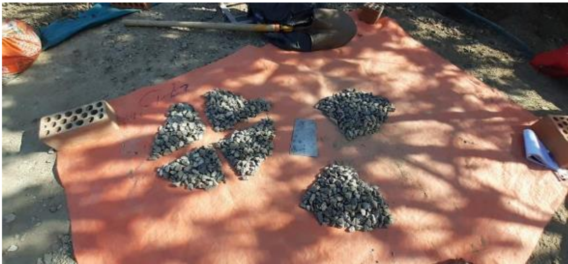
Foto 17. Obtención de muestra representativa por el método de cuarteo.
