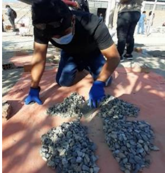
Foto 19. Cuarteo de grava para ensayo de peso específico y contenido de humedad
