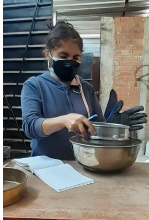
Foto 22. Ensayo de granulometría de arena gruesa.
