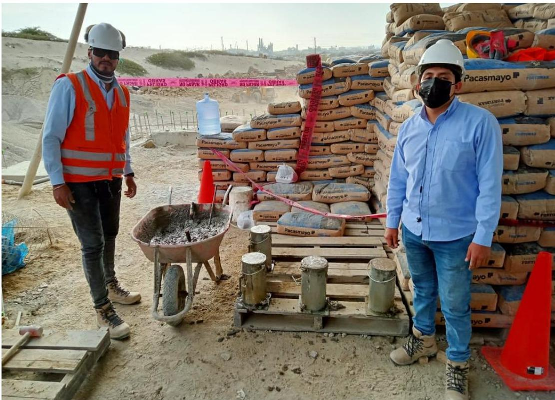
**Foto 18.** Segundo grupo de probetas con concreto  $F'c=280 \text{ Kg/cm}^2$
