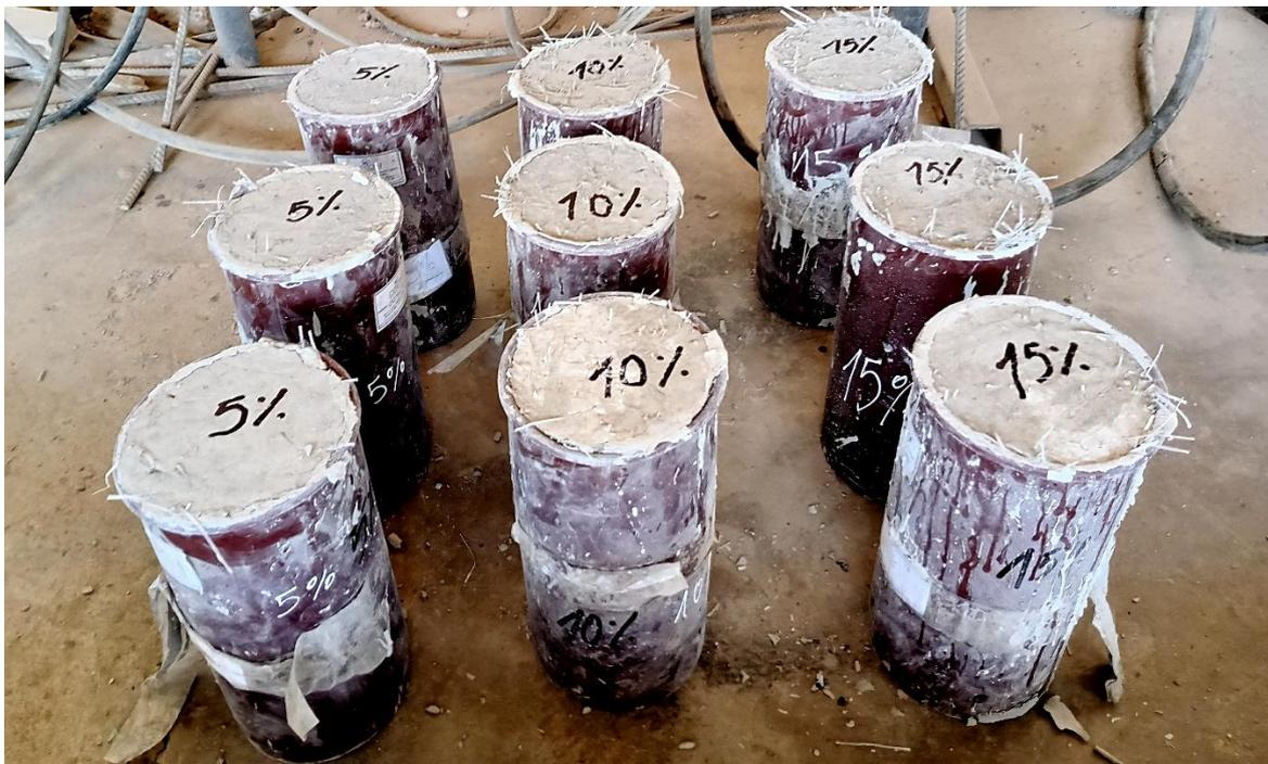
**Foto 22.** Cuarto grupo de probetas con concreto  $F'c=280$  Kg/cm<sup>2</sup> + fibra de polipropileno en estado endurecido
