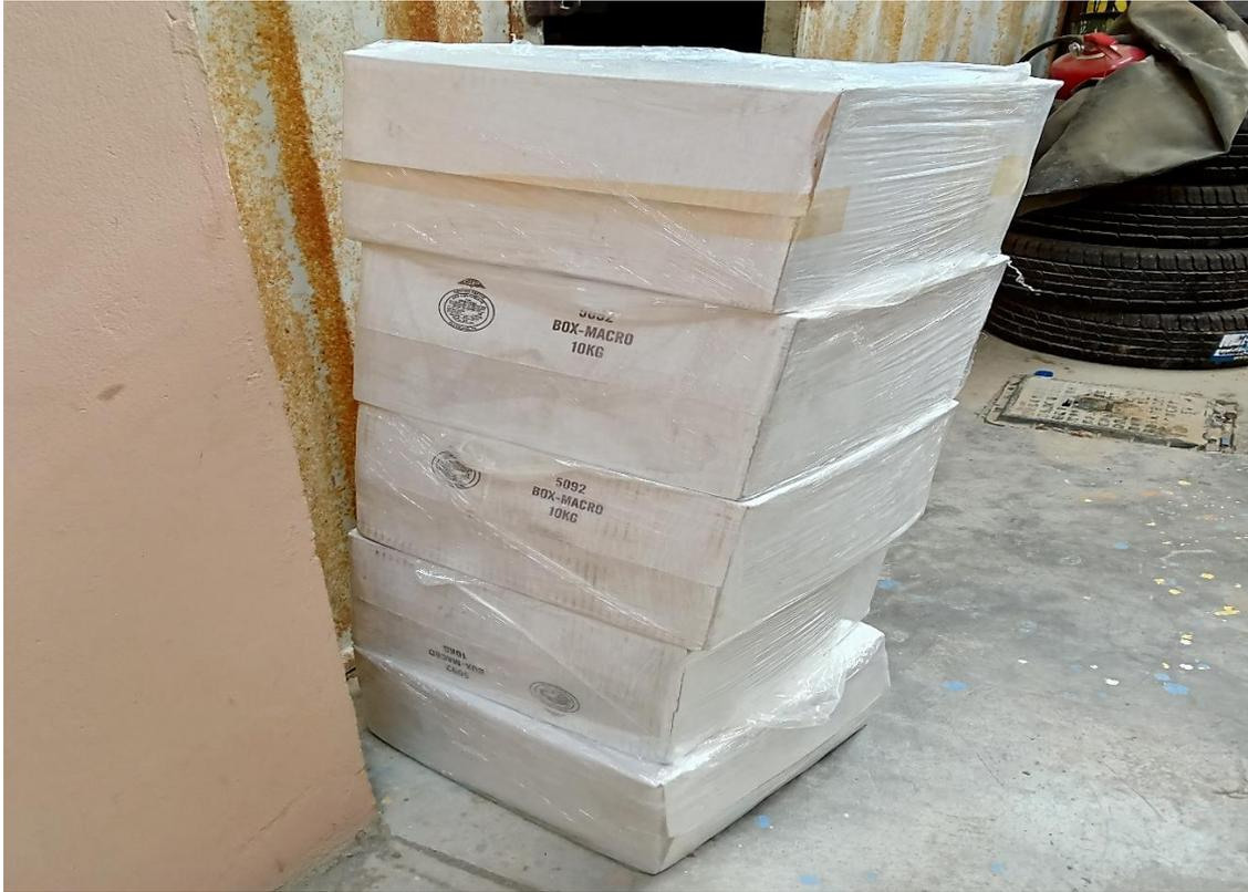
**Foto 1.** Cajas con fibra de polipropileno “Fibermesh-650 S” de la marca Sika®
