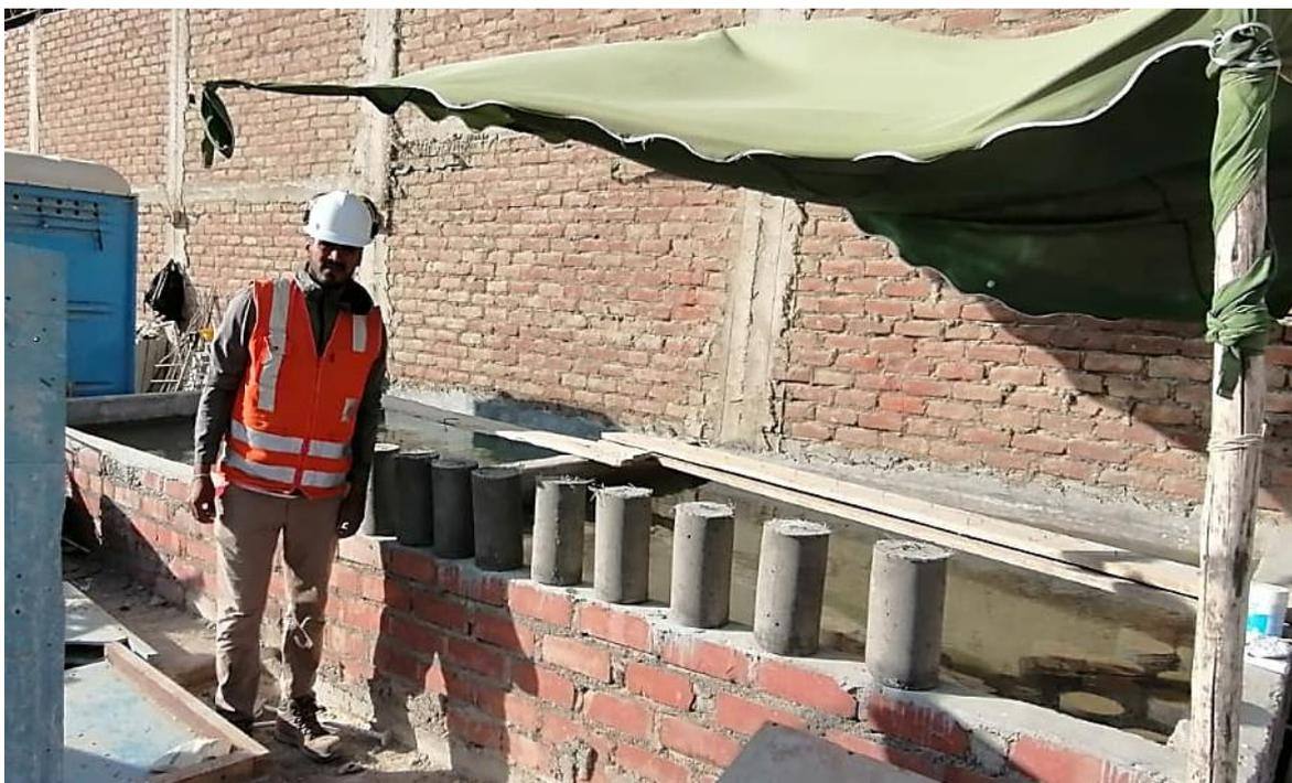
**Foto 26.** Grupo de probetas para su curado correspondiente
