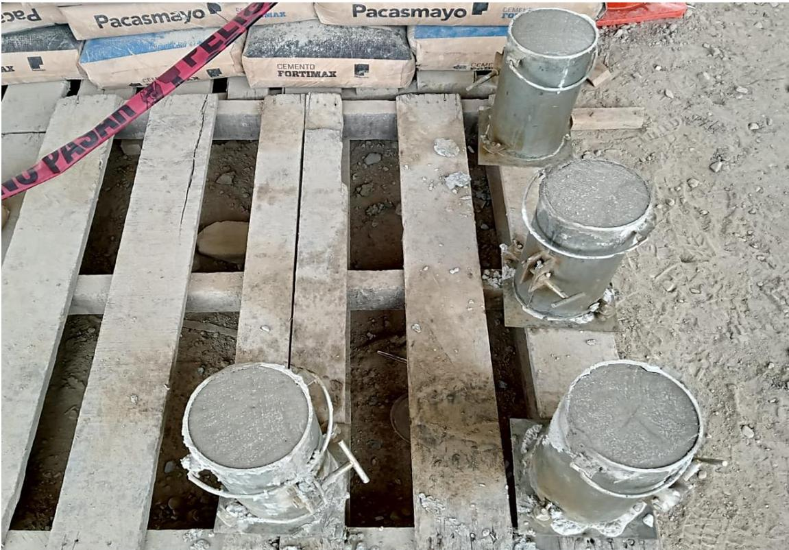
**Foto 21.** Segundo grupo de probetas con concreto  $F'c=280$  Kg/cm<sup>2</sup> en estado endurecido
