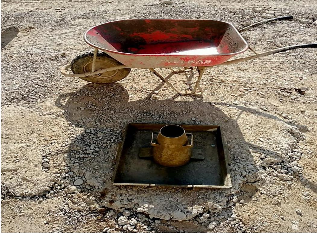
**Foto 5.** Equipo para el ensayo de asentamiento
