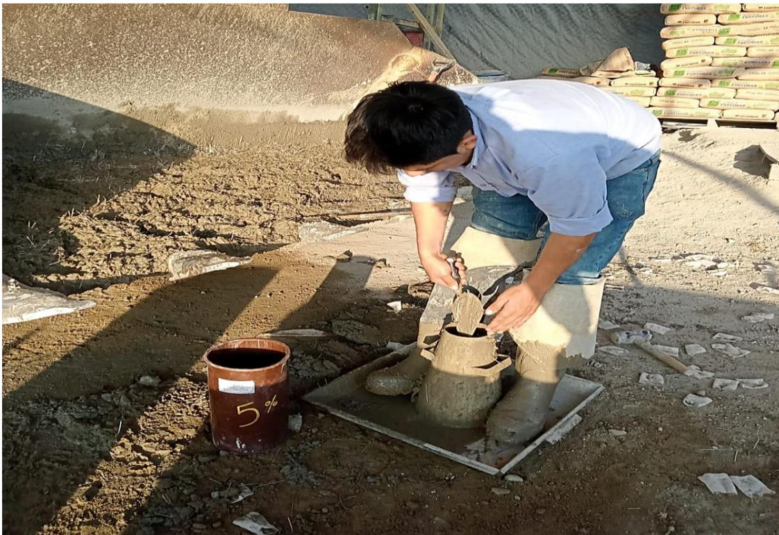
**Foto 8.** Llenado de cono de Abrams con concreto  $F'c=280 \text{ Kg/cm}^2$  + 5% de fibras de polipropileno
