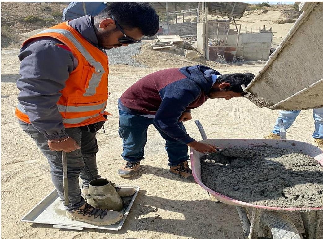
**Foto 6.** Colocación de la plancha y cono de Abrams sobre una superficie totalmente plana y rígida, previo al ensayo de asentamiento
