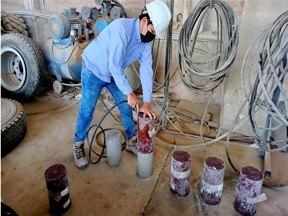
**Foto 25.** Uso del aire a compresión para desmoldar cuarto grupo de probetas de concreto  $F'c=280 \text{ Kg/cm}^2$  + fibra de polipropileno
