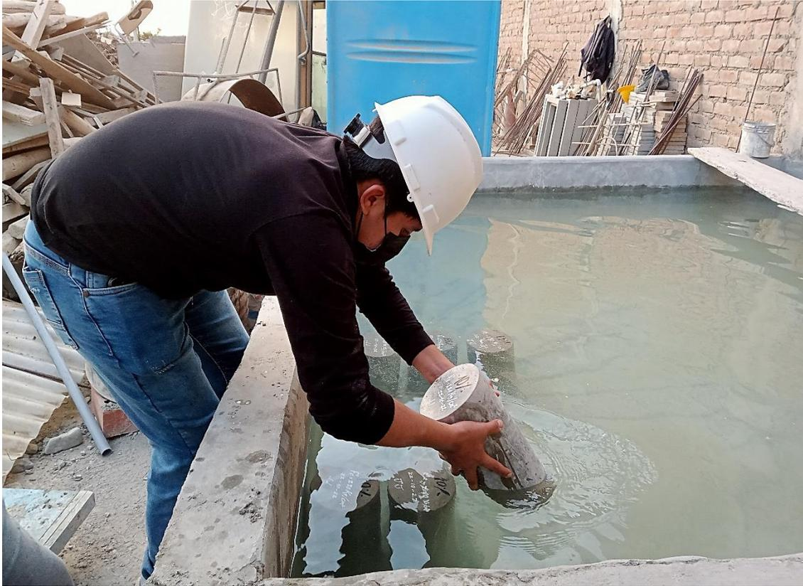
Foto 27. Colocación de probetas en piscina de curado
