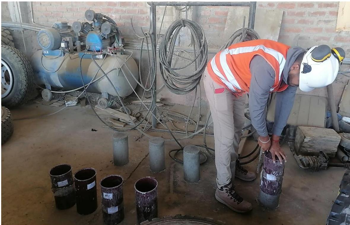
**Foto 24.** Uso del aire a compresión para desmoldar tercer grupo de probetas de concreto  $F'_c=280 \text{ Kg/cm}^2$  + fibra de polipropileno
