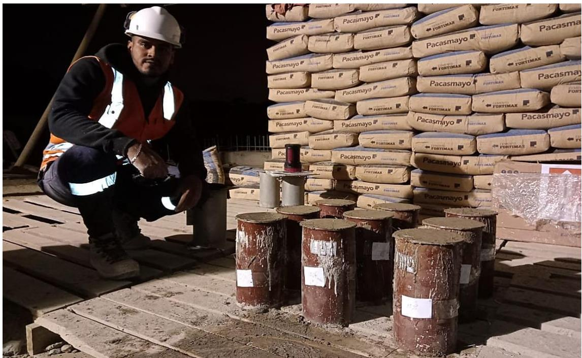
**Foto 20.** Cuarto grupo de probetas con concreto  $F'c=280 \text{ Kg/cm}^2$  + fibra de polipropileno
