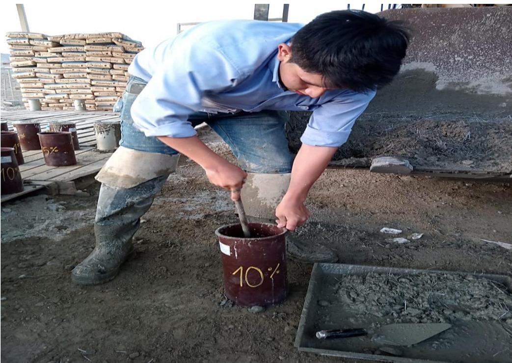
**Foto 14.** Varillado (se compactará 25 veces y de manera uniforme cada capa con el extremo redondeado de la varilla)
