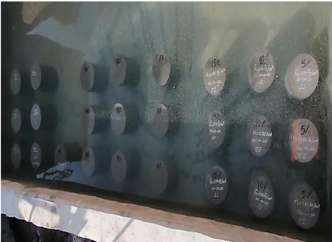
Foto 28. Probetas totalmente sumergidas en la piscina de curado
