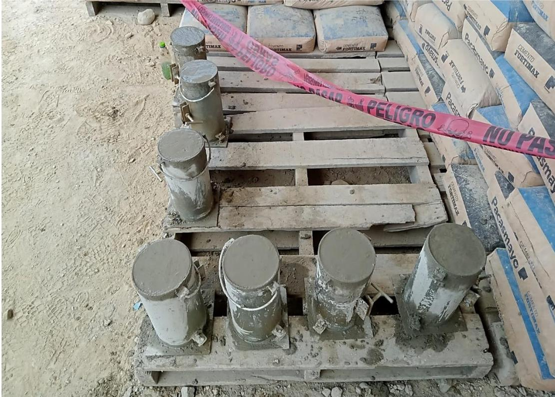
**Foto 17.** Primer grupo de probetas con concreto  $F'c=280 \text{ Kg/cm}^2$
