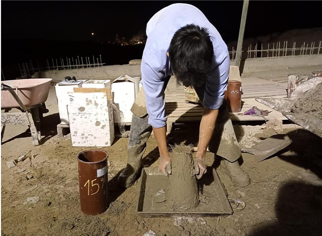
**Foto 9.** Desplazamiento vertical del cono de Abrams
