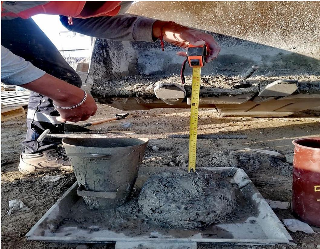
**Foto 10.** Medición del asentamiento del concreto  $F'c=280 \text{ Kg/cm}^2 + 5\%$  de fibras de polipropileno
