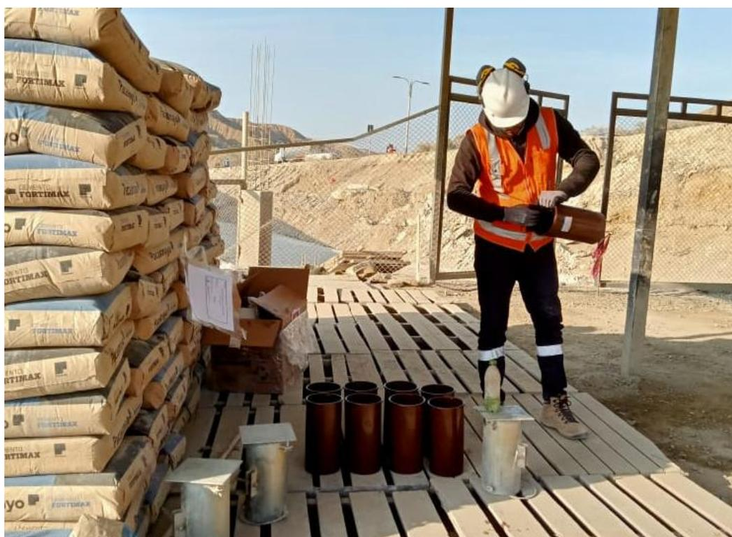
**Foto 12.** Aplicación de desmoldante en la parte interna de las probetas
