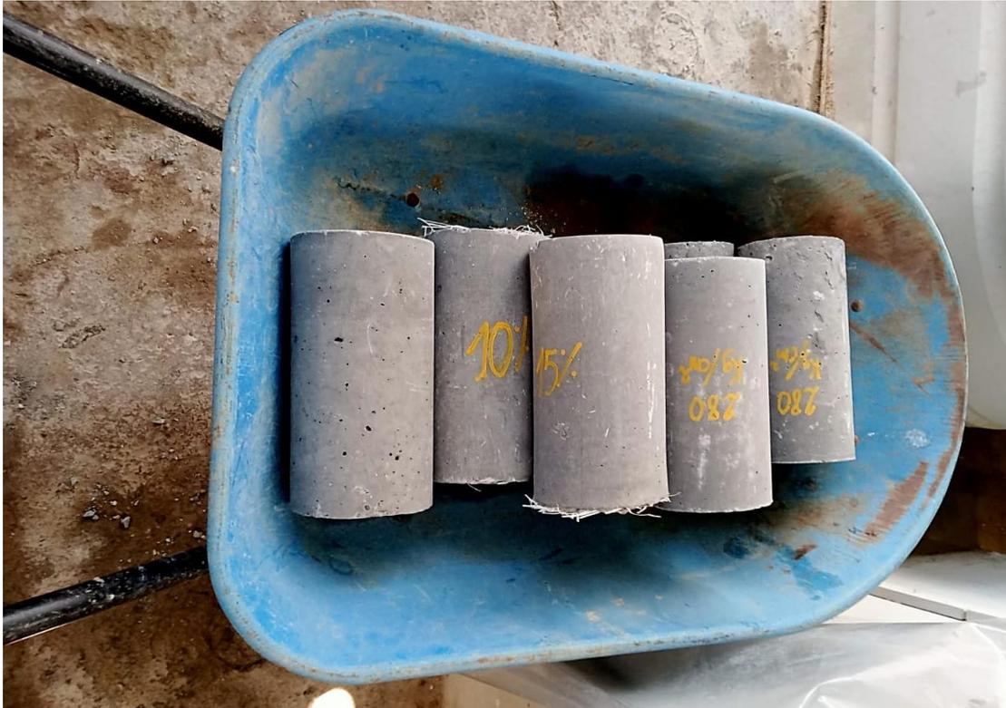
**Foto 29.** Grupo de probetas previo al ensayo de la resistencia a la compresión
