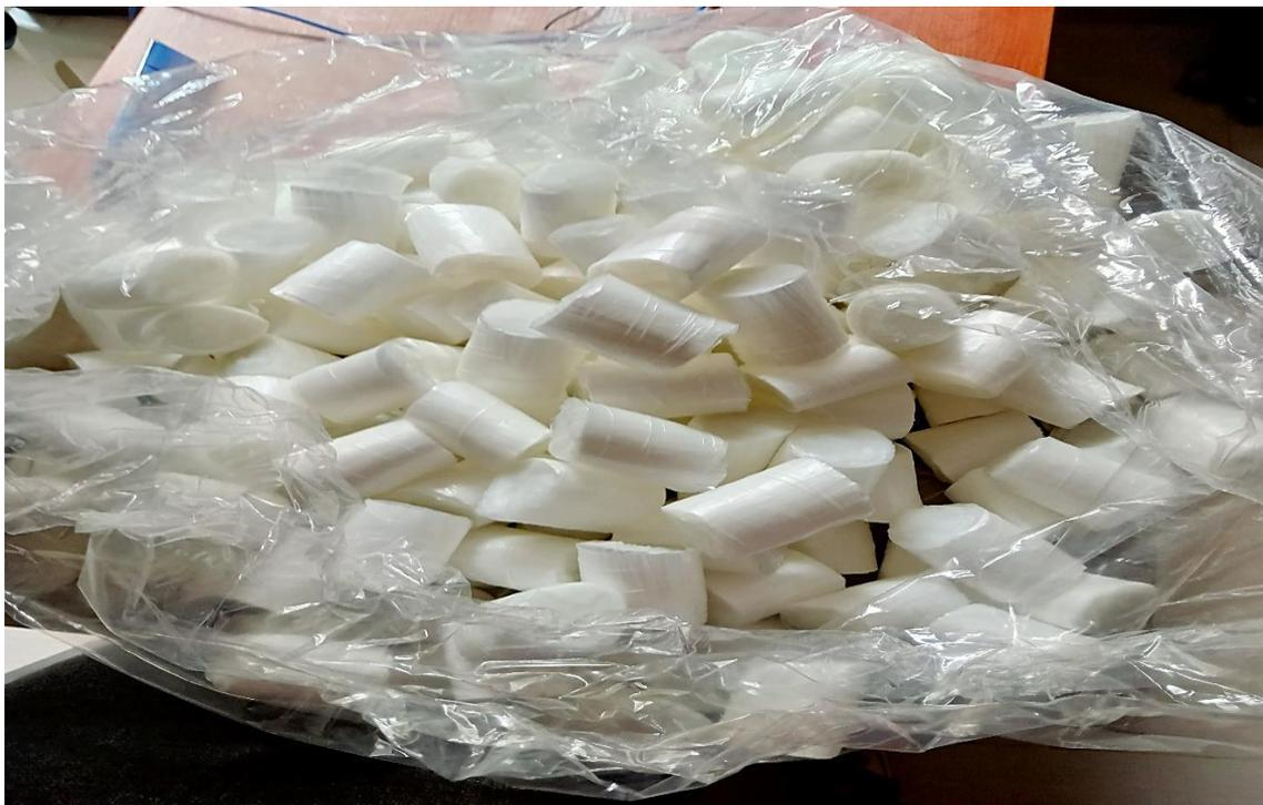
**Foto 2.** Fibra de polipropileno “Fibermesh-650 S” de la marca Sika®
