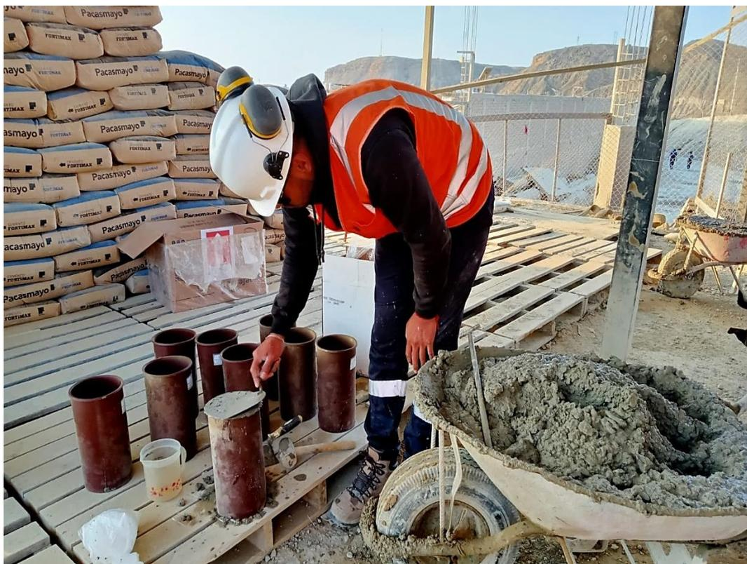
**Foto 16.** Enrasado de probeta
