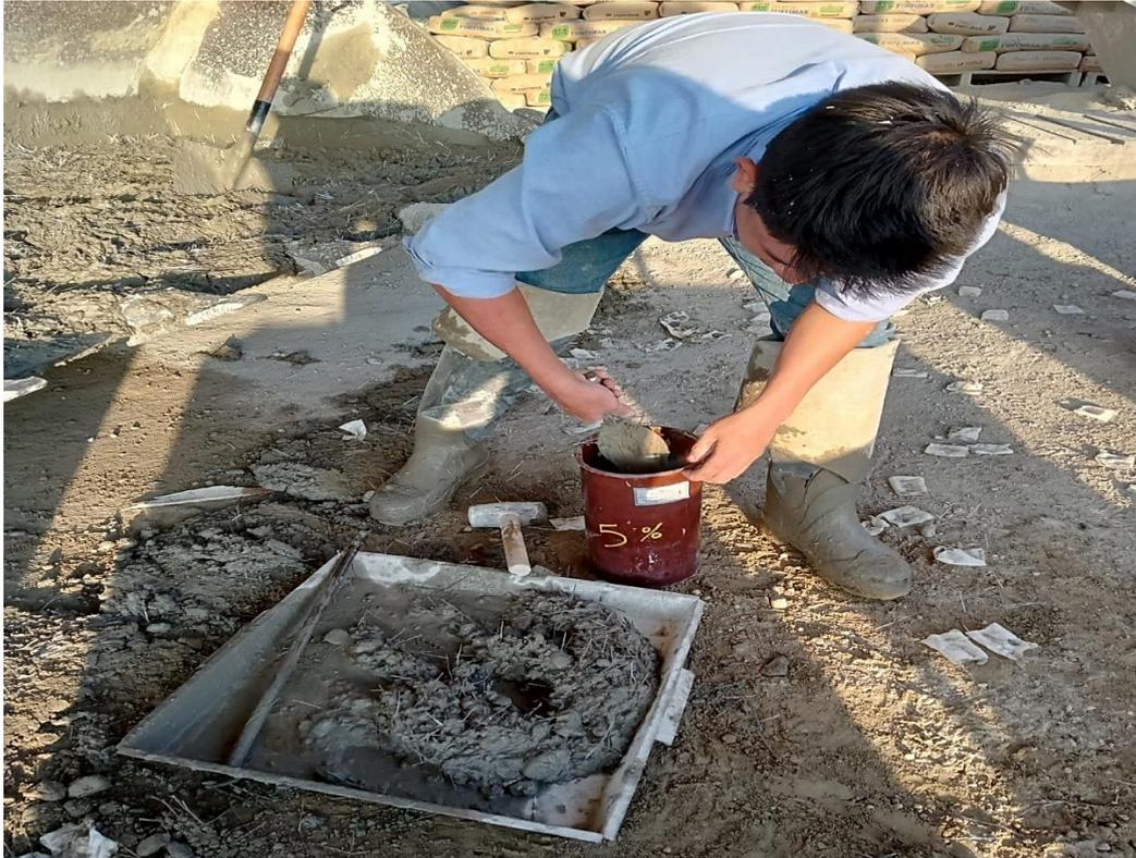
**Foto 13.** Llenado de probeta plástica con concreto  $F'c=280 \text{ Kg/cm}^2$  + 5% de fibras de polipropileno en tres capas respectivamente
