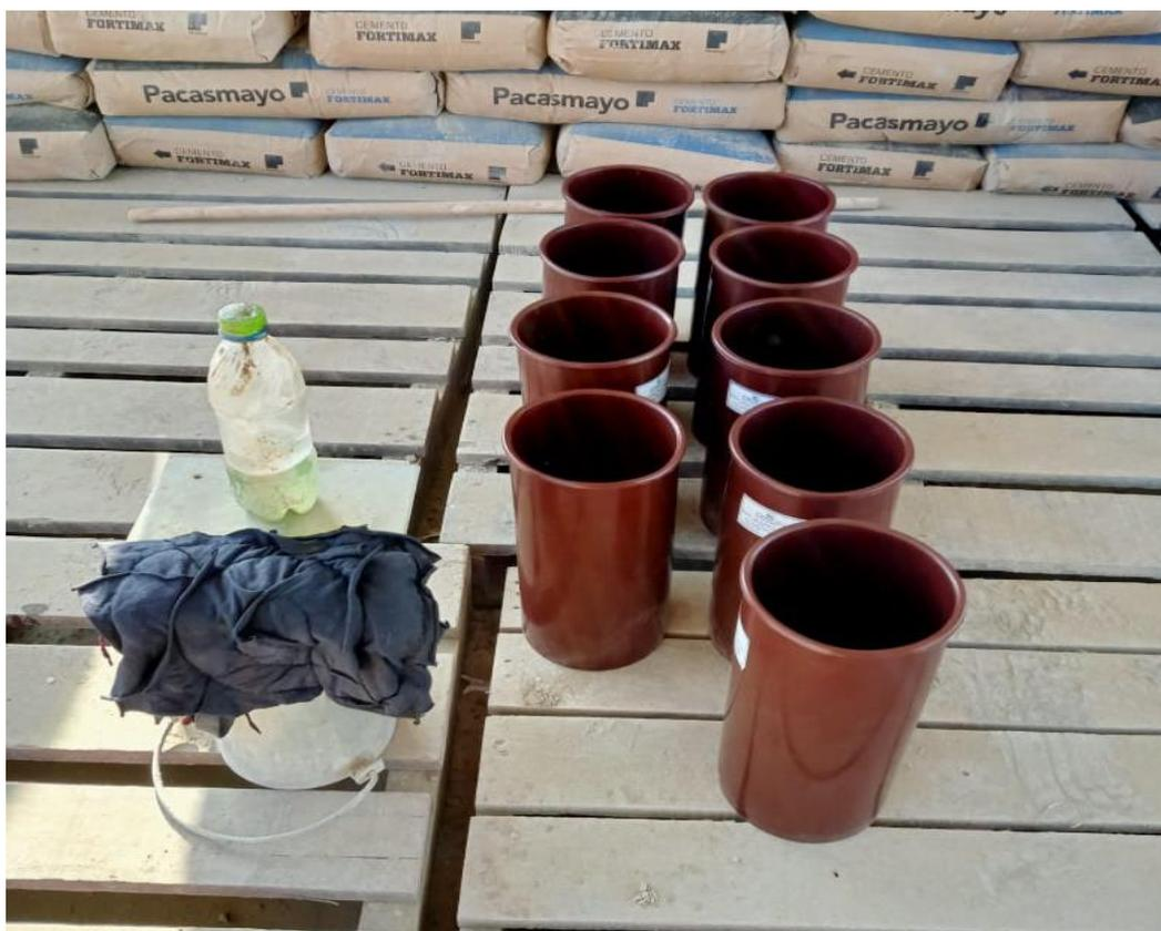
**Foto 11.** Probetas plásticas para concreto
