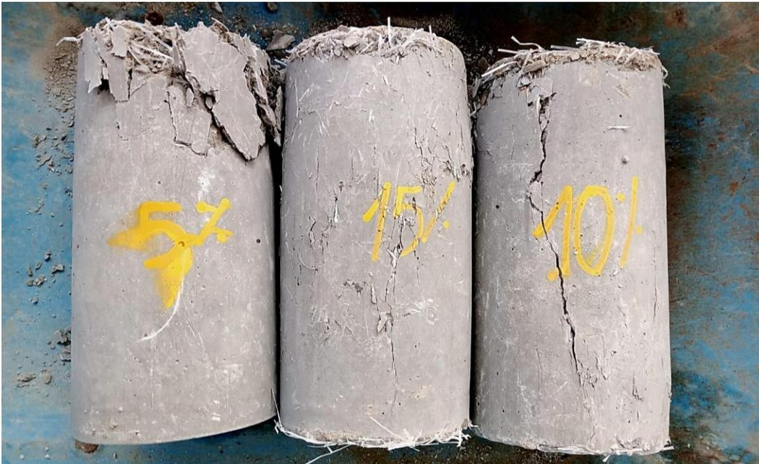
**Foto 32.** Probetas de concreto (con adición del 5%, 10% y 15% de fibra de polipropileno) ensayadas a compresión
