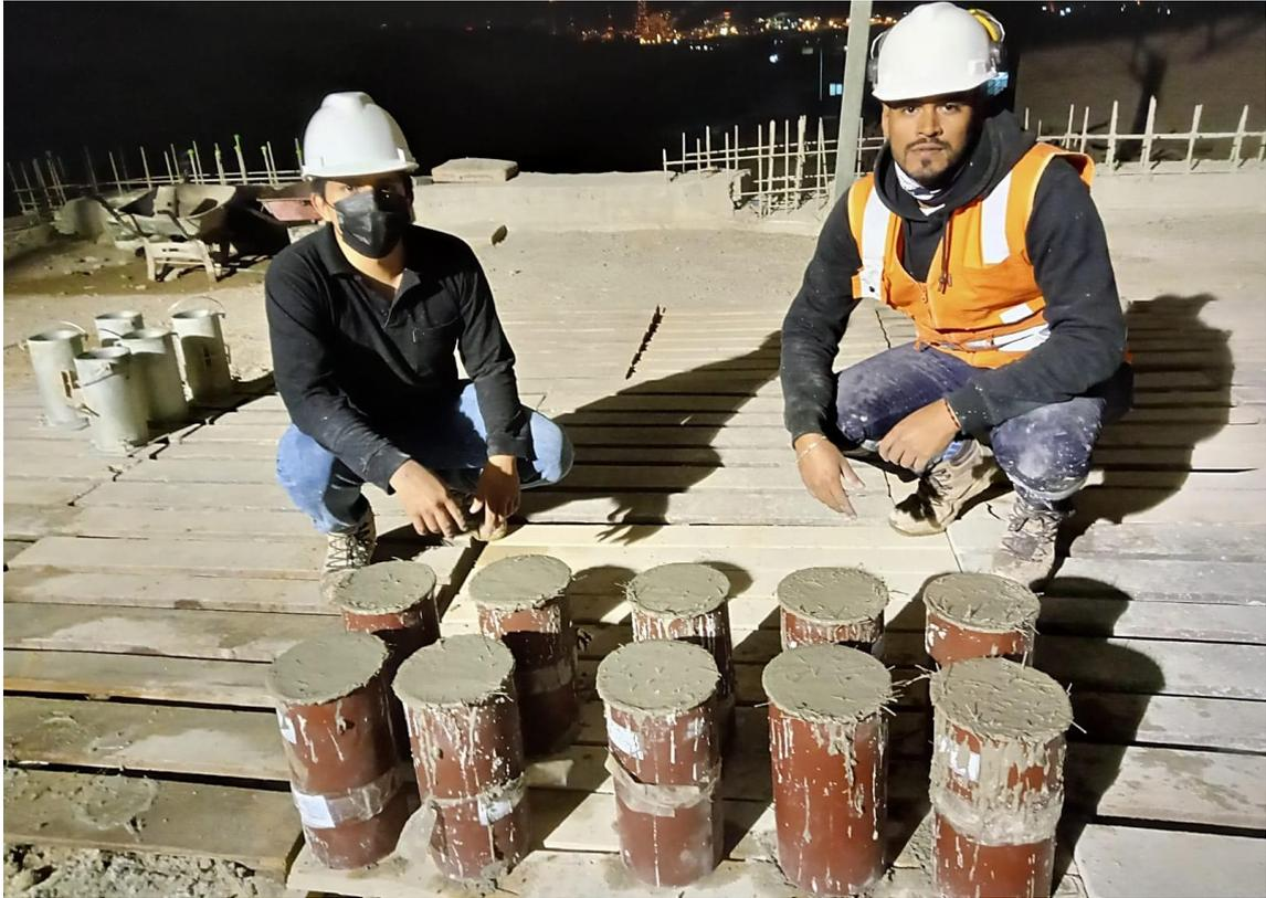
**Foto 19.** Tercer grupo de probetas con concreto  $F'c=280 \text{ Kg/cm}^2$  + fibra de polipropileno
