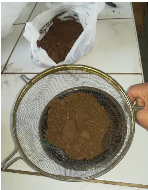
a) Tamizado de la muestra con diámetro de 2 mm para extraer la cantidad de arena
