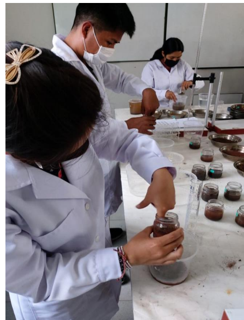
b) Lavado de las muestras para extraer la cantidad de arcilla y limo
