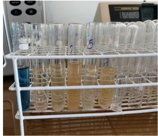
b) Reactivo de solución acida (5 gotas), molibdato de amonio (5 gotas) y ácido ascórbico (1 pisca) se agregan a las muestras centrifugadas
