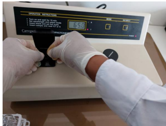
c) Medición de fosfatos en el espectrofotómetro
