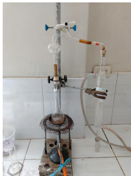
b) Destilación de la muestra por 3 horas aproximadamente.
