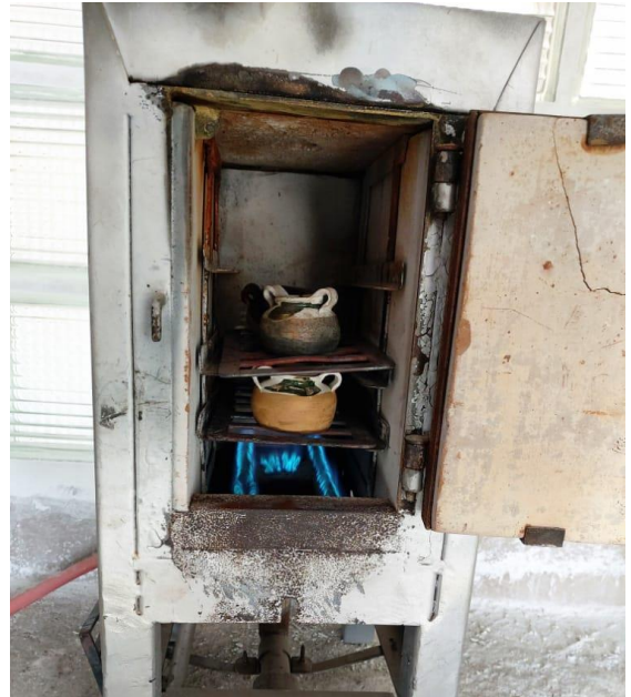
a) Calcinador, eliminación de carbón en aproximadamente 6 horas
