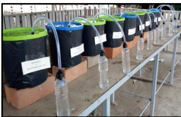
Figura 26 : Elaboración de biodigestores tipo batch artesanales
