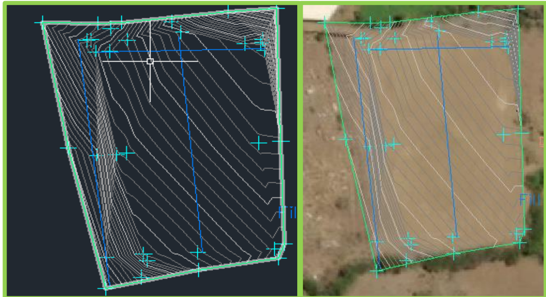
FIGURAS 3. Curvas de nivel procesada en el programa Civil 3D.
