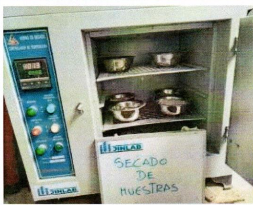
ENSAYOS DE CONTENIDO DE HUMEDAD
