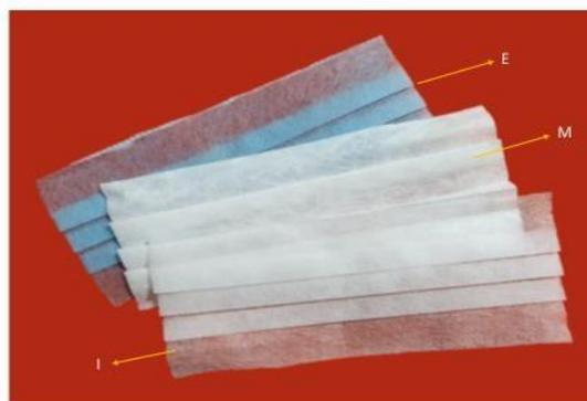
**Figura N° 1.** Capas de mascarilla quirúrgica. Capa exterior (E), capa intermedia (M) y capa interna (I).
