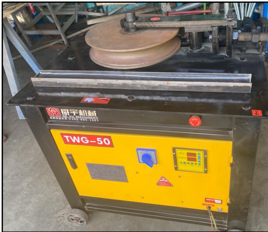
Figura 9. Máquina dobladora de tubos de acero automática
