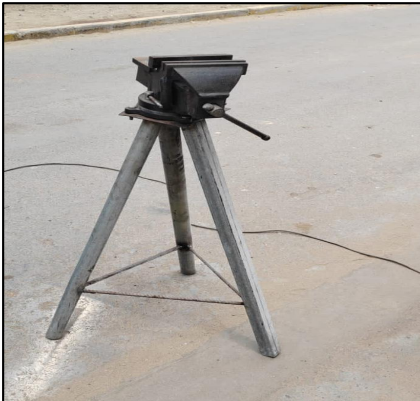
Figura 11. Máquina manual dobladora de tubos de acero
