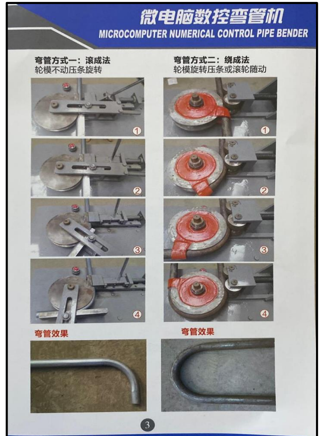
Figura 11. Máquina manual dobladora de tubos de acero
