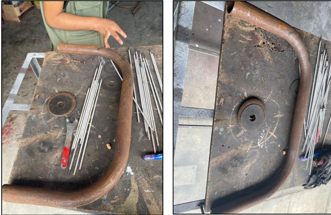
Figura 12. Piezas elaboradas con la nueva dobladora automática
