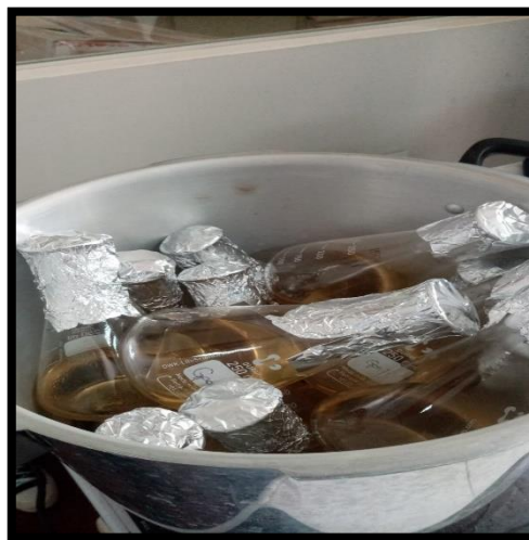
Acondicionamiento y esterilización de los Biorreactores
