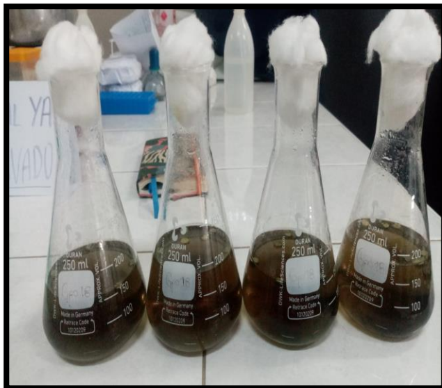
Se colocó en el agitación Shaker a 130 RPM los biorreactores
