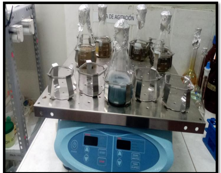
Se colocó en el agitación Shaker a 130 RPM los biorreactores
