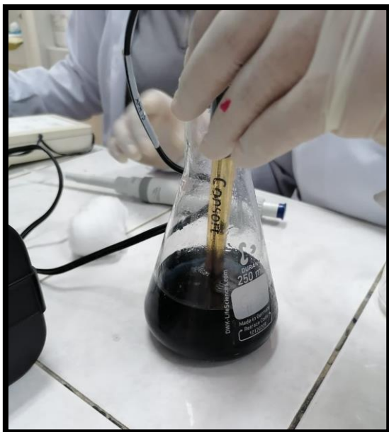
Acondicionamiento de pH alcalino con Hidróxido de sodio
