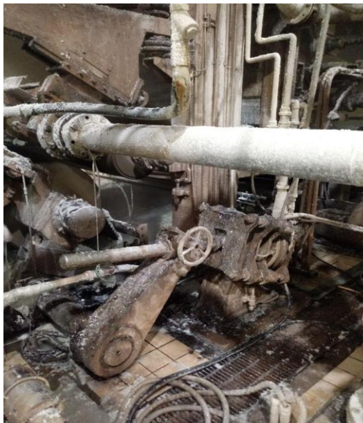
Figura 15: Etapa de formación de máquina de papel
