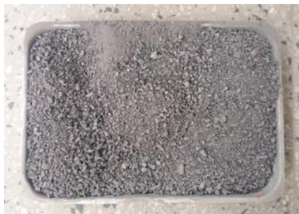
Figura 20. Escorias de acero en tamaño de aditivo
