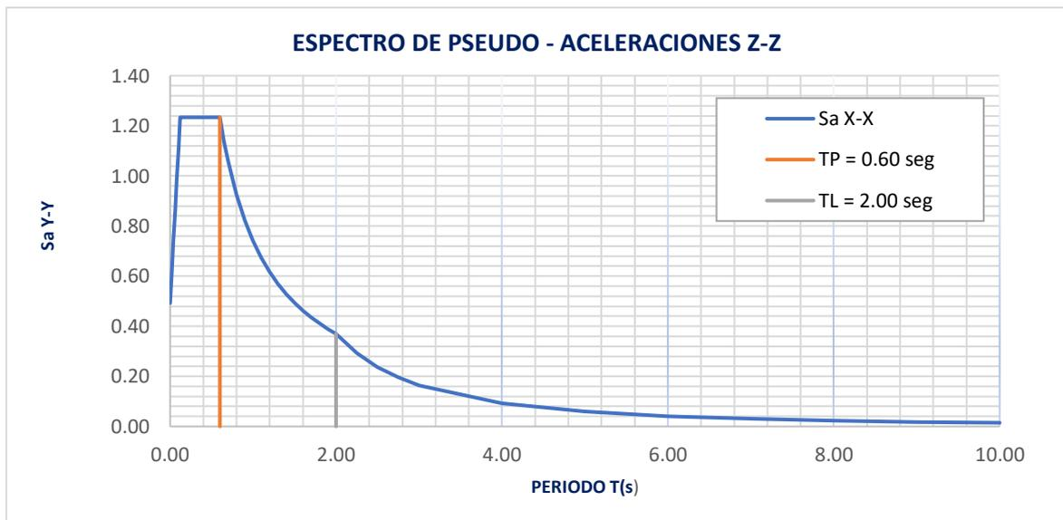
Según los datos obtenidos en párrafos predecesoras, estos datos son insertados en los programas de cálculo estructural. En el software Robot Structural se insertó datos obtenidos de los espectros de aceleraciones en las direcciones X, Y y Z, ya que el programa Robot, solicita estos datos para hacer el análisis estructural dinámico, como se muestra en la siguiente imagen:
