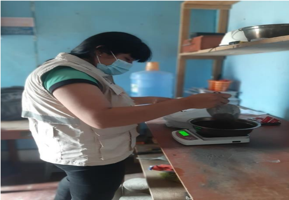
Figura 10. Pesado de la muestra para ensayo de análisis granulométrico.
