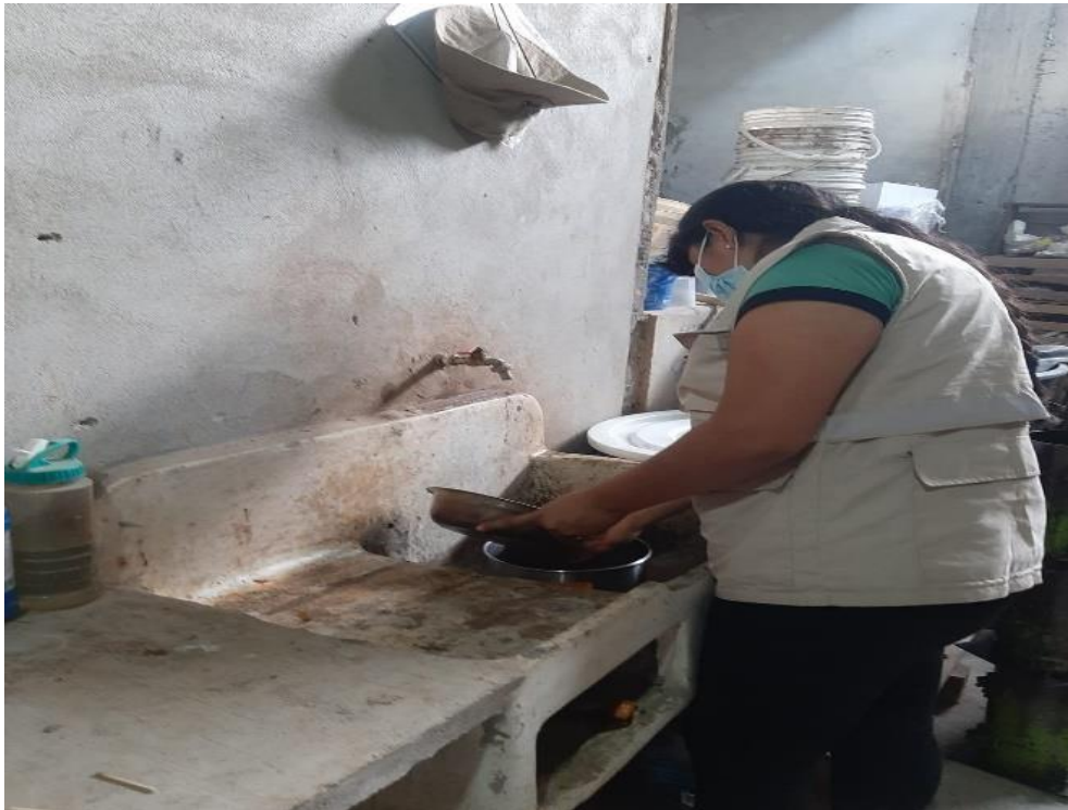
Figura 11. Procedimiento de lavado de la muestra de suelo patrón.
