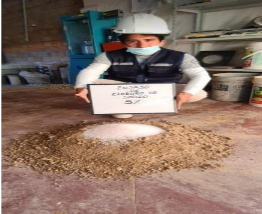
Figura 16. Adición de 5% de cloruro de sodio a muestreo de material.
