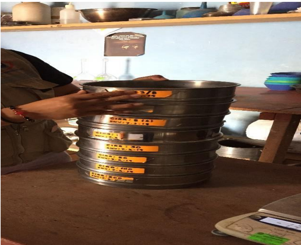
Figura 13. Realización del ensayo de análisis granulométrico
