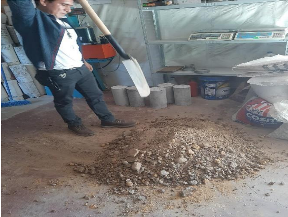
Figura 14. Adición de 0% de cloruro de sodio a muestreo de material.
