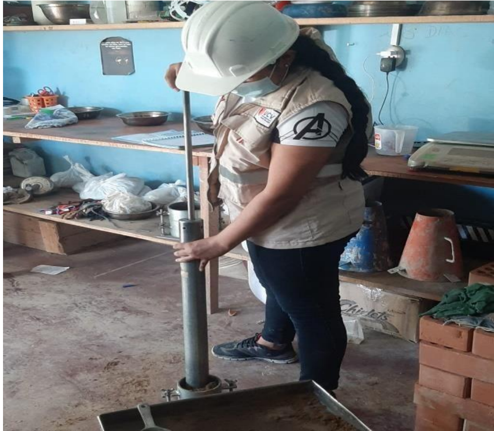
Figura 20. Ensayo de compactación (Proctor modificado)
