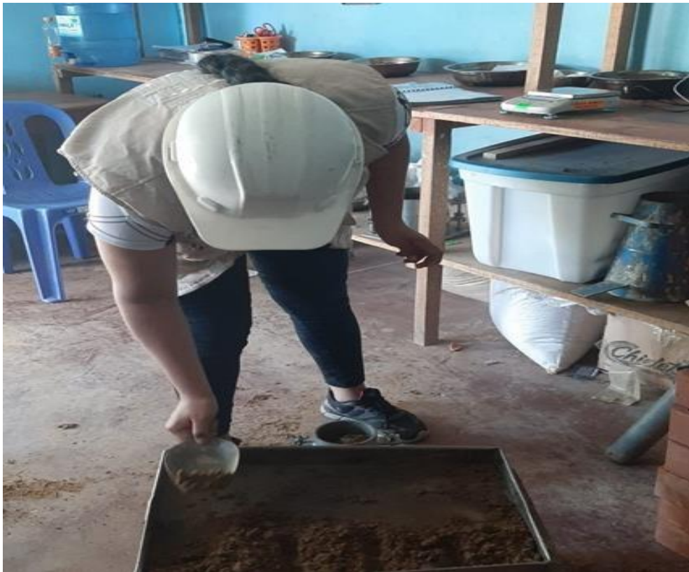
Figura 19. Llenado de la muestra al molde de Proctor modificado.
