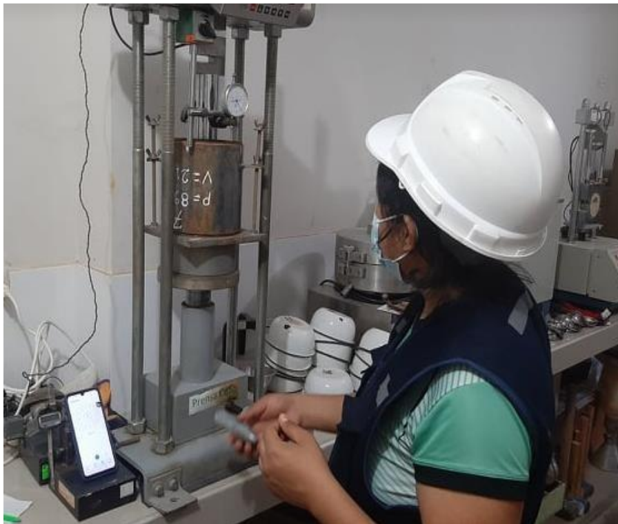
Figura 25. Realizando el ensayo de penetración en la prensa de CBR.
