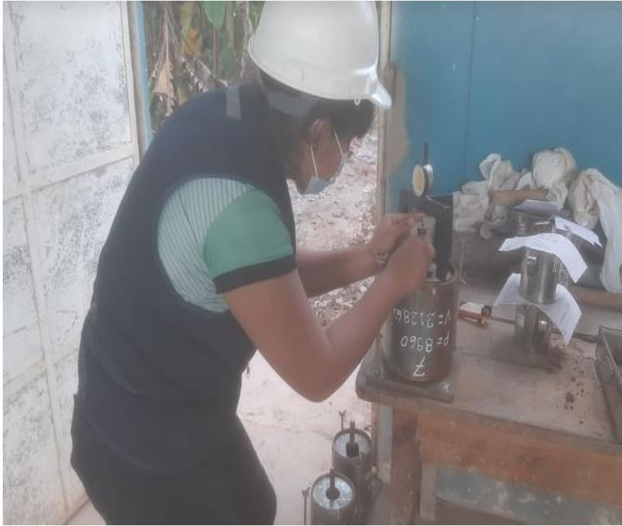
Figura 24. Realizando ensayo de CBR
