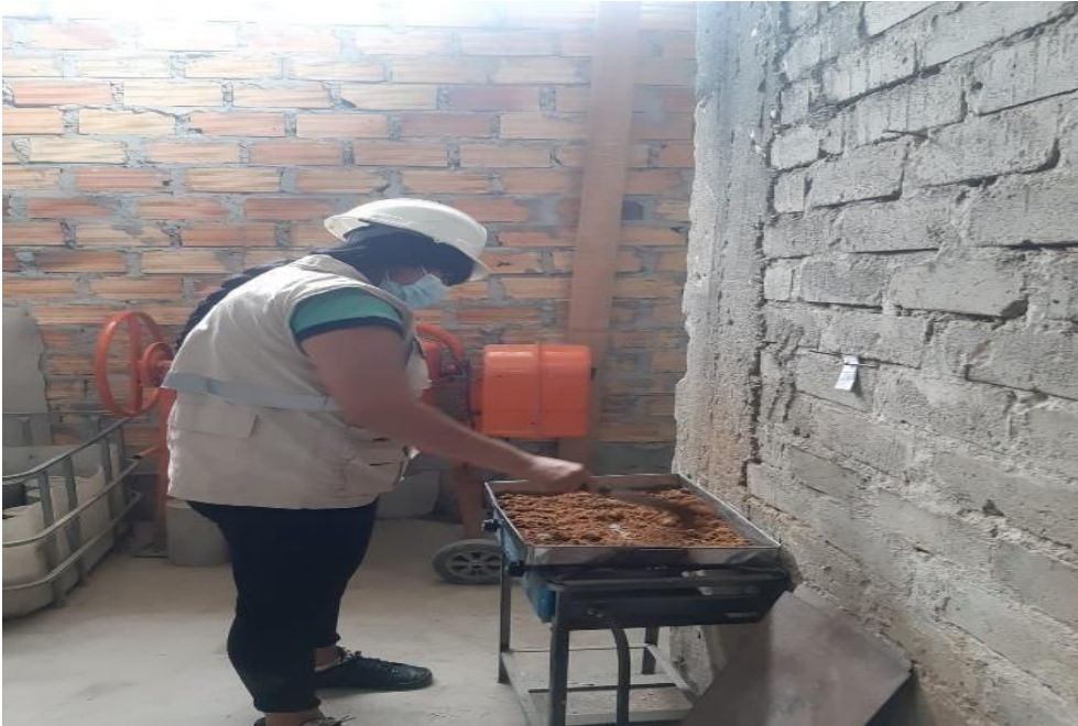
Figura 12. Procedimiento de secado de la muestra de suelo patrón.
