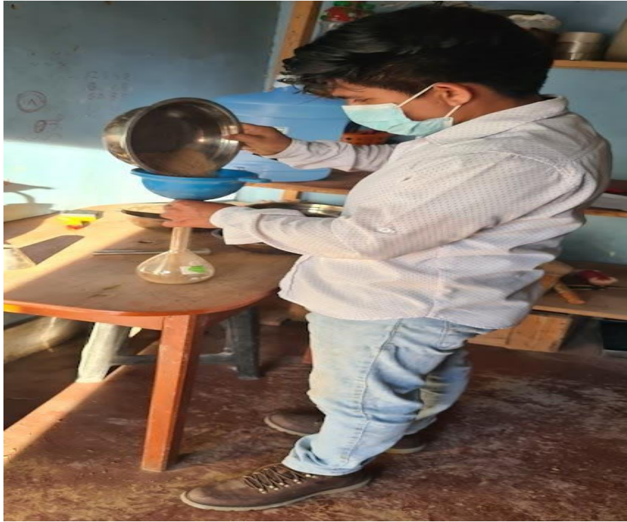
Figura 22. Llenado de la Fiola para realizar peso específico.
