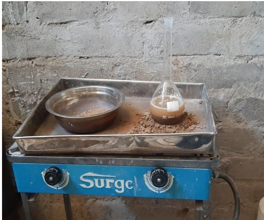
Figura 23. Se está realizando ensayo de peso específico.
