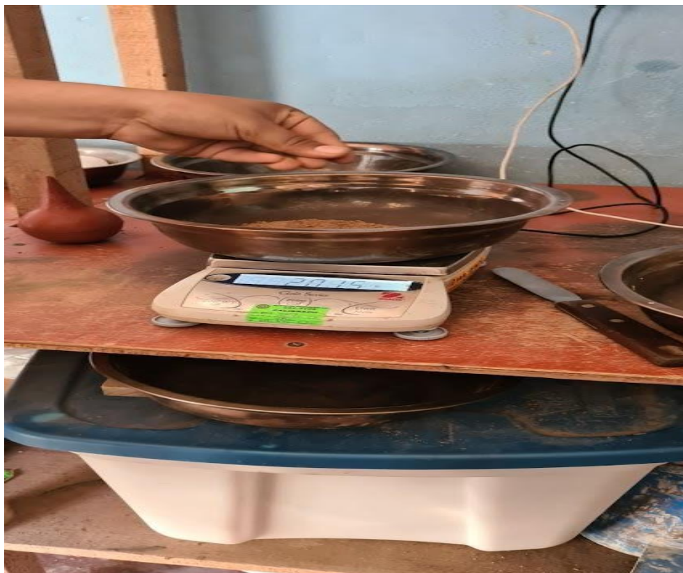
Figura 21. Se está realizando el pesado de la muestra para peso específico.
