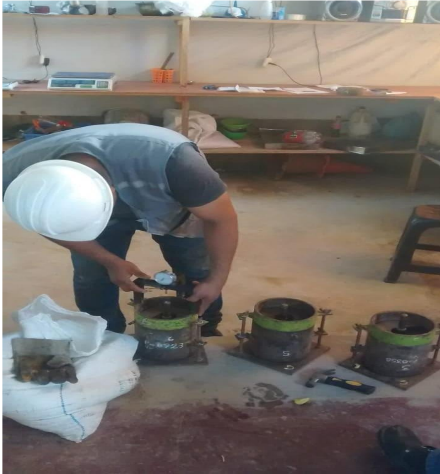
Figura 26. Realizando la lectura de expansión antes de la inmersión en agua.
