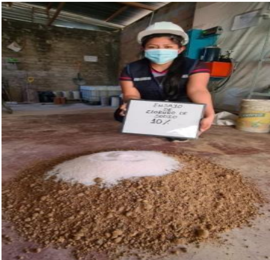
Figura 17. Adición de 10% de cloruro de sodio a muestreo de material.
