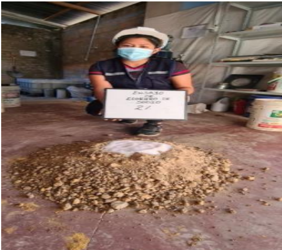
Figura 15. Adición de 2% de cloruro de sodio a muestreo de material.
