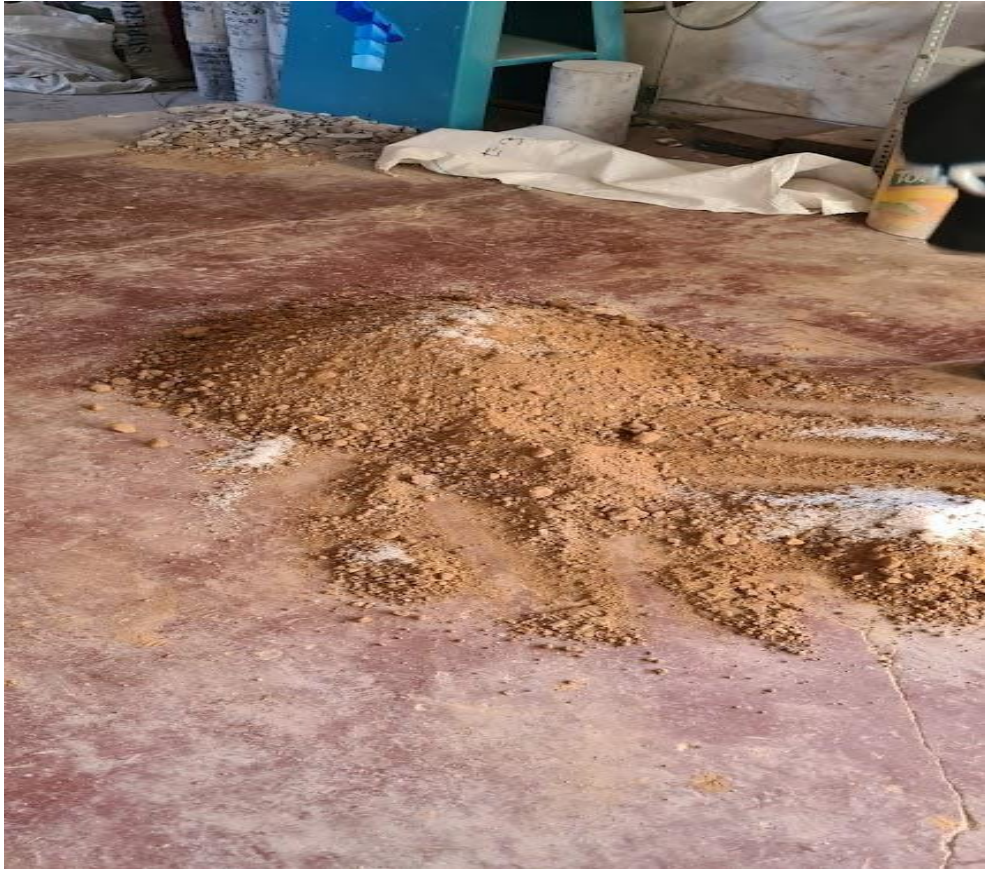
Figura 18. Proceso de combinación del material con el cloruro de sodio.
