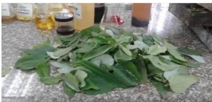
Los aceites de *Eucalyptus globulus* L. "Eucalipto" se obtuvieron por el método de destilación por arrastre de vapor; para ello, se se colocaron las hojas en el matraz de destilación, se le adiciono 200 ml de agua destilada, se calentó hasta la ebullición y el aceite extraído fue arrastrado junto con el vapor de agua hacia un condensador, permaneció así por 15 minutos. Después se colocó en un frasco de vidrio ámbar estéril y se reservó a temperatura de refrigeración hasta su utilización.
