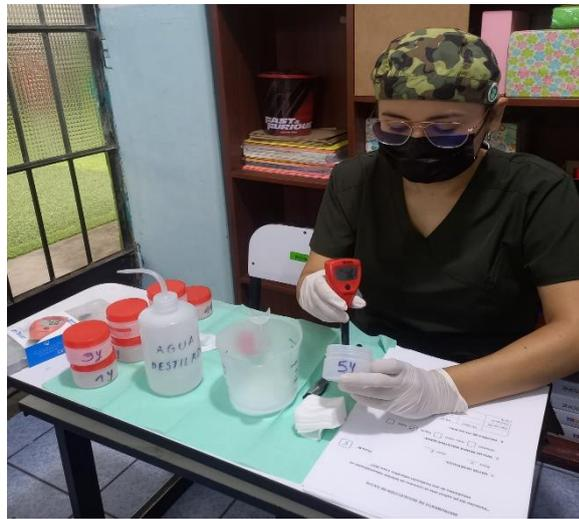
Medición de las muestras con el pHmetro digital
