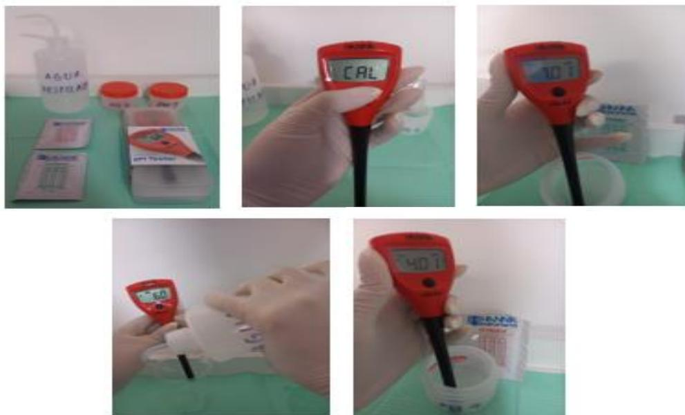
Calibración del pHmetro digital
