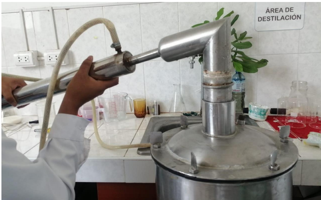
Fig. 3. Preparación del equipo de destilación para arrastre de vapor para extraer los aceites esenciales de Rosmarinus officinalis .
