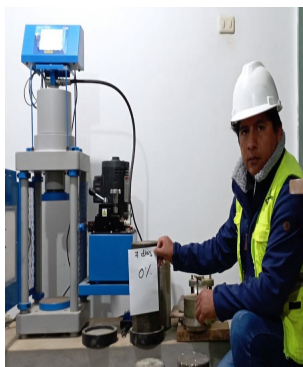
Foto 6. Ensayo con perlas de tecnopor (10%,20% y 30%)
