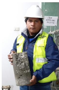
Foto 6. Ensayo con perlas de tecnopor (10%,20% y 30%)
