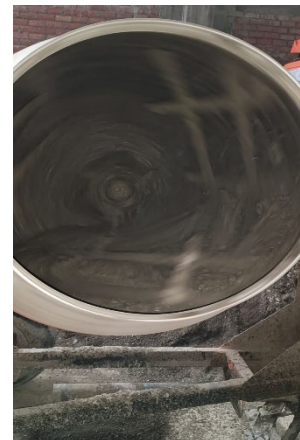
Foto3. Elaboración del concreto patrón más los porcentajes de sustitución del agregado fino por las perlas de tecnopor (0%, 10%, 20% y 30%)
