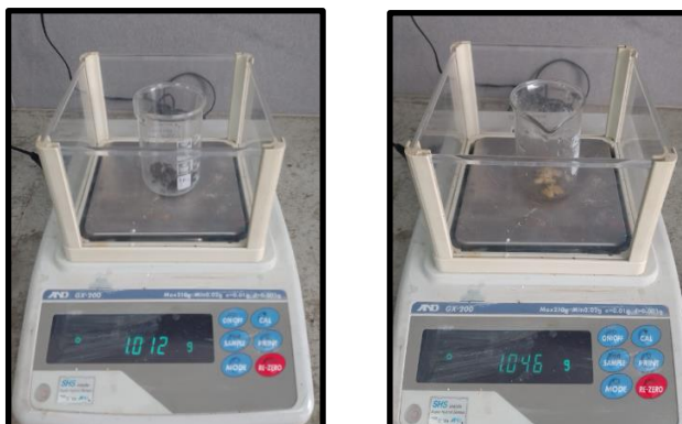
Figura 21. Peso de las muestras para determinación de lignina
