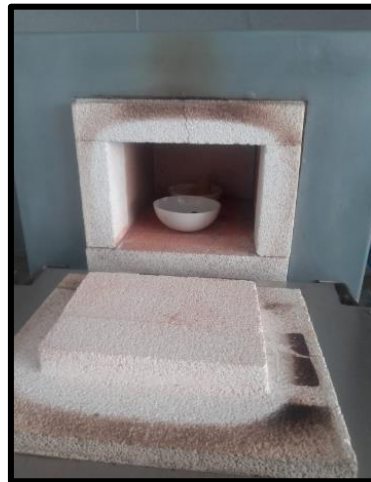
Figura 8: Mufla a 550° C con las muestras carbonizadas
