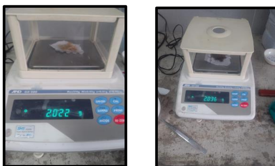
Figura 10: Peso de muestras para la determinación de holocelulosa
