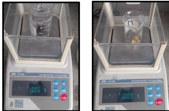
Figura 15. Pesos de las muestras para determinación de celulosa
