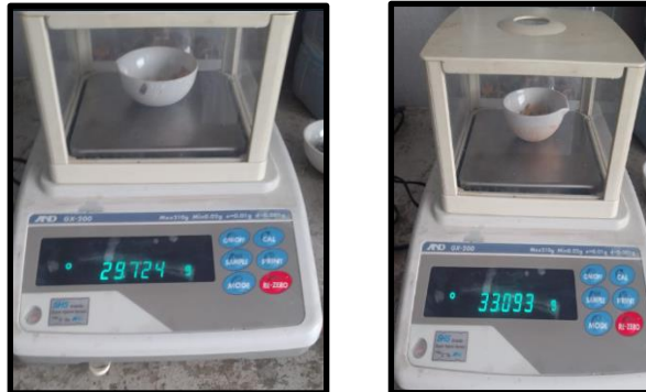
Figura 14: Pesos finales de las muestras para holocelulosa
