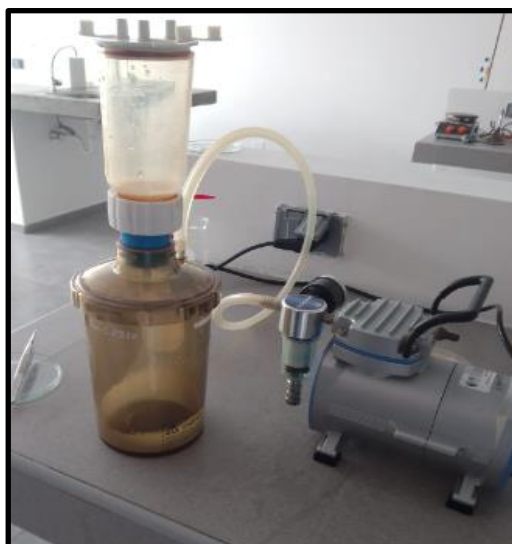
Figura 24. Sistema de filtración
