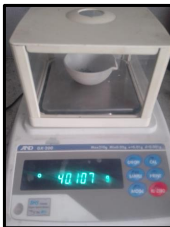
Figura 9: Peso final de cenizas
