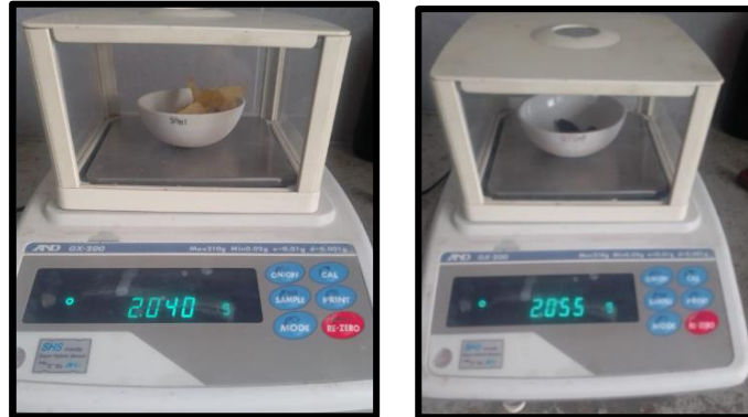
Figura 7: Peso de las muestras para cenizas
