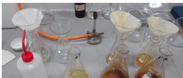
Figura 13: Filtrado de las muestras para determinación de holocelulosa
