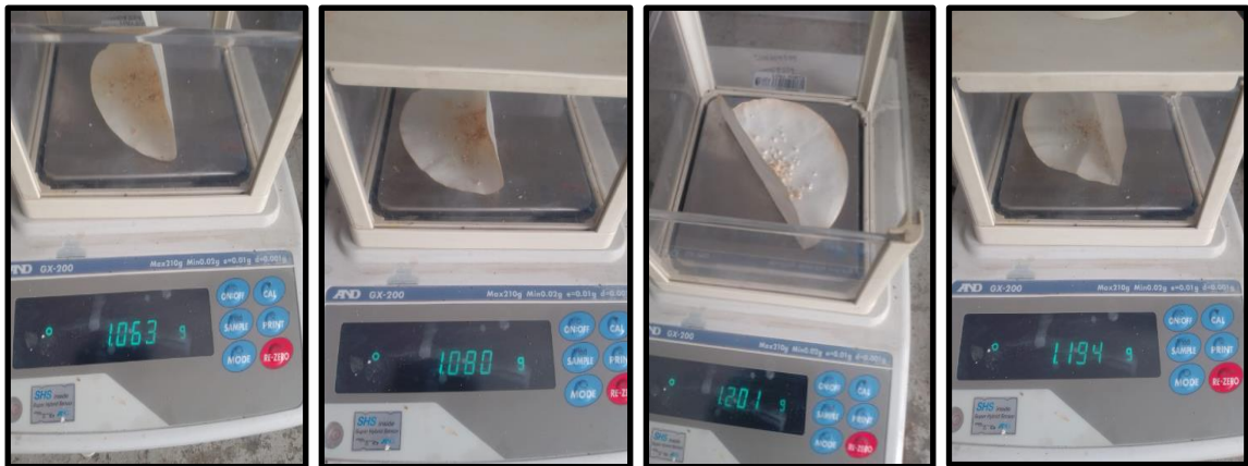
Figura 20. Peso final de las muestras para determinación de celulosa
