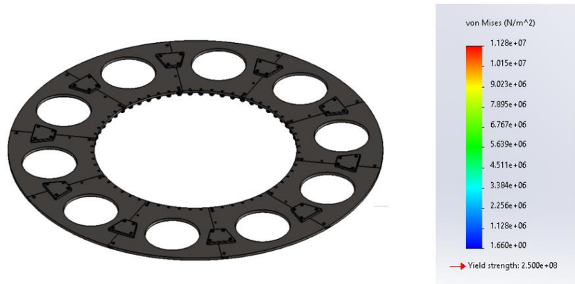
Figura 62. Disco sin carga aplicada simulado en SolidWorks
