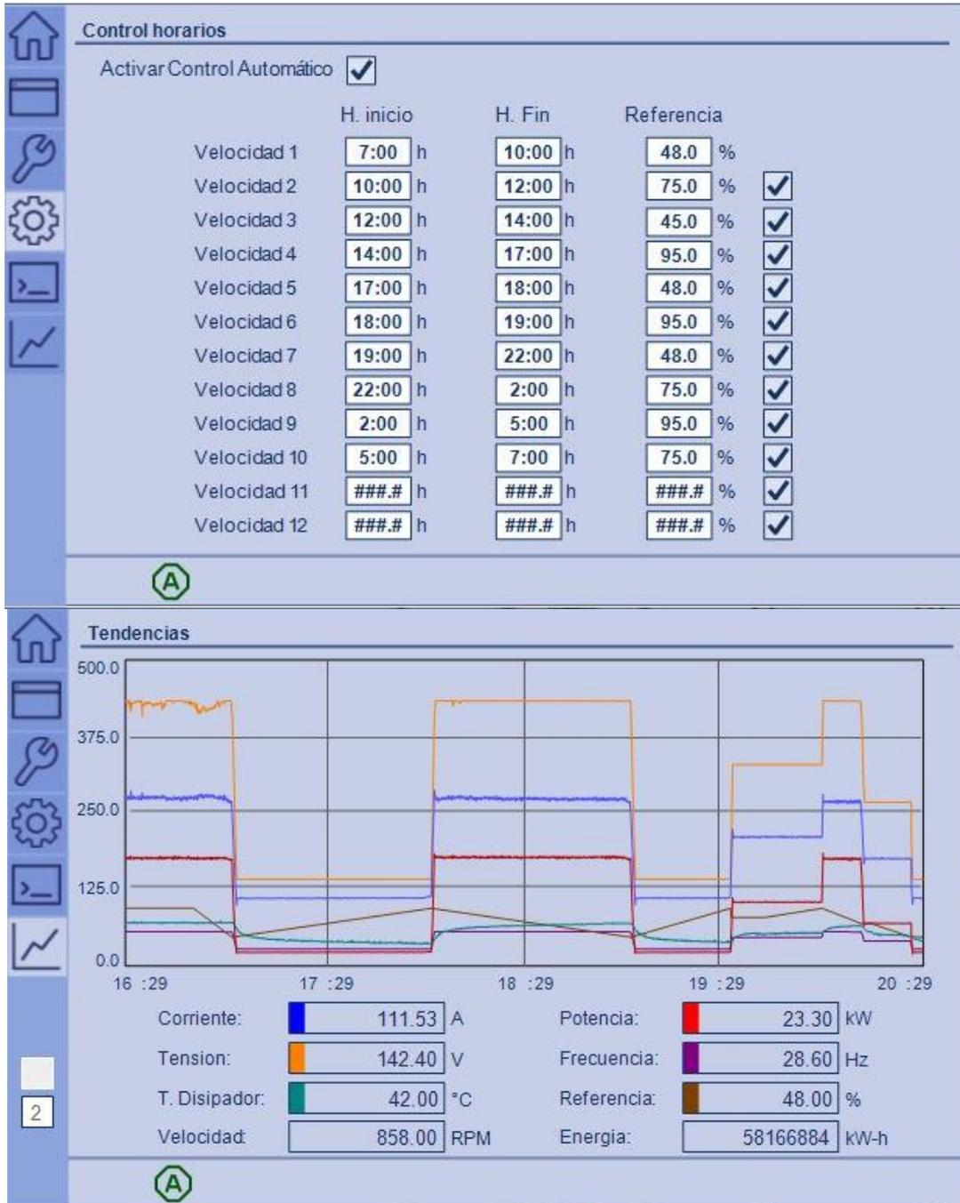
Figura 22. Diagrama de funcionamiento desde el scada.
