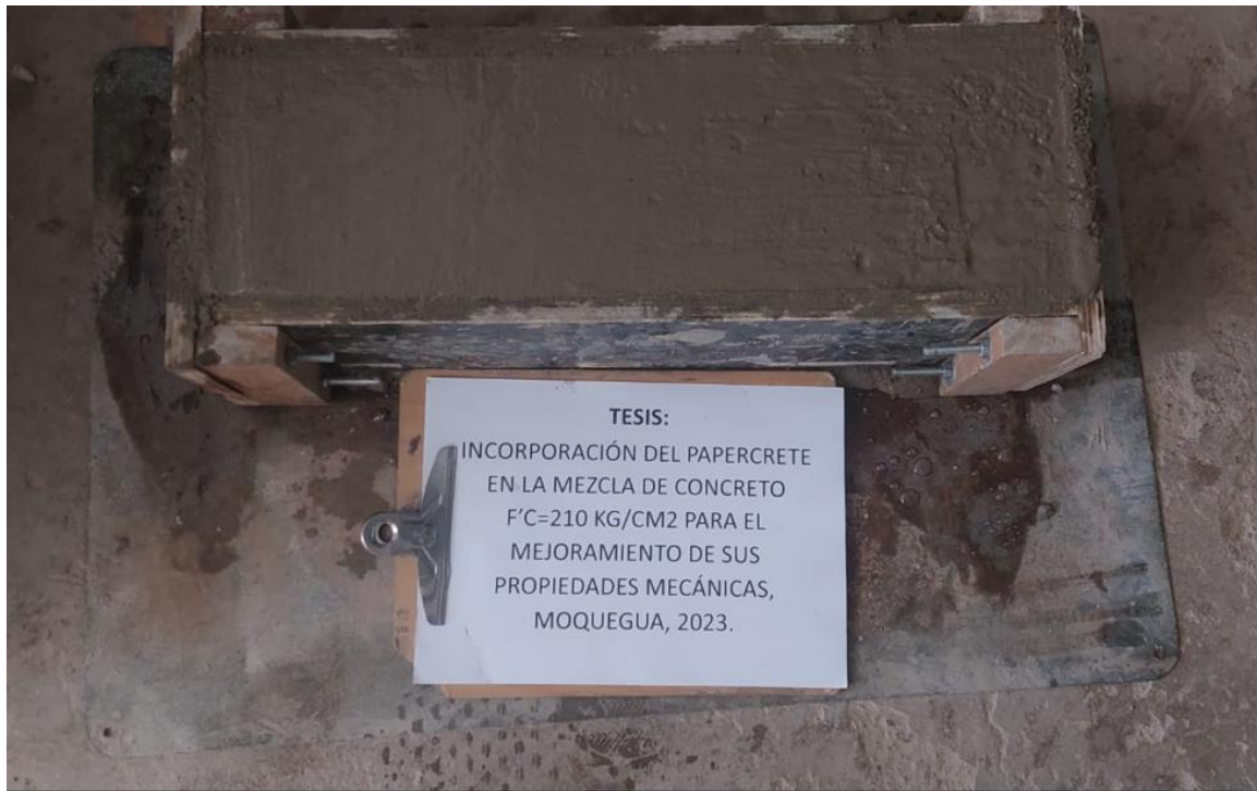
Figura 34. Obtención de muestras para el ensayo de flexión concreto patrón
