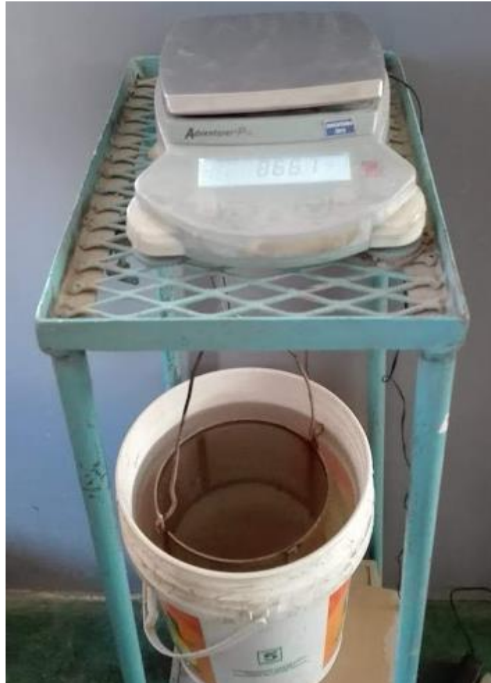
Figura 18. Ensayo de gravedad específica
