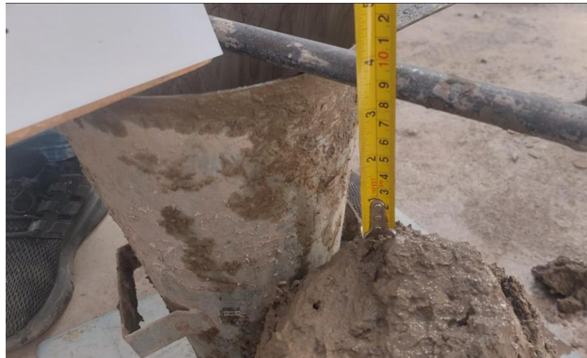
Figura 21. Slump de concreto patrón.
