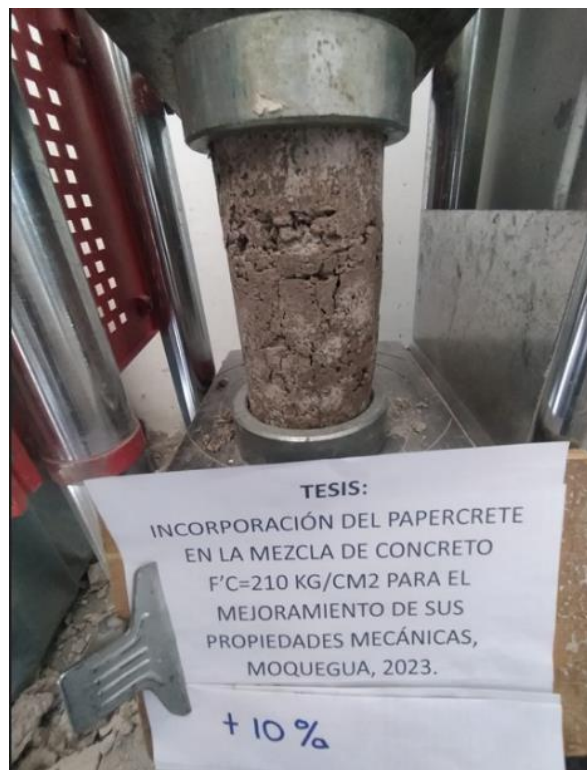
Figura 32. Ensayo de Compresión de concreto + 10% papercrete
