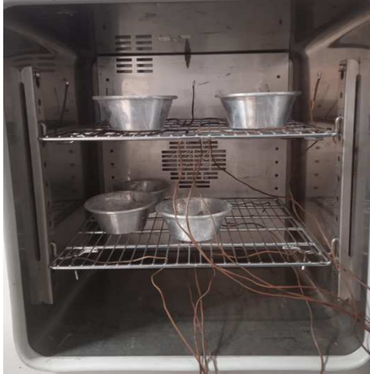
Fotografía mostrando la ubicación de los sensores de temperatura y de las cargas en el medio isoterma
