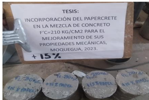
Figura 28. Obtención de muestras para el ensayo de Resistencia a la compresión ( Concreto + 15% papercrete)
