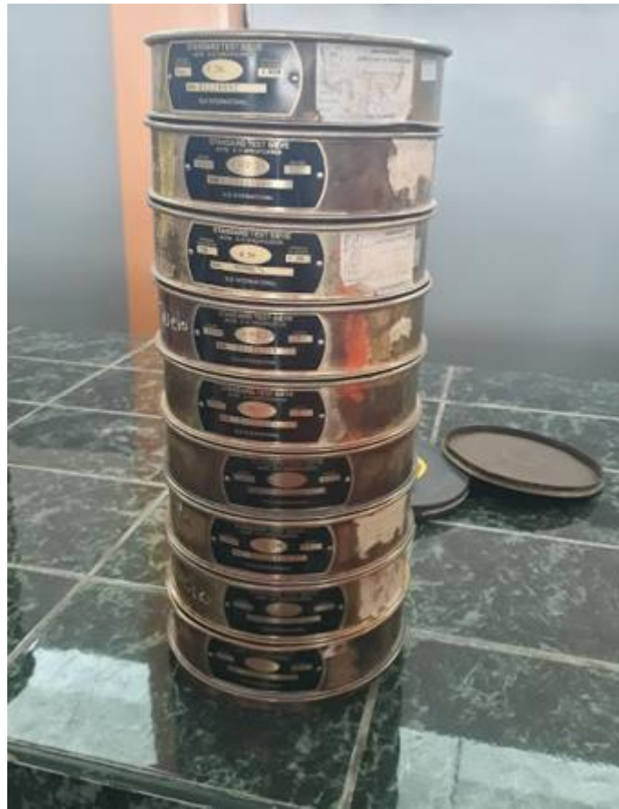
Figura 10. Juego de mallas de tamices, para el ensayo de granulometría
