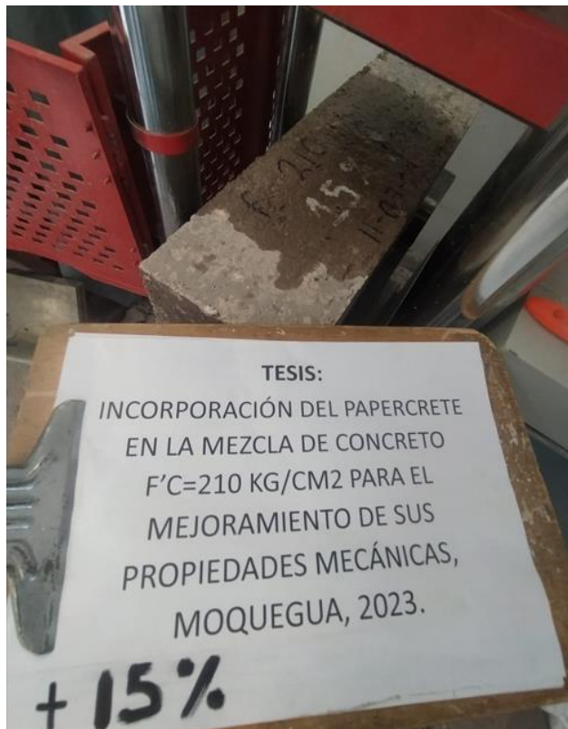
Figura 36. Obtención de muestras para el ensayo de flexión concreto+15% papercrete
