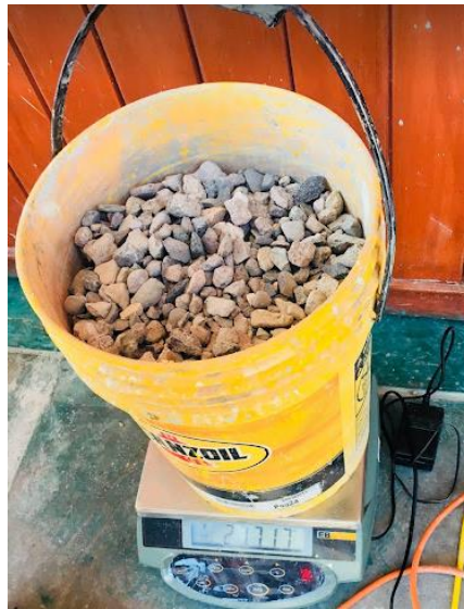
Figura 14. Muestra representativa de agregado grueso
