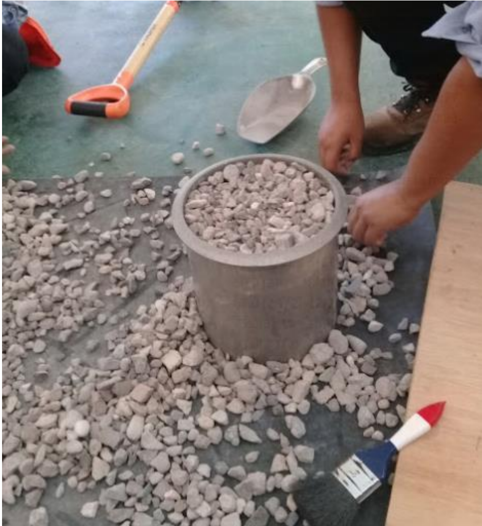
Figura 17. Ensayo de peso unitario
