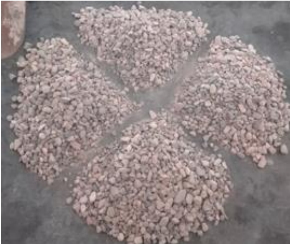
Figura 11. Cuarteo de agregado grueso
