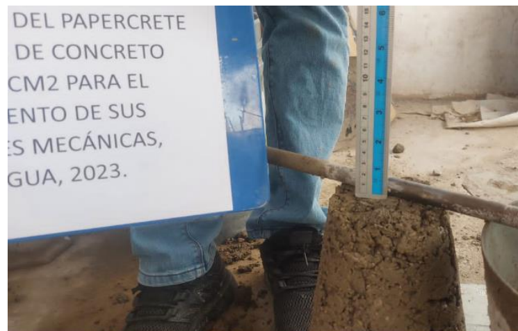
Figura 22. Slump de concreto+ 10% de papercrete
