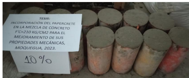
Figura 29. Obtención de muestras para el ensayo de Resistencia a la compresión (Concreto + 10% papercrete)
