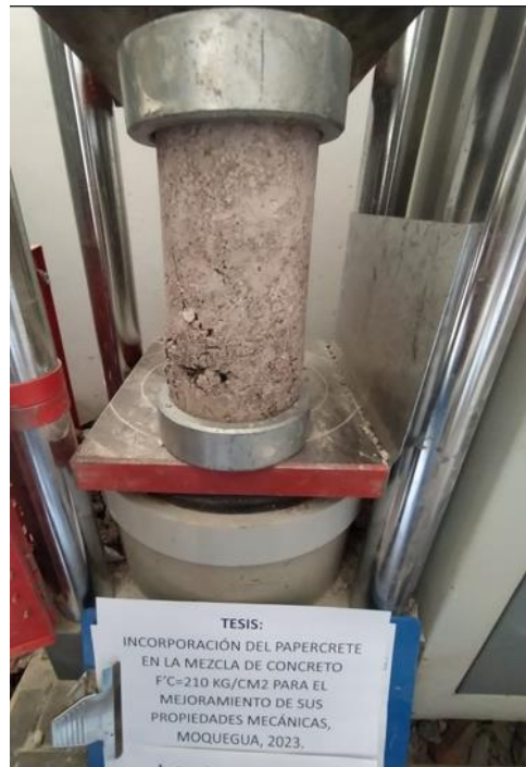
Figura 31. Ensayo de Compresión de concreto patrón
