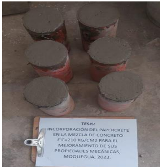
Figura 27. Obtención de muestras para el ensayo de Resistencia a la compresión ( Concreto patrón)
