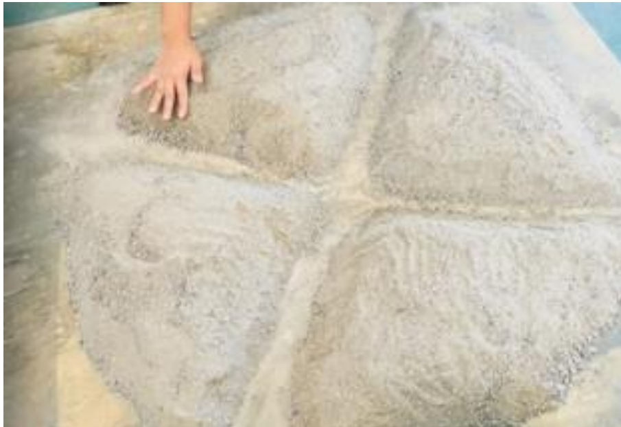
Figura 12. Cuarteo de agregado fino
