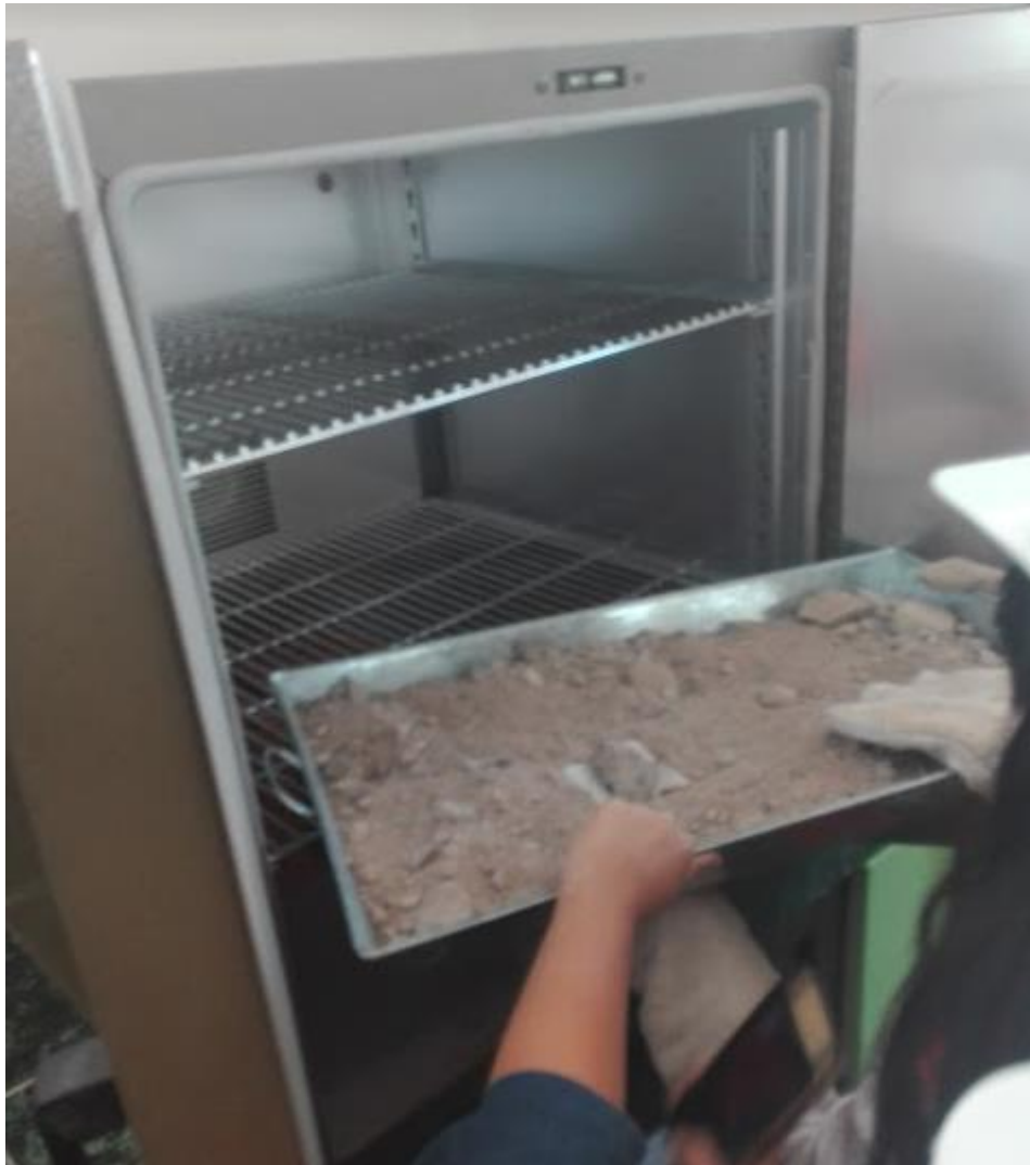
Figura 16. Colocación de muestras al horno.
