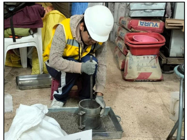
Imagen 29. Peso unitario compactado del agregado fino.
