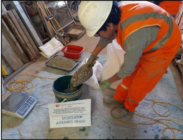
Imagen 36. Dosificación de agregado grueso.
