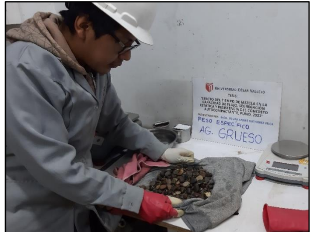
Imagen 14. Secado superficial de muestra de agregado grueso.
