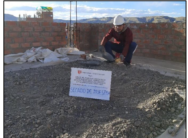
Imagen 02. Secado del agregado al aire libre.
