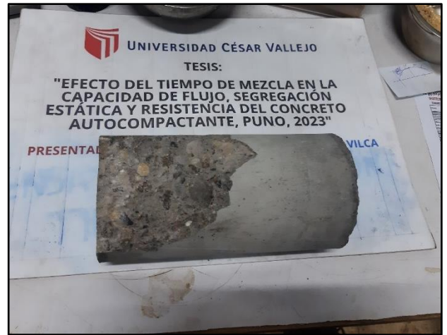
Imagen 69. Tipo de falla cónica en un extremo sin grieta vertical.
