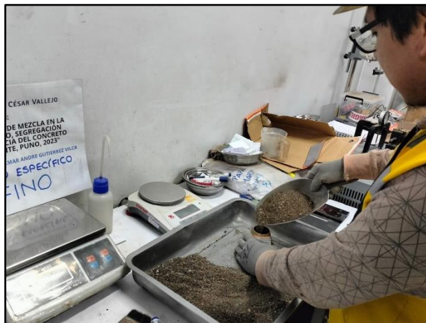
Imagen 09. Prueba de cono de absorción y pisón.
