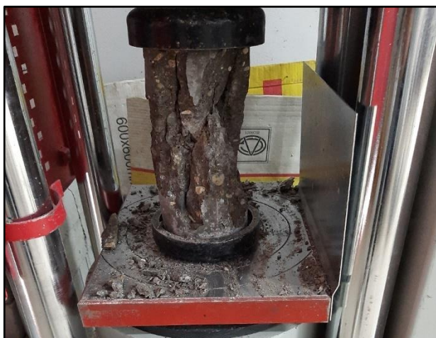
Imagen 70. Falla de agrietamiento vertical en ambos extremos.
