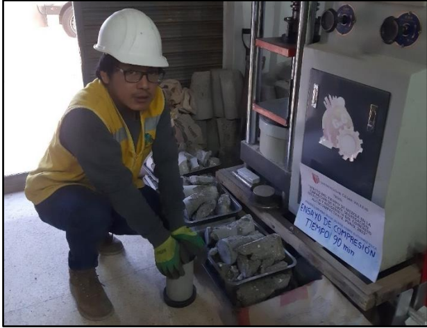
Imagen 66. Preparación de la muestra para ensayo de compresión.
