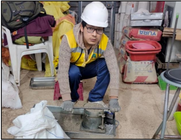
Imagen 30. Proceso de enrasado de agregado fino.
