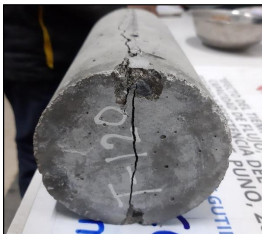
Imagen 64. Tipo de fractura diametral por esfuerzos de tracción.
