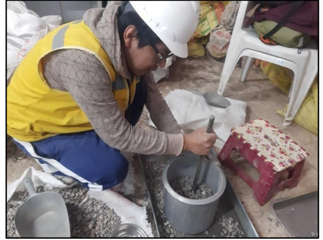
Imagen 25. Peso unitario compactado del agregado grueso.
