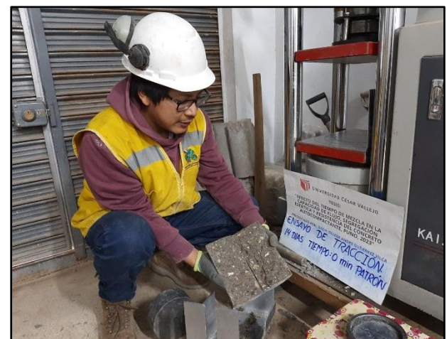
Imagen 65. Caras de fractura de la probeta de concreto.
