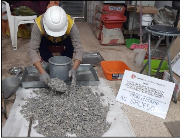
Imagen 24. Peso unitario suelto del agregado grueso.
