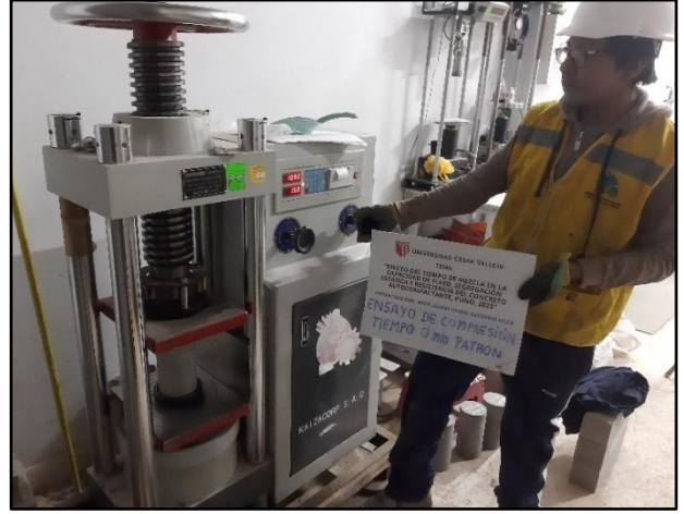
Imagen 67. Aplicación de carga para ensayo de compresión.
