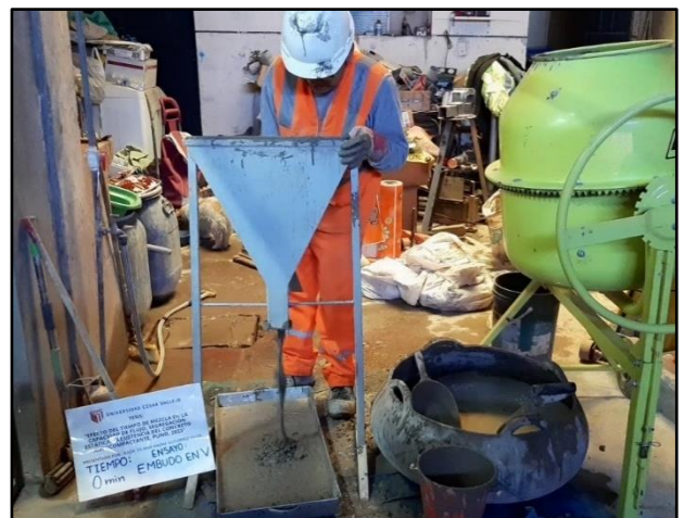
Imagen 47. Ensayo de capacidad de relleno con embudo en V.
