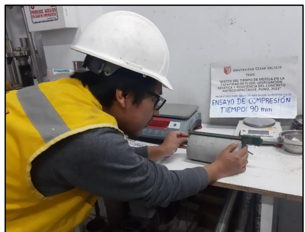
Imagen 59. Medición de altura de probetas de concreto.
