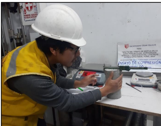
Imagen 58. Medición de diámetro de probetas de concreto.
