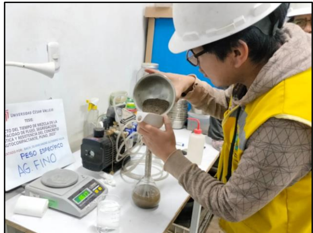
Imagen 10. Peso específico y absorción del agregado fino.
