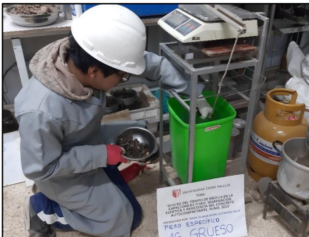
Imagen 15. Peso específico y absorción del agregado grueso.
