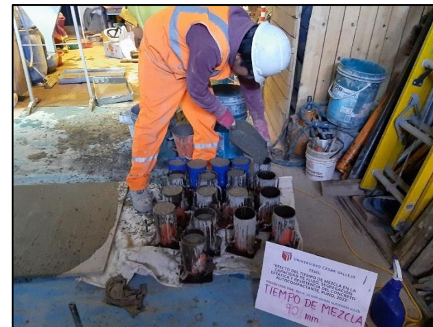
Imagen 53. Elaboración de probetas de concreto autocompactante.
