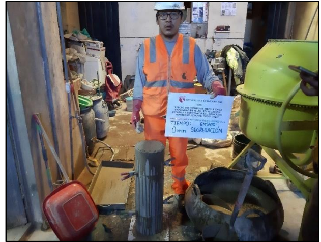
Imagen 49. Columna de segregación llena y enrasada.
