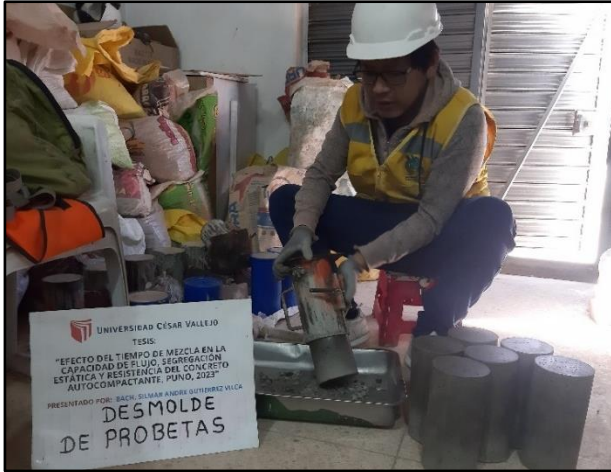
Imagen 54. Desmoldeo de probetas de concreto autocompactante.
