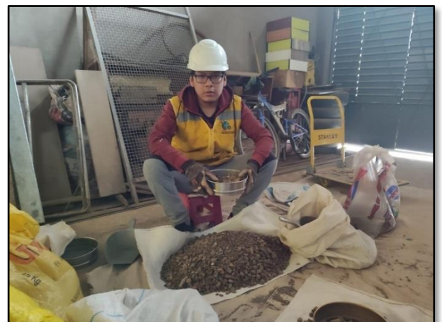
Imagen 04. Tamizado de agregado grueso por la malla 3/4.
