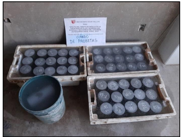
Imagen 57. Curado de probetas de concreto.
