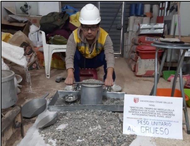
Imagen 26. Proceso de enrasado de agregado grueso.
