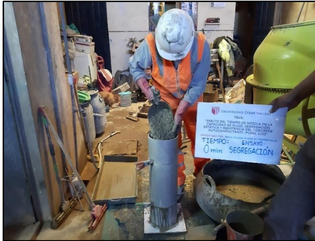
Imagen 48. Preparación para el ensayo de segregación estática.
