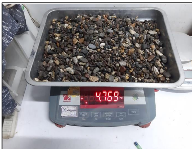
Imagen 52. Peso de muestra contenida en cada sección de la columna.
