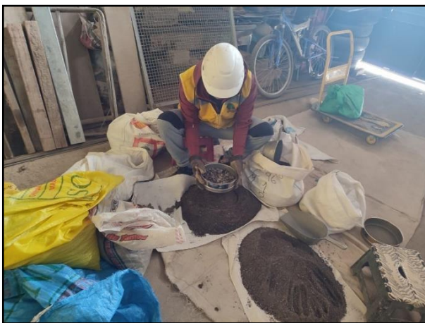
Imagen 05. Tamizado de agregado fino por la malla N°4.
