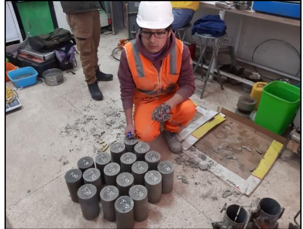
Imagen 55. Probetas de concreto listas para el proceso de curado.
