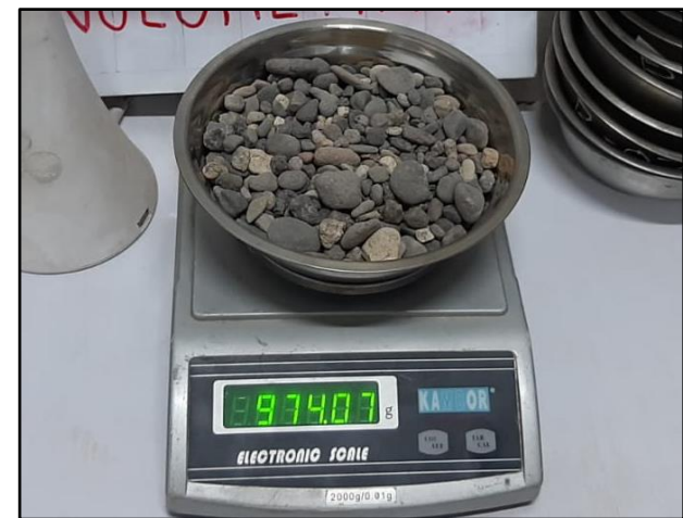
Imagen 35. Muestra gruesa seca al horno para contenido de humedad.
