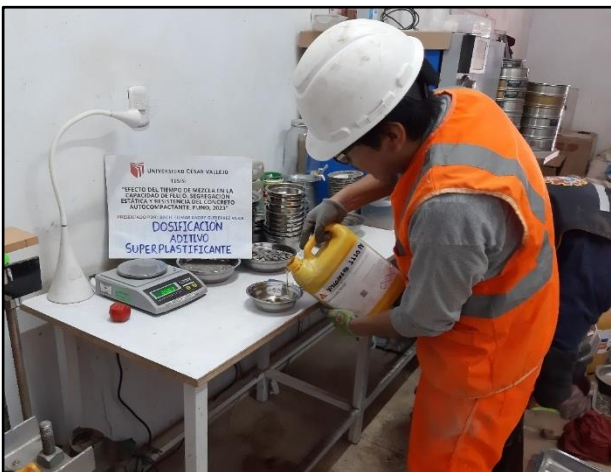
Imagen 40. Dosificación de aditivo Sika 1110 superplastificantes.
