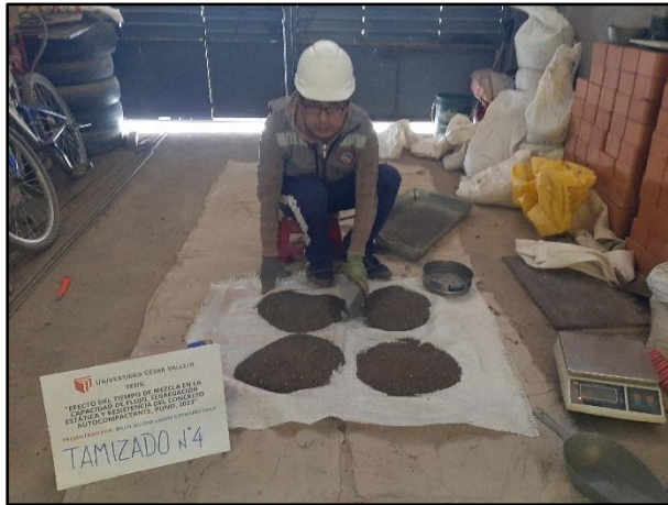
Imagen 07. Cuarteo del agregado fino.
