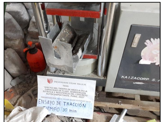
Imagen 63. Fractura de probeta por esfuerzos de tracción.
