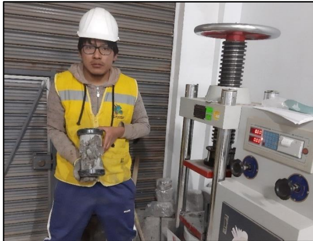
Imagen 68. Fractura de probeta por esfuerzos de compresión.
