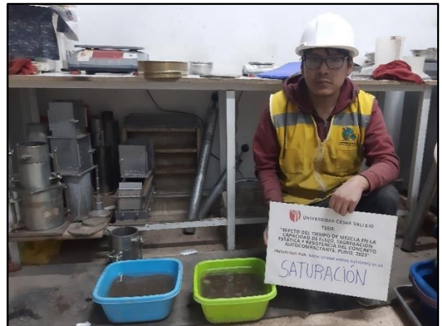
Imagen 08. Proceso de saturación de la muestra para ensayos.
