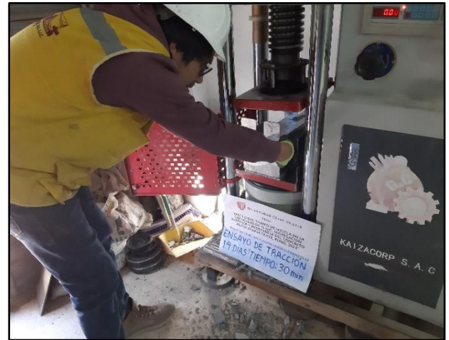
Imagen 61. Colocación de probeta para ensayo de tracción.
