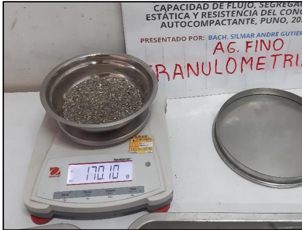
Imagen 19. Peso de la muestra retenida en cada tamiz.
