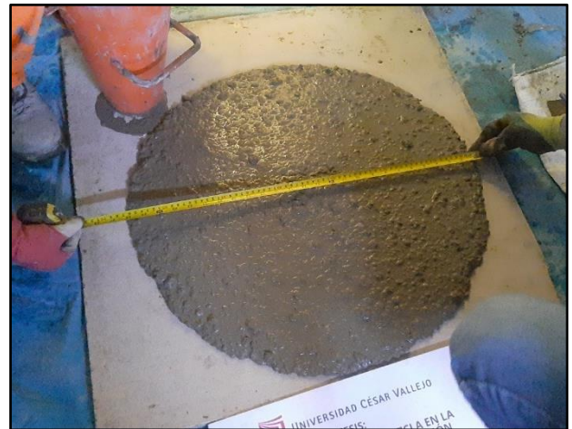
Imagen 45. Medición de diámetro de extensión de flujo.
