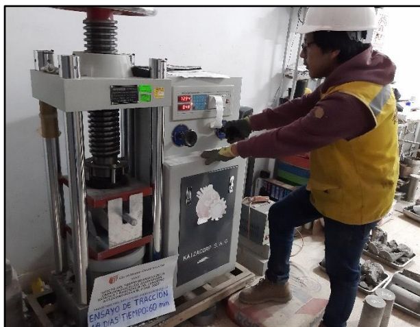
Imagen 62. Aplicación de carga para ensayo de tracción.
