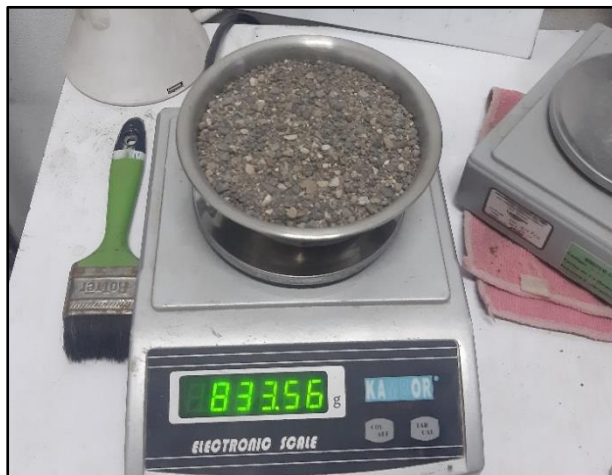
Imagen 32. Peso de la muestra de árido fino en estado natural.
