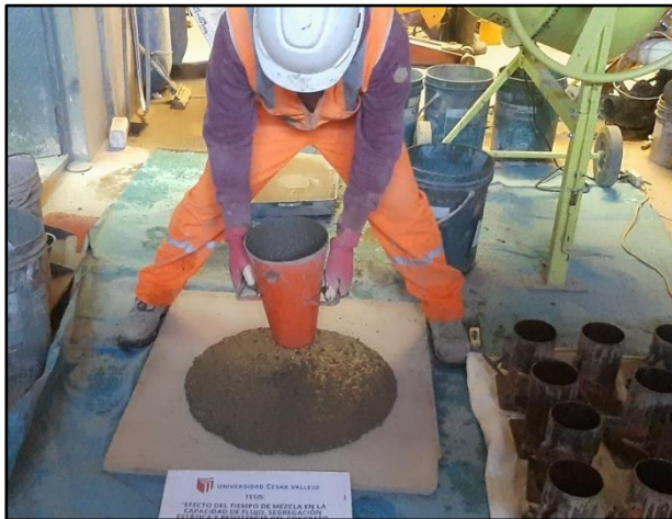
Imagen 44. Ensayo de extensión de flujo con cono de Abrams.
