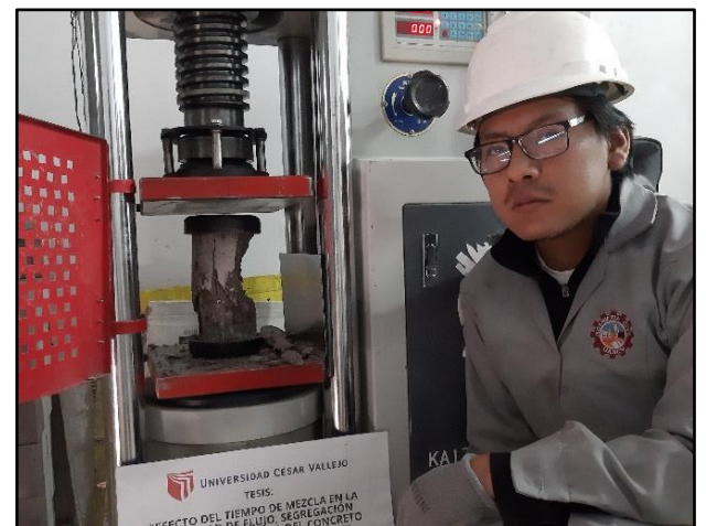
Imagen 71. Probeta fracturada en ensayo de compresión.
