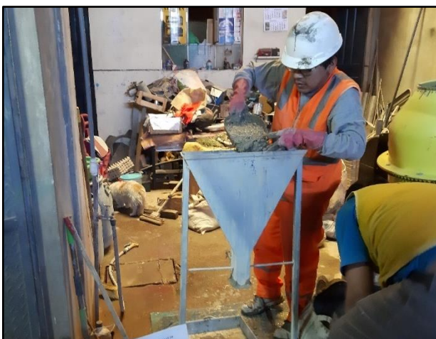
Imagen 46. Preparación para el ensayo de embudo en V.
