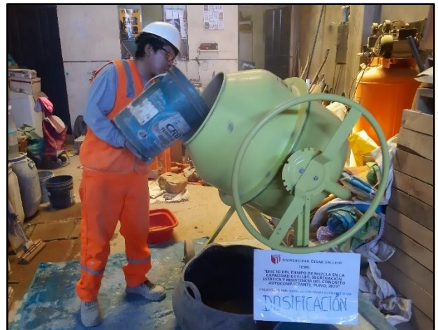
Imagen 41. Combinación de todos los componentes en el trompo.
