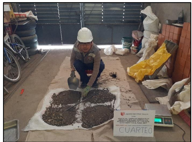
Imagen 06. Cuarteo de agregado grueso.
