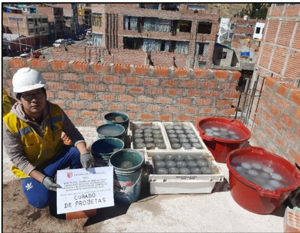
Imagen 56. Proceso de curado de probetas de concreto.
