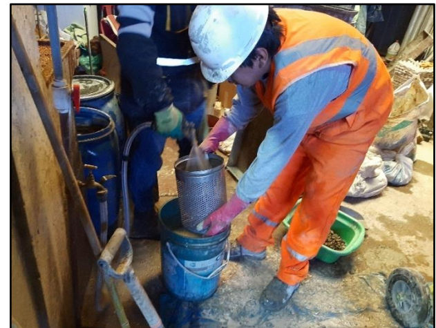
Imagen 51. Lavado de muestra por partes mediante la malla N°4.
