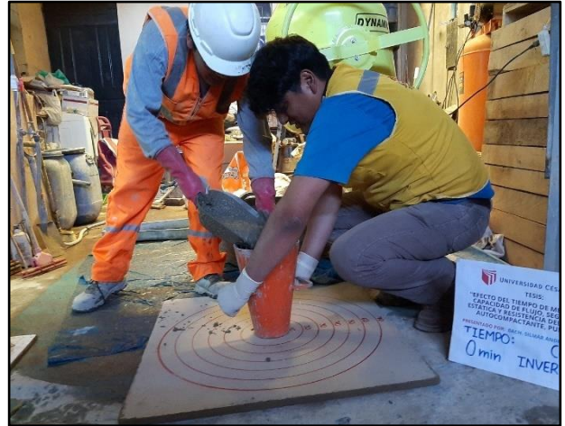
Imagen 43. Preparación para el ensayo de extensión de flujo.
