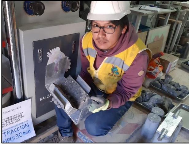
Imagen 72. Ensayo de resistencia a la tracción.
