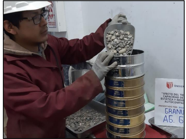
Imagen 20. Ensayo de granulometría por tamizado ag. grueso.
