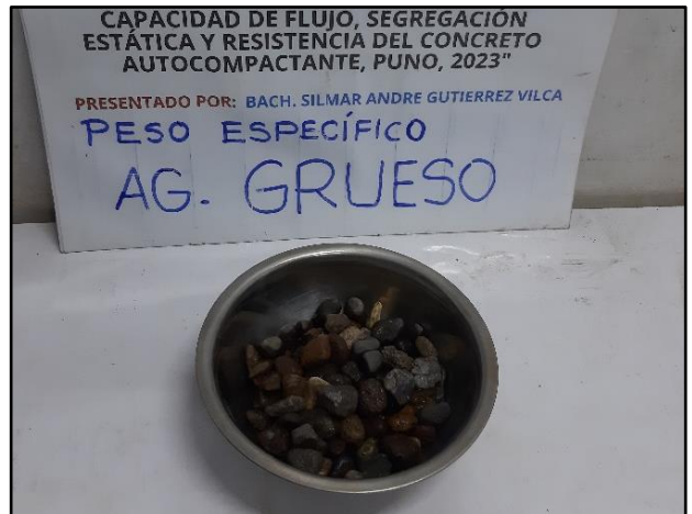
Imagen 16. Muestra preparada para su introducción al horno.
