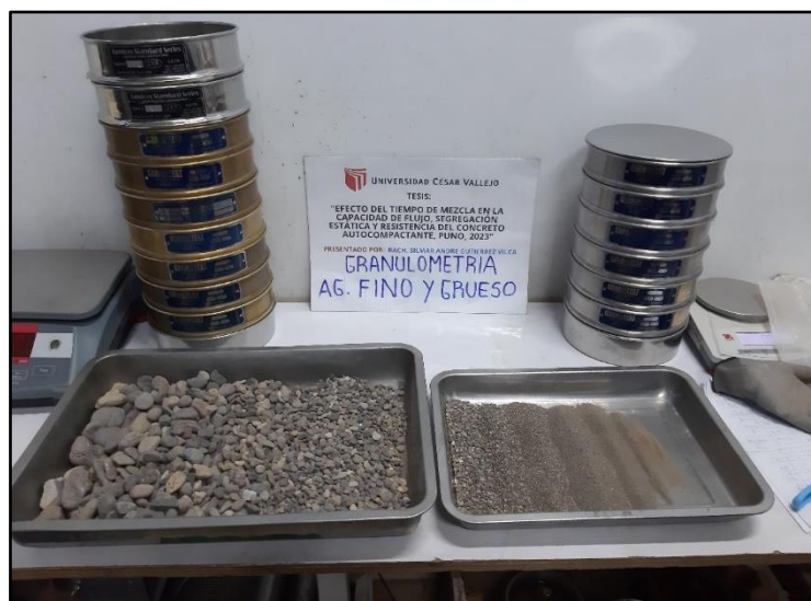
Imagen 23. Muestra ordenada de análisis granulométrico.
