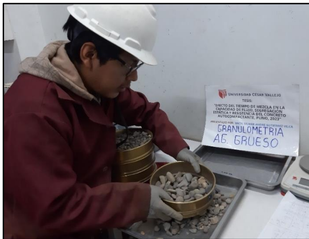
Imagen 21. Tamizado de agregado grueso.
