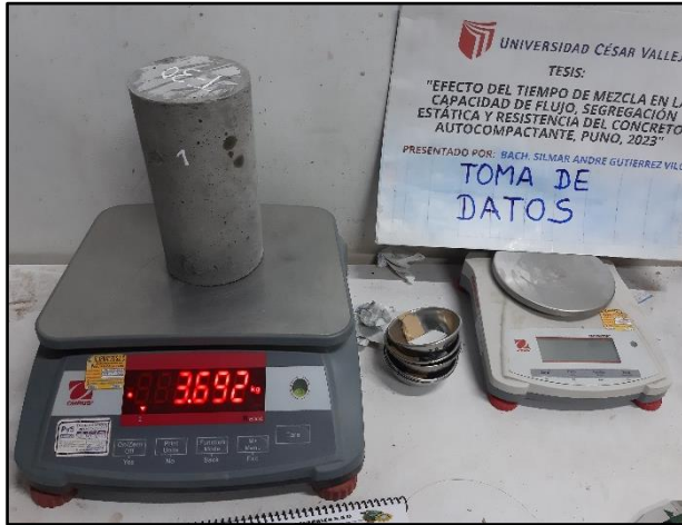
Imagen 60. Registro del peso de probetas de concreto.
