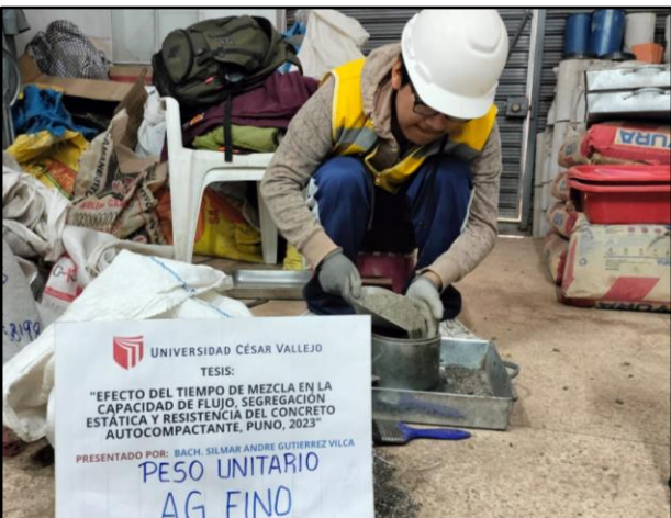
Imagen 28. Peso unitario suelto del agregado fino.
