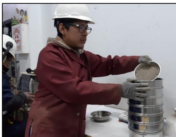
Imagen 17. Ensayo de granulometría por tamizado ag. fino.
