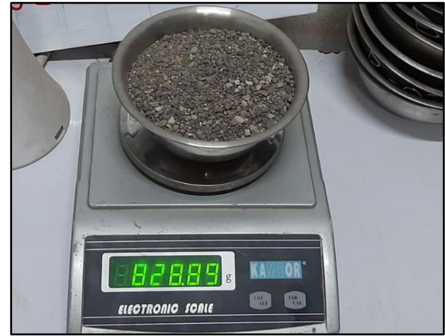
Imagen 33. Muestra fina seca al horno para contenido de humedad.
