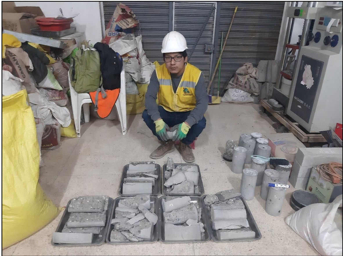
Imagen 74. Probetas fracturadas en ensayos de resistencia a la tracción y compresión.
