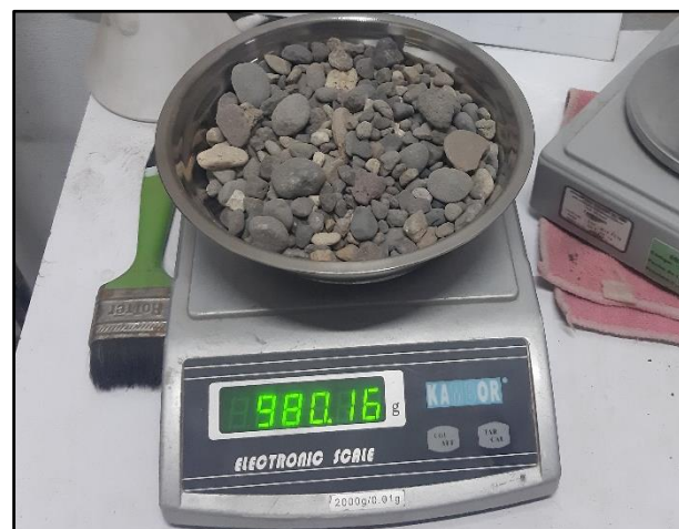
Imagen 34. Peso de la muestra de árido grueso en estado natural.
