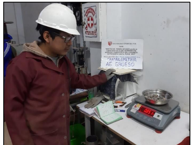
Imagen 22. Toma de datos de muestra retenida.
