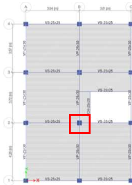
Figura 42. Diseño de columnas para el eje más crítico C- (35x35) EJE B/eje 2
