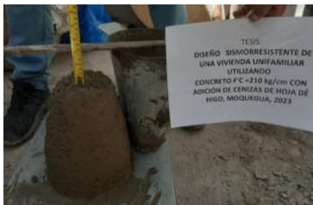
Figura 52. Ensayo del Slump
