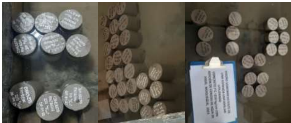
Figura 6. Muestras del concreto patrón y del 1%, 4% y 8% de adición con CHH para la resistencia a la compresión y peso unitario.
