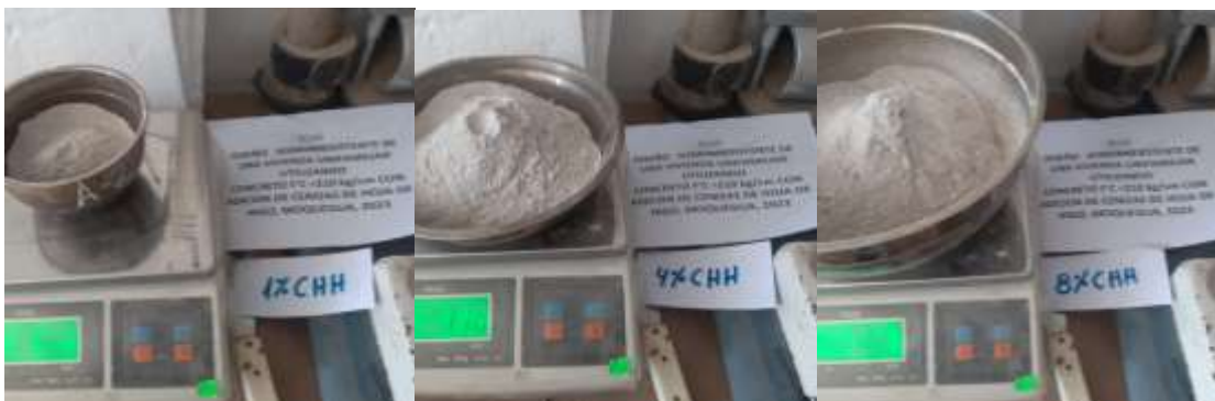
Figura 3. Muestras dosificadas al 1%, 4% y 8% de adición con CHH para el vaciado
