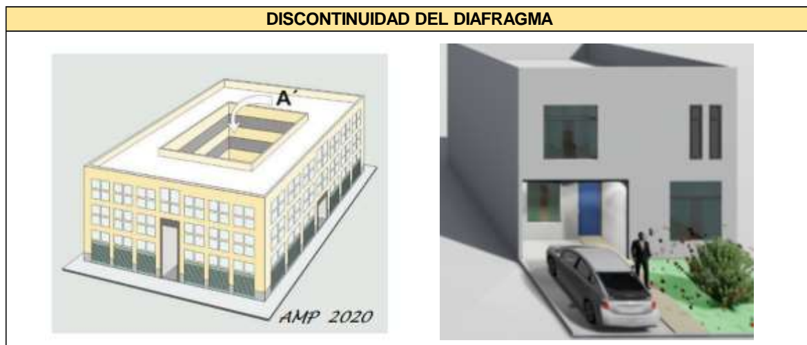
Figura 38. Vista para verificar por Discontinuidad del Diafragma su irregularidad
