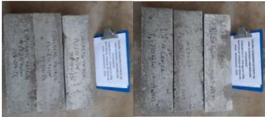
Figura 7. Muestras del concreto patrón y el 1% de adición con CHH para la resistencia a la flexión.
