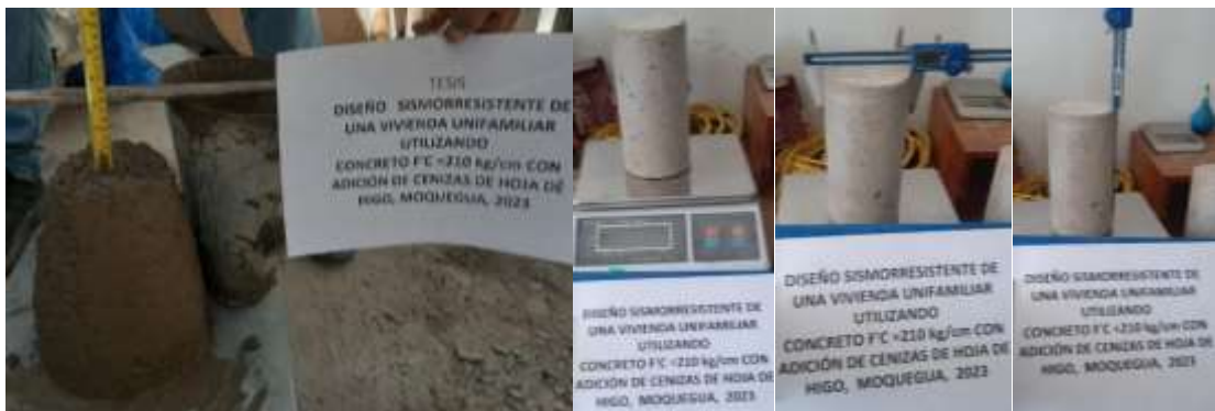
Figura 9. Ensayo de las propiedades físicas del concreto (Slump y peso unitario).
