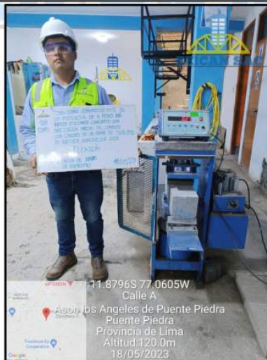
Fotografía N. 85: Rotura de vigas a 28 días
