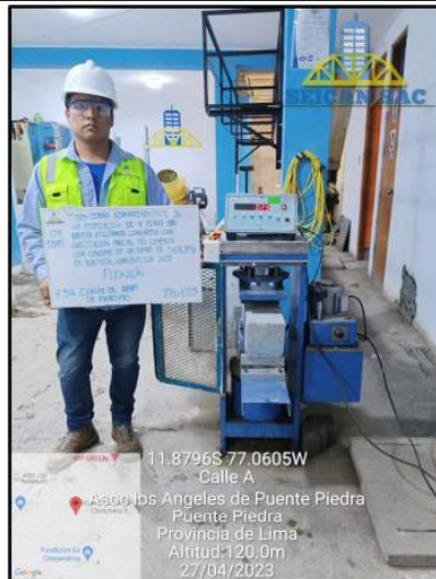
Fotografía N. 83: Rotura de vigas a 7 días
