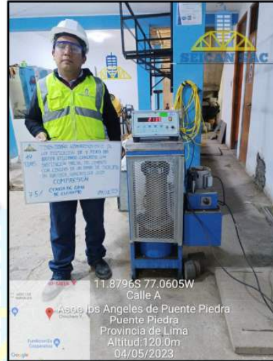
Fotografía N. 81: Rotura de probetas 6"x12" a 14 días
