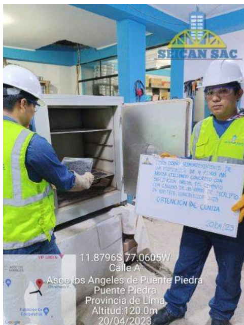
Extracción de las Cenizas de Ramas de Eucalipto de la Mufla
