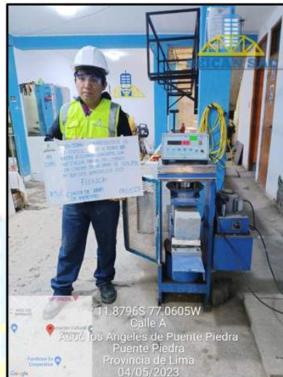
Fotografía N. 84: Rotura de vigas a 14 días
