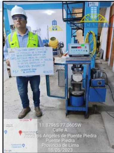
Fotografía N. 82: Rotura de probetas 6"x12" a 28 días
