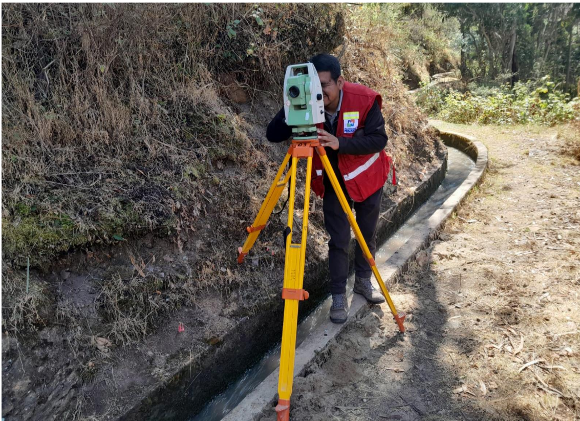
Fotografía 2. Lectura de coordenadas con estación Total del Canal Montañas, Caserío de Nunocoto, Acopampa, Carhuaz, 2023.
