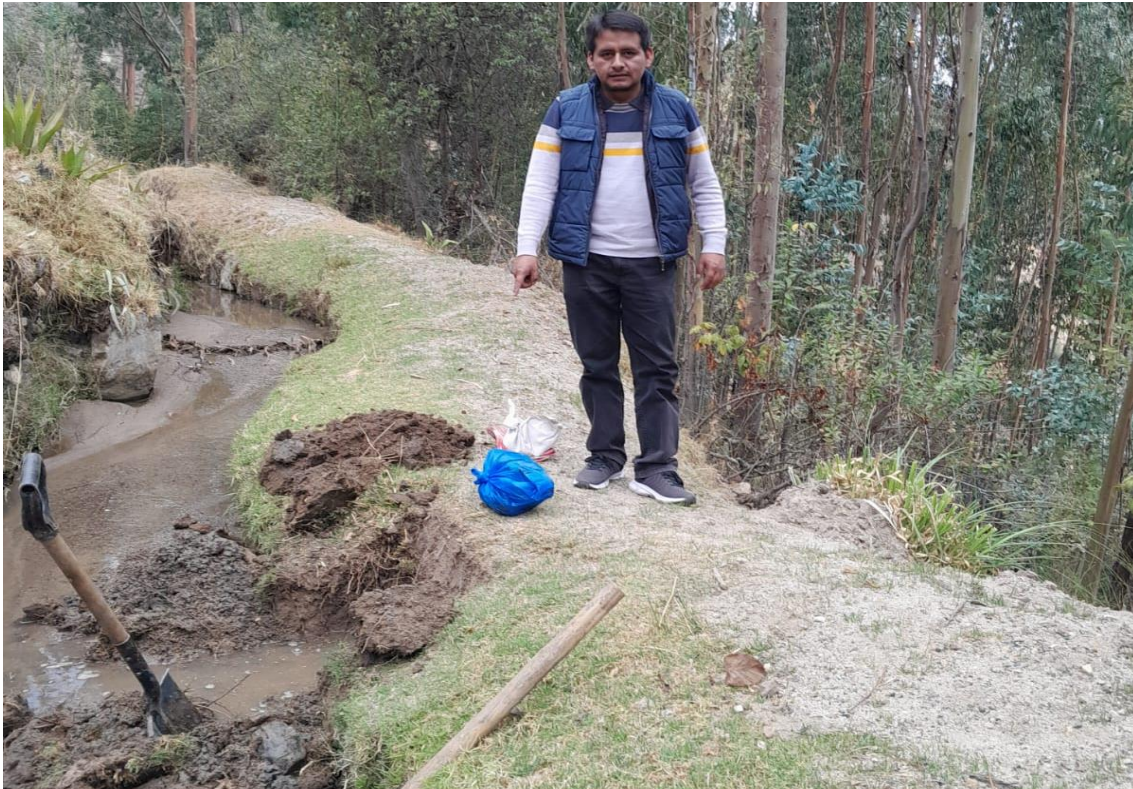
Fotografía 6. Excavación y toma de muestra de Calicata N° 02, para el estudio del coeficiente de permeabilidad en el laboratorio.
