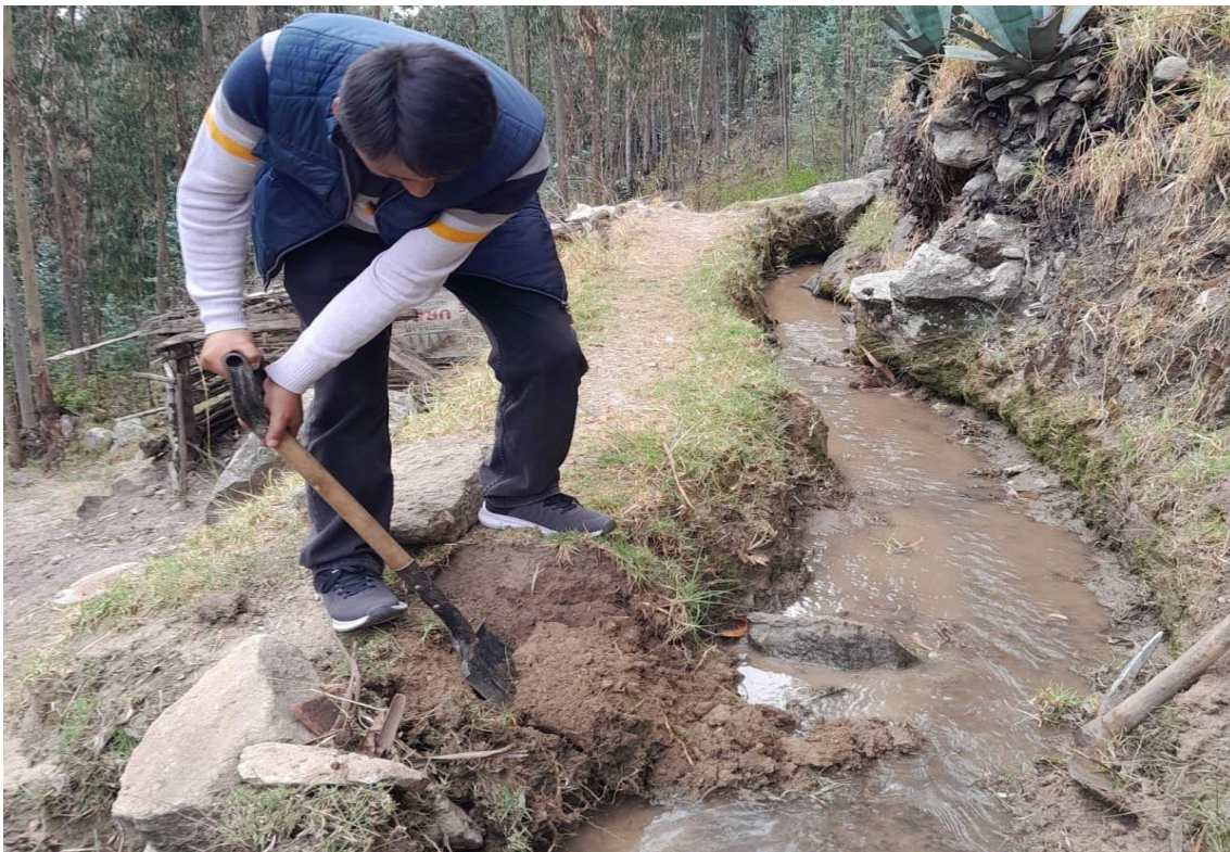
Fotografía 6. Excavación y toma de muestra de Calicata N° 02, para el estudio del coeficiente de permeabilidad en el laboratorio.
