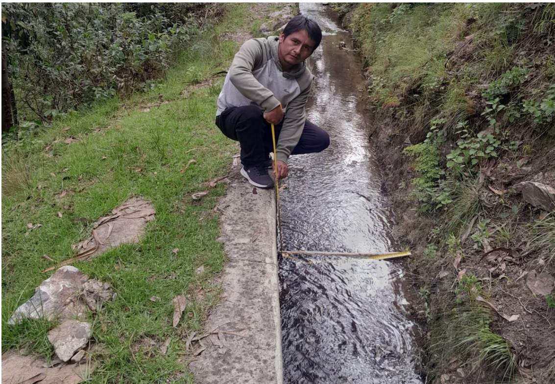
Fotografía 10. Medición de altura para la obtención del caudal y velocidad del flujo en el Canal Montañas, Caserío de Nunocoto, Acopampa, Carhuaz, 2023.
