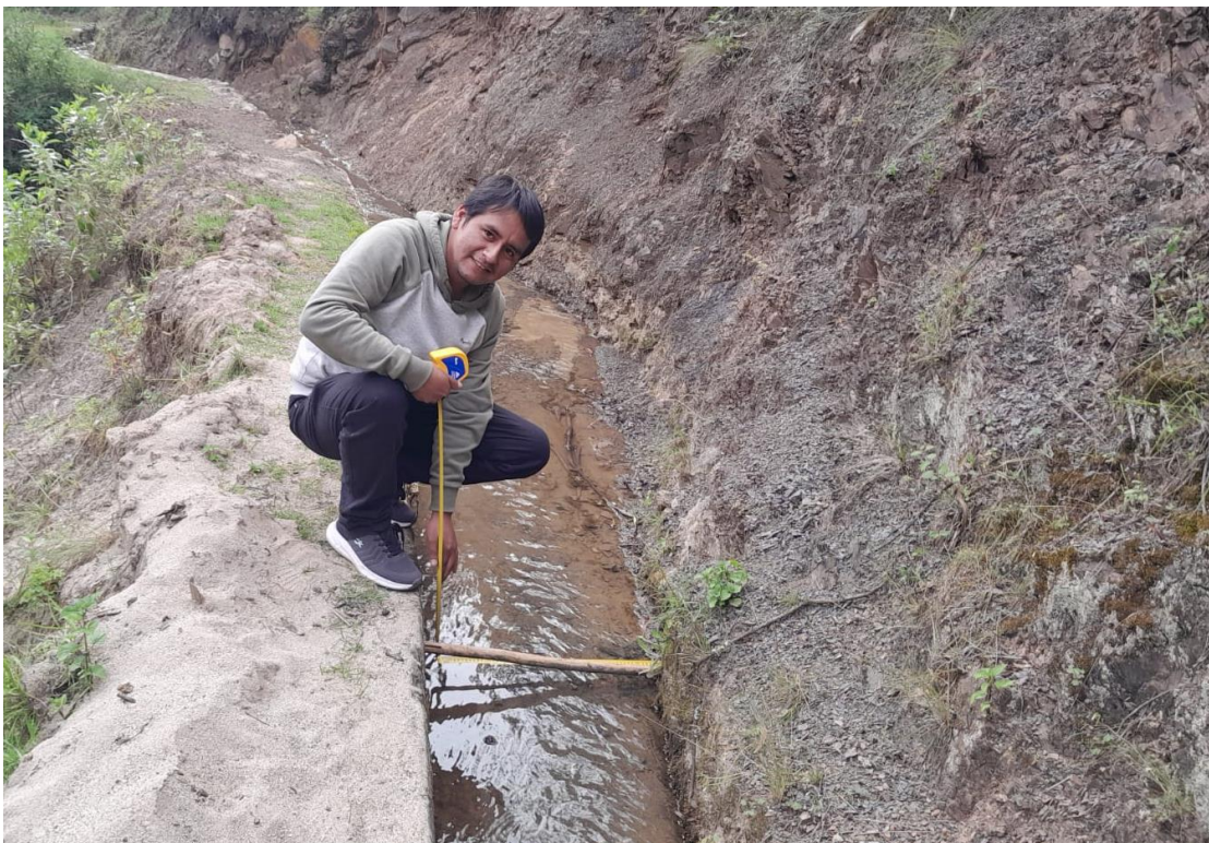
Fotografía 10. Medición de altura para la obtención del caudal y velocidad del flujo en el Canal Montañas, Caserío de Nunocoto, Acopampa, Carhuaz, 2023.
