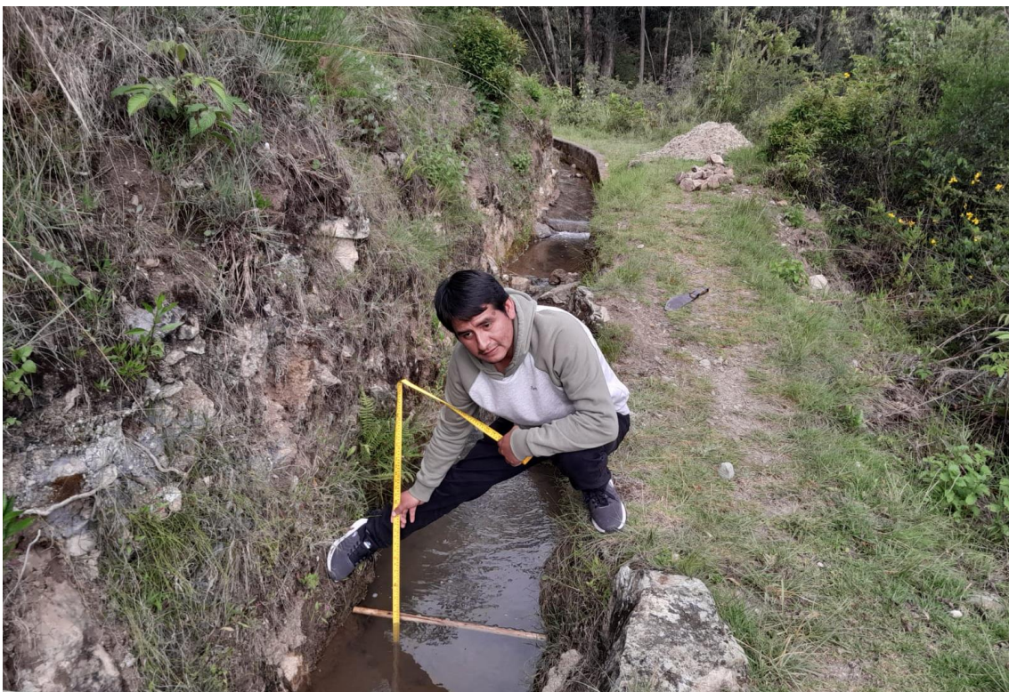
Fotografía 8. Evaluación geométrica y medición del caudal a cada 50 metros, del Canal Montañas, Caserío de Nunocoto, Acopampa, Carhuaz, 2023.
