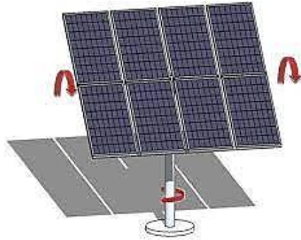
Figura 16. Sistema de movimiento del seguidor solar de dos ejes
