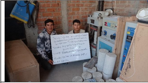
Foto N°59 Resistencia a la compresión 28 días
