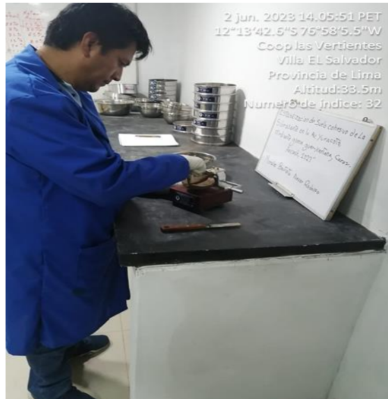
Figura 10: Limite Liquido con la Copa de Casagrande
