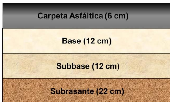
Figura 31. Estructura de pavimento
