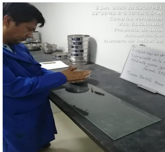
Figura 11: Limite Plástico con la Copa de Casagrande
