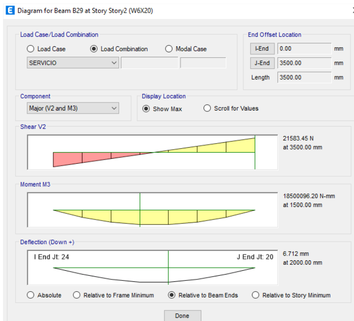
Figura 20 deflexión por servicio en losa colaborante
