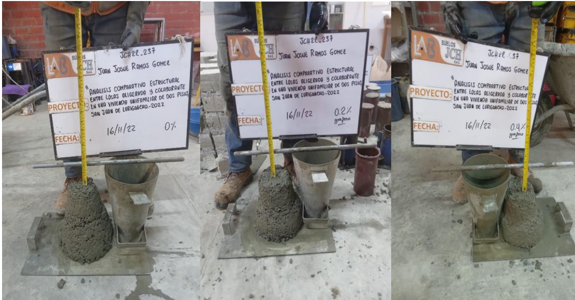
Figura 8 ensayo de slump
