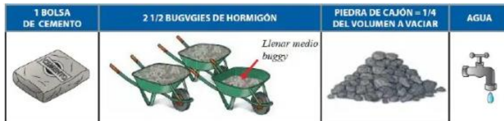
Figura 15: proporción para sobrecimiento.
