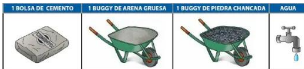
Figura 13: Proporción para concreto de 175kg/cm 2
