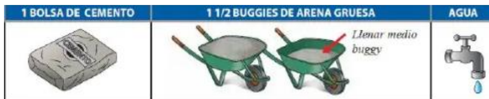
Figura 12: Proporción para contrapiso.
