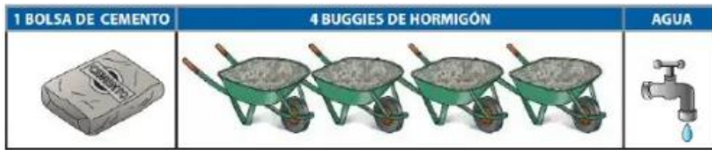
Figura 11: Proporción para falso piso.
