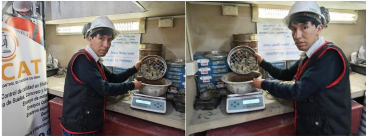
Figura 13. Ensayo de análisis granulométrico del AG.
