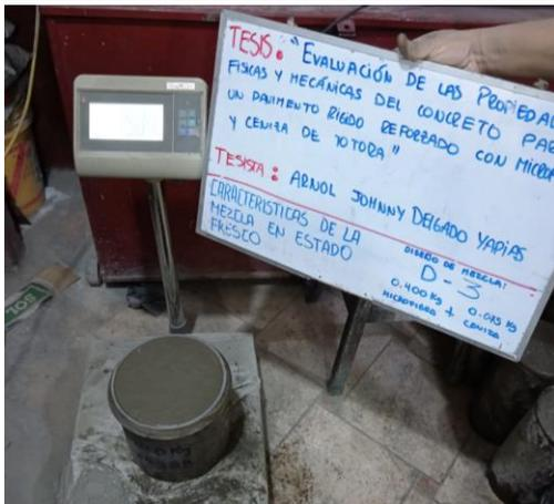
Fotografía 19. Peso unitario de concreto con microfibra 400 gr. y ceniza de totora 75 gr.
