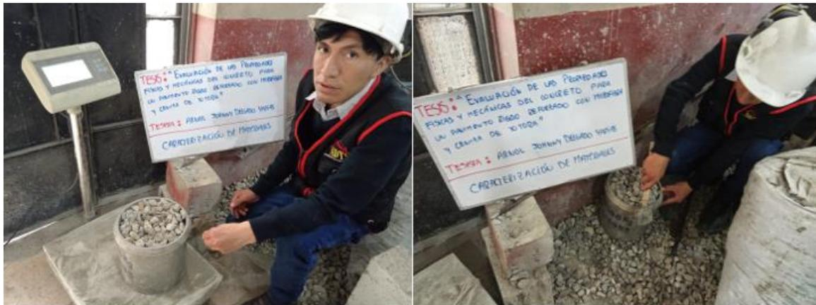
Figura 21. Ensayo de PU del AG.
