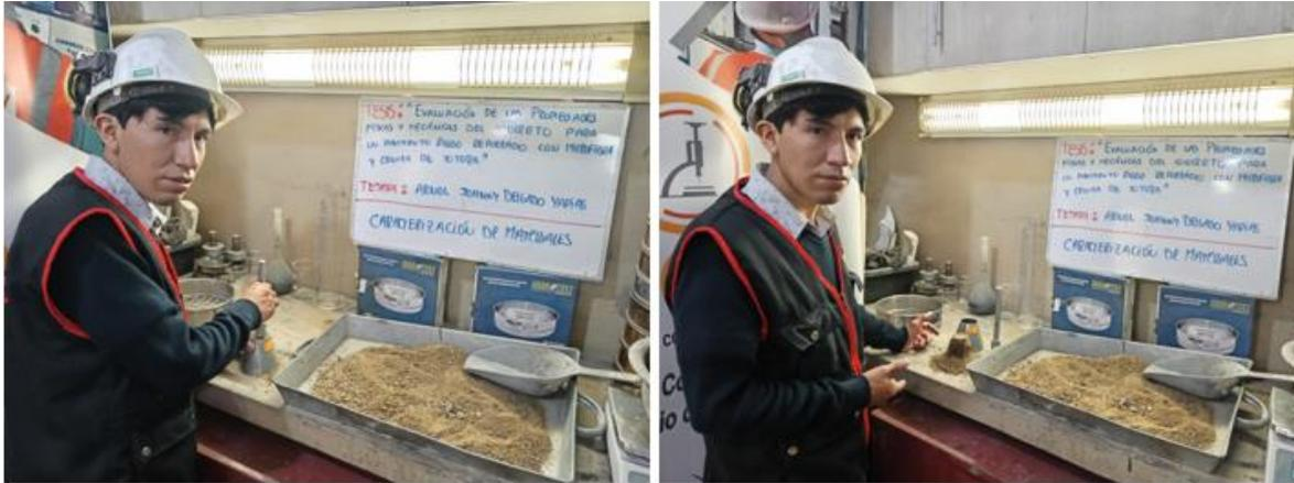
Figura 24. Ensayo de Ps y Abs del agregado fino.
