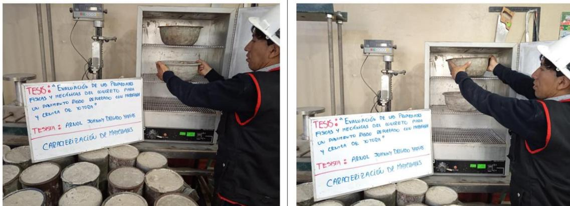
Figura 2. Realización del ensayo de CH de los agregados (AF y AG).
