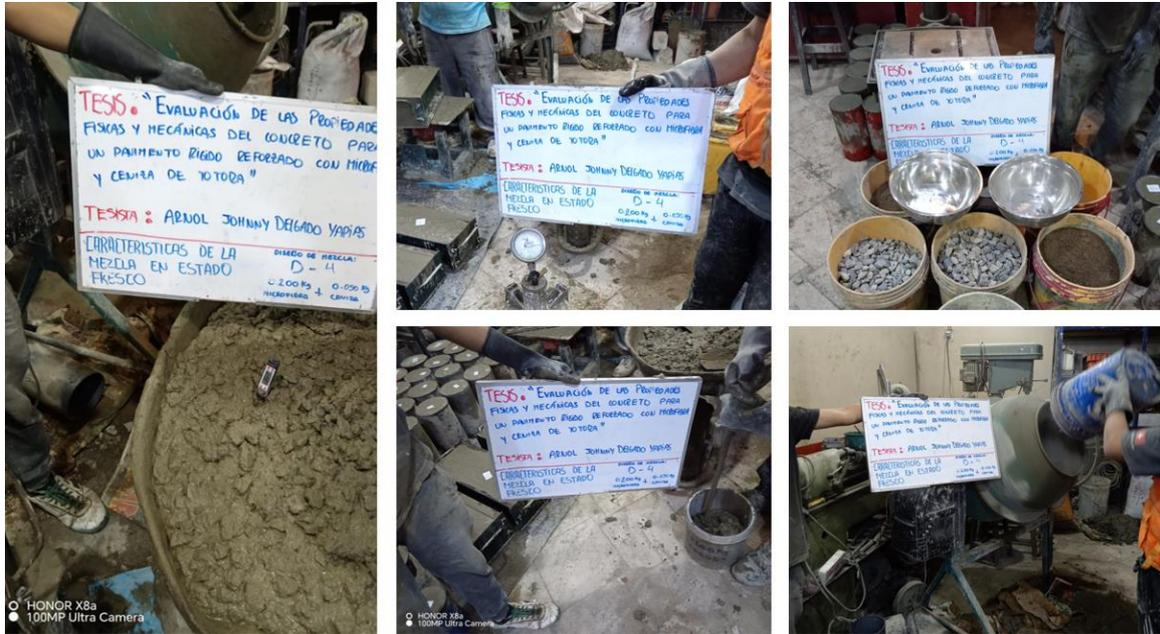
Figura 9. Realización de la mezcla de concreto D-4.
