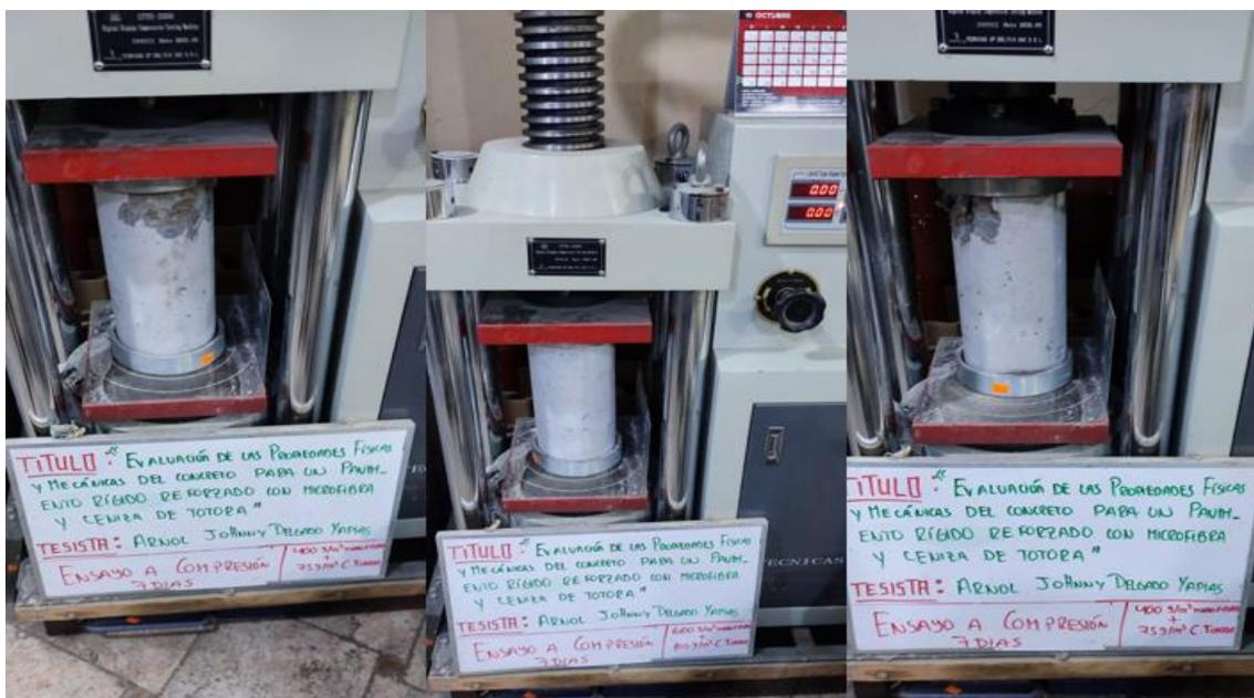
Figura 30. Rotura de probetas a compresión a los 7 días de edad.
