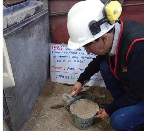
Fotografía 8. Ensayo de peso unitario AF
