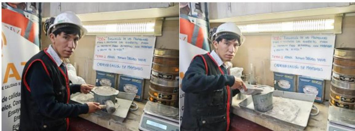
Figura 26. Ensayo de peso específico y absorción de la ceniza.
