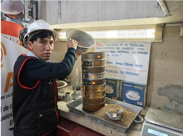
Fotografía 7. Ensayo de granulometría
