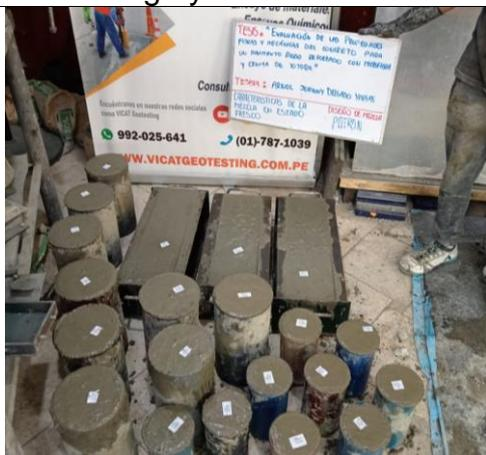
Fotografía 21. Elaboración de probetas y vigas
