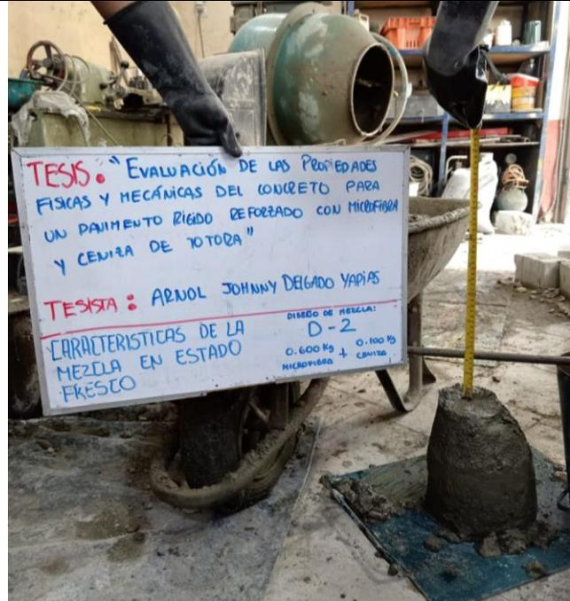
Fotografía 14. Asentamiento de diseño de mezcla con microfibra 600 gr. y ceniza de totora 100 gr.
