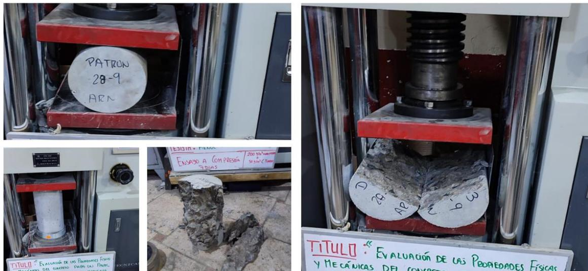
Figura 10. Ensayos de resistencia del concreto endurecido.
