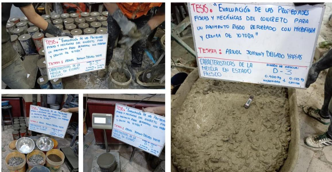
Figura 8. Realización de la mezcla de concreto D-3.
