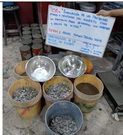
Fotografía 12. Diseño de mezcla con adición de microfibra y ceniza de totora.
