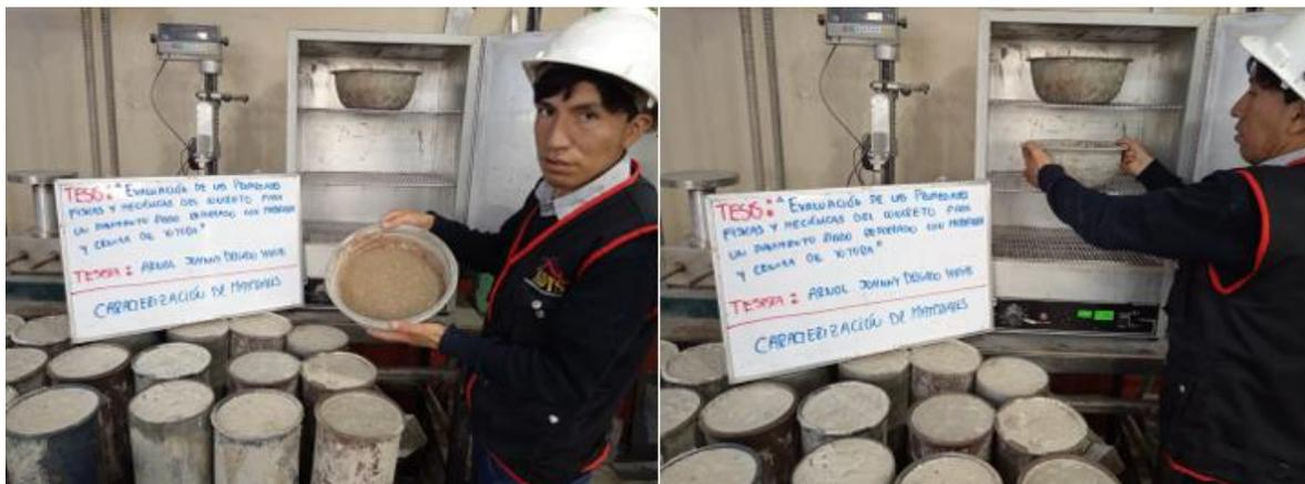
Figura 17. Ensayo de contenido de humedad del AF.
