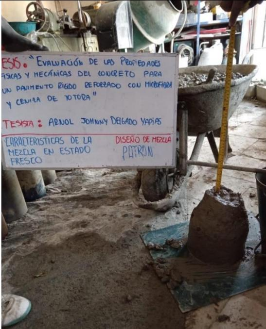
Fotografía 13. Asentamiento de diseño de mezcla patrón
