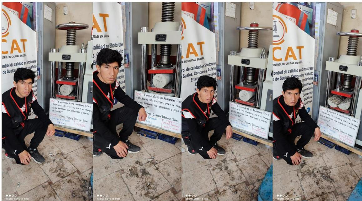
Figura 38. Rotura de probetas a tracción a los 14 días de edad.
