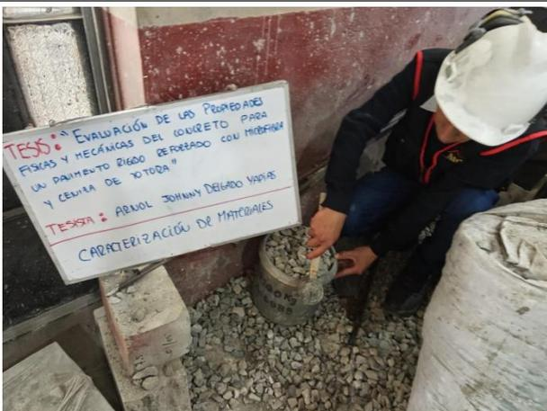
Fotografía 9. Ensayo de peso unitario AG
