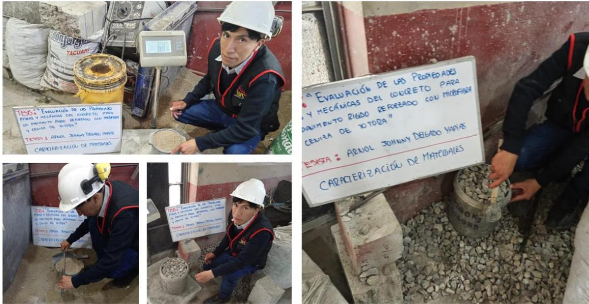
Figura 5. Realización del ensayo de peso unitario suelto y compactado de los agregados (AF y AG).
