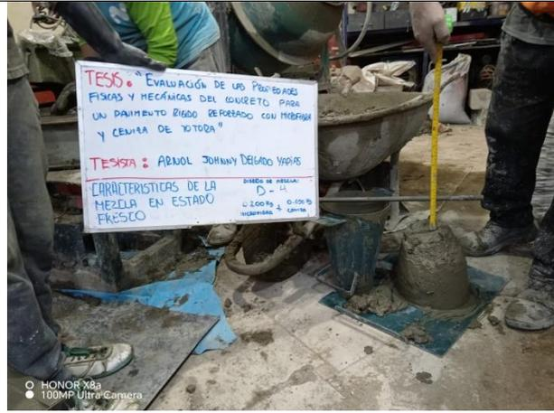
Fotografía 16. Asentamiento de diseño de mezcla con microfibra 200 gr. y ceniza de totora 50 gr.
