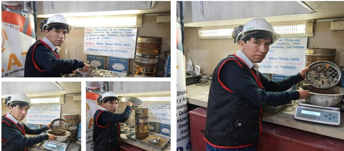
Figura 3. Realización del ensayo de análisis granulométrico de los agregados (AF y AG).
