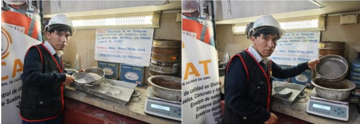
Figura 15. Ensayo de AGr de la ceniza.
