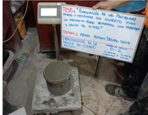
Fotografía 18. Peso unitario de concreto con microfibra 600 gr. y ceniza de totora 100 gr.
