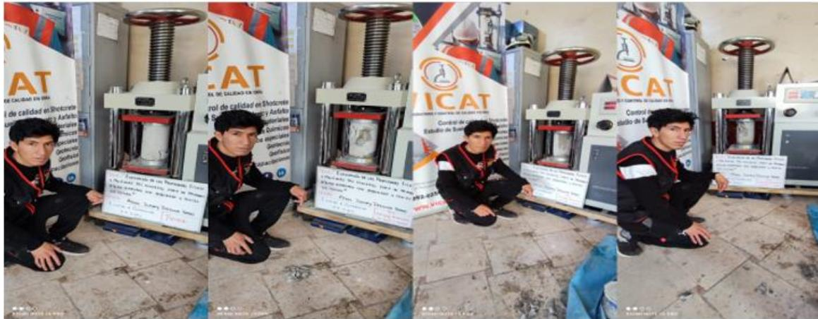
Figura 32. Rotura de probetas a compresión a los 14 días de edad.
