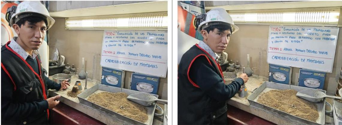
Figura 4. Realización del ensayo de peso específico y absorción de los agregados (AF y AG).
