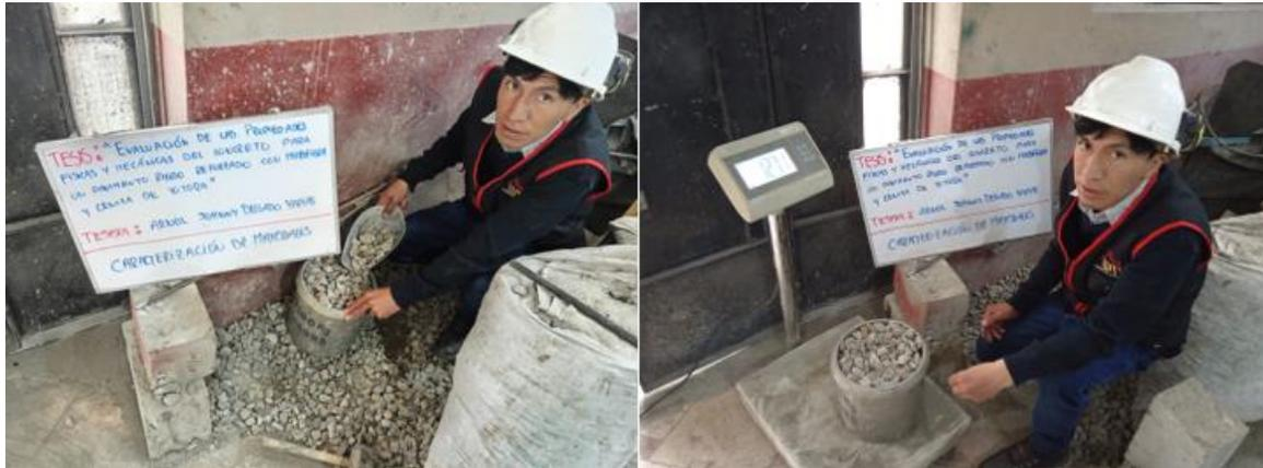
Figura 25. Ensayo de peso específico y absorción del agregado grueso.
