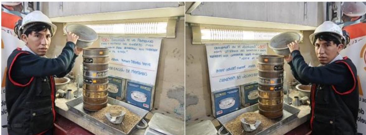
Figura 11. Ensayo de análisis granulométrico del AF.
