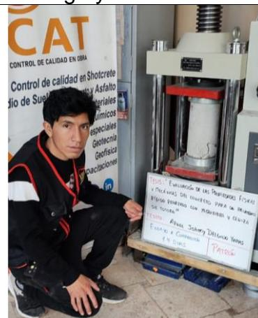
Fotografía 22. Rotura de probetas.
