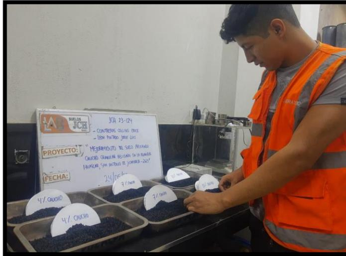
Figura 20: Caucho granular reciclado
