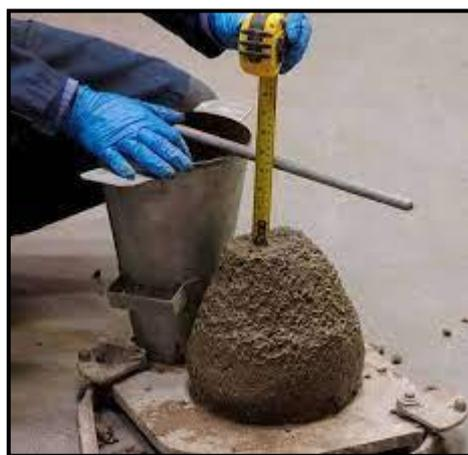
Figura 5. Ensayo de asentamiento.
