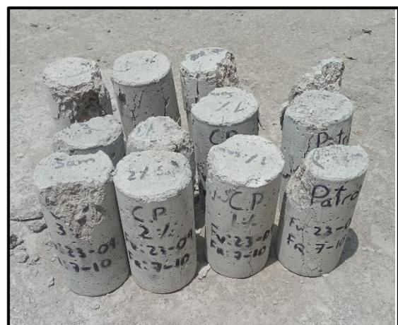
Figura 19. Probetas después de la rotura.
