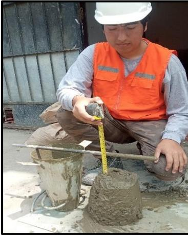
Figura 13. Asentamiento del concreto.
