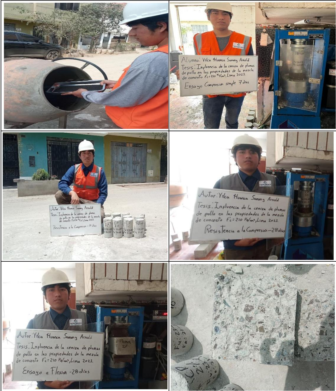
Rotura de probetas y viguetas.
