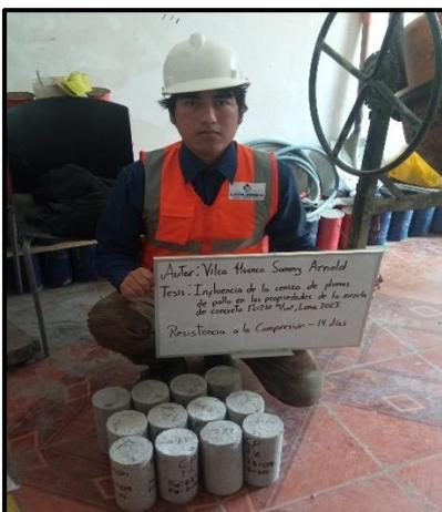
Figura 18. Probetas antes de la rotura.
