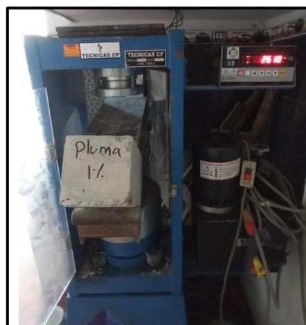
Figura 22.. Rotura por flexión.
