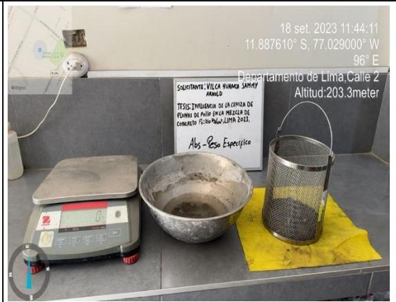
Ensayos físicos de los agregados.
